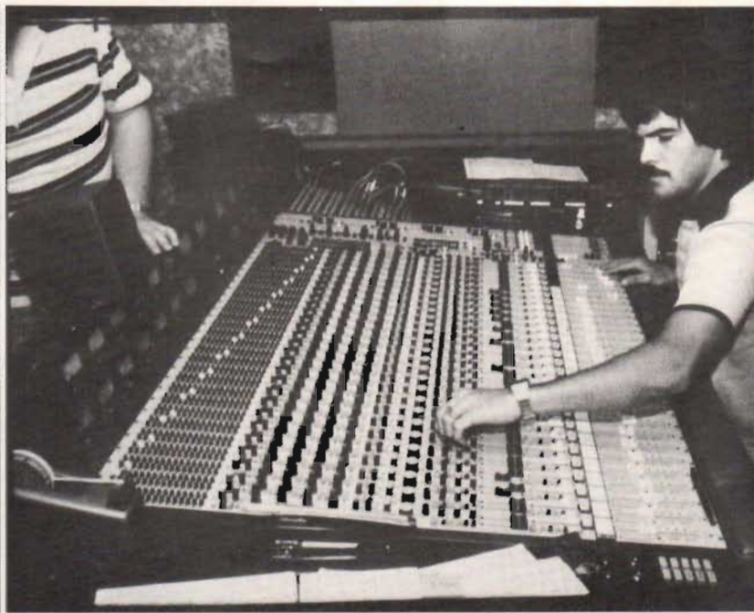
Fig 6. Hos Nashvillestudion Sound Stage Studio har Warren Peterson varit inspelningstekniker vid de olika direktgraveringarprojekten. Mellan inspelningsstudions kontrollbord och den i närheten belägna graveringsstudio Masterfonics har man dragit en egen bredbandig kabelförbindelse.
