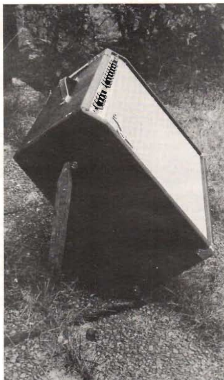
Fig 4. De utfällbara stöden på Fender möjliggör bättre "projicering" mot gitarristen. Fender håller hårt på sin lyckade grundkonstruktion från 1950-talet, med enbart rör naturligtvis, och har sina bestämda förespråkare, medan andra anser att de blivit överdrivet konservativa. Men nu lanseras en ny rörförstärkarserie om 180 W med de vanliga klangfärgkontrollerna och FK-variator.
