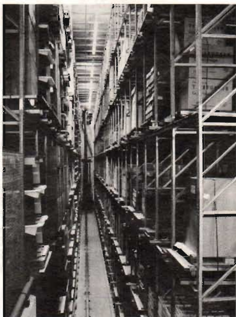
Fig 1. I detta storlager lagras färdiga, paketerade TV-mottagare och paket med andra större detaljer. På ett spår i mitten bilden går en datorstyrd lastare som kan programmeras i X- och Y-led till de 436 facken.
