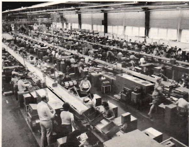
Fig 3. Här monteras modulerna på chassiet som sedan går vidare på monteringsbandet till nästa monteringsställe.
