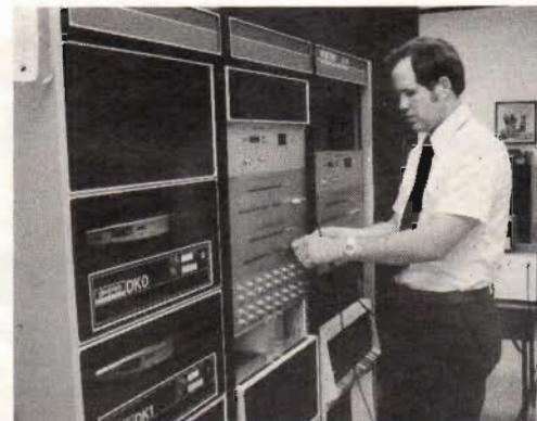
Fig 1. Robert G Ingebreten framför Soundstream Incs minidator DEC PDP 11. Bland övriga finesser märks bl a två sk floppy disk-enheter samt företagets egenhändigt utvecklade D/A- resp A/D-omvandlare och programmerbara klockenhet.
