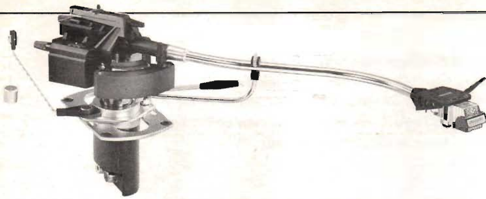
Fig 6. Den nya tonarmen från SME, England, fört en betydligt massivare och mera inkapslad look än tidigare med bl a "oljeträget" framtill för resonansdämpning. Superb "camera finish" åberopar man sig, lite förvånande, på. Vertikal- och horisontalaxlarnas lagringar hos armen skär varandra vid nålspetsnivå för minimum sk warp-wow, alltså distorsion till följd av oplana skivor. Armen är nio tum lång.
