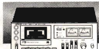
D-550 frontmatat kassettdäck med Dolby. Frekv-omf med CrO2-band u brusr 30–14 000 Hz. C:a pris 1 230 kr.
