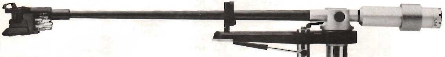
Fig 1. Här två studier av den tidigare nämnda nya ADC-tonarmen LMF, som är utförd i kolfiber-kompositmaterial. Armen smalnar mot spetsen och har inte vanlig rörform, vilket ADC menar bidragit till låg massa, och det i en version fasta skalet ger en vridstyv, resonansdämpad och lätt konstruktion. Viskosdämpning i båda riktningarna. Lagringspunkter i instrumentståleggar, mindre utsatta än gängse knivlager, menar ADC. Alla LMF har 100 pF-kablage. Anläggningstrycket kalibrerbart i steg om 1/10 pond.
