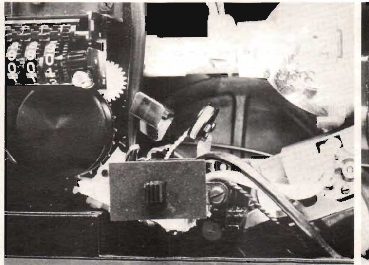
Fig 7. Brumproblemen kan tacklas på flera sätt — Bolex använder en induktionsspole i tonhuvudets närhet som får ge motfasig spänning för utbalsning av störningarna.
