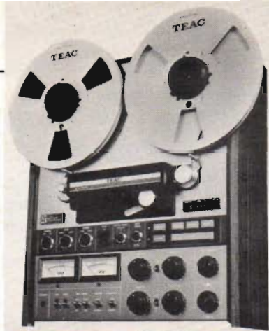
Fig 15. Teac är ett aktat namn i bandanvändarkretsar. Vi börjar med att visa A-7300, som dock inte är någon direkt nyhet. 38 cm/s, tvåspårsteknik, logikstyrd bandtransport och mixbara ingångar. Balanserade träförsedda ingångar och direktutgång efter avspelnings elektronik. Modellen RX har inbyggt dBX-system för brusnedtagning. Bandtransportdelen och elektroniken är här separerade i lådor. Så har vi Teac Tascam Series 80-8, en 8-kanalig bandspelare för halvtumstape. 38 cm/s, mixbara linjeingångar, Simul Sync-hållning och logikstyrd bandtransport. VU-metrar och lysdioder samt toppspänningsindikatorer.
