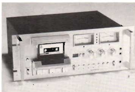
Fig 5. CT-F 1000 heter Pioneers med tre tonhuvuden försedda kassettdäck med tonhöjds kontroll, Dolby, mpx-filter och minnesautomatik. Huvudena är ferriter. Antalet motorer är två på gängse maner och, förstås, man har luckan på framsidan. Däcket tänks ingå i SPEC 1-sammanhang ihop med Pioneers dyrare tuners.
