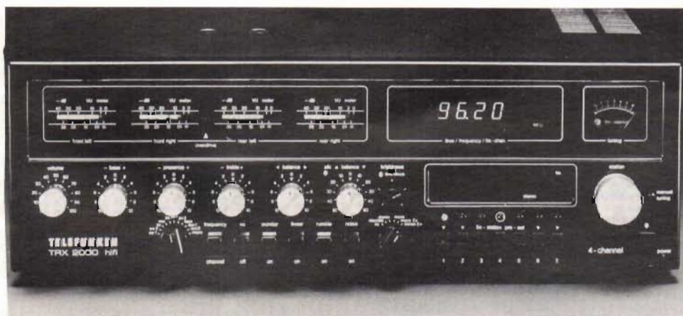
Fig 2. TRX 2000 hi-fi utgör fn "slagskeppet" i sortimentet. Den innehåller bl a digital frekvensräknare som kan kompletteras för tidangivelse. De fyra Vu-metrarna är lysdiodbestyckade.
