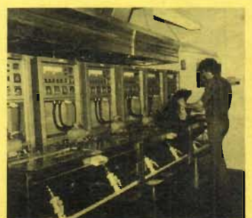
Etta led i matriseringen — här ses en del av anläggningen hos Europa Film för snabbfällning på pressmatriser. Foto: Anders Ingemarsson.
