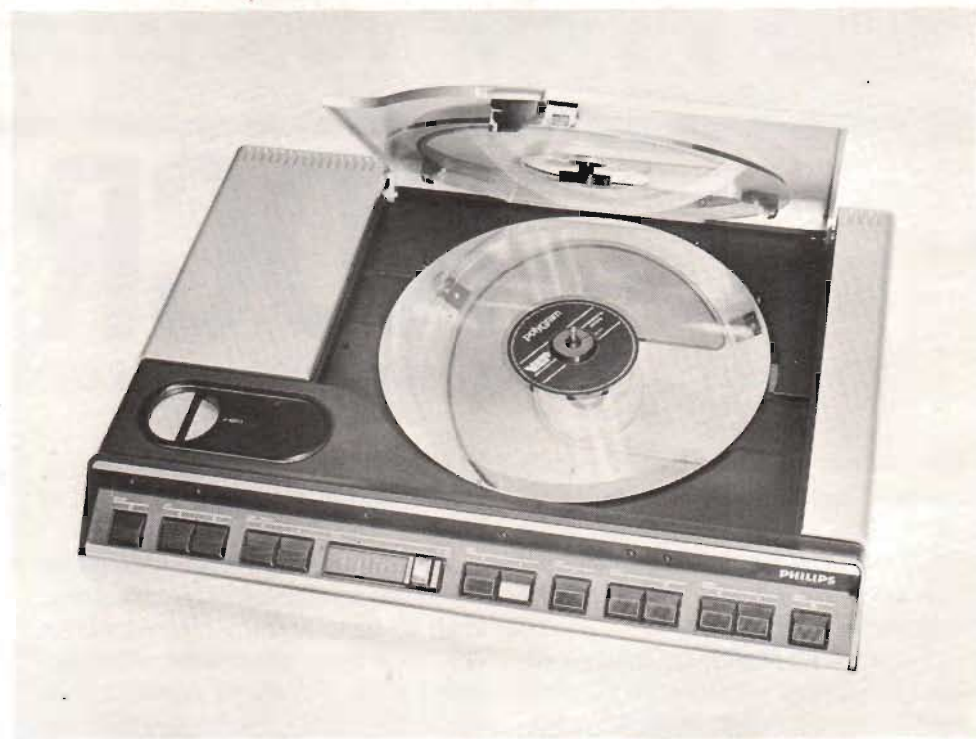
Fig 1. Under det öppnade locket på en VLP-spelare syns skivan. Den är belagd med en skyddande plasthinna. Skivan är till motsats mot vanliga ljudskivor ej känslig för mindre repor.
