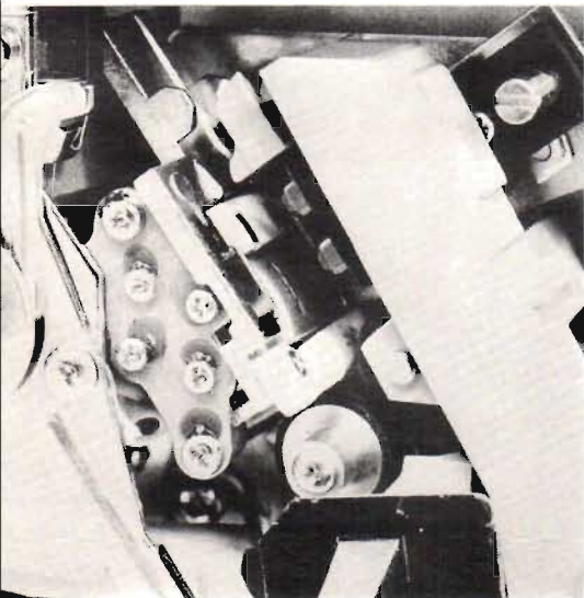
Fig 8. Tonhuvudena i projektorerna är för det mesta mycket svåra att komma åt för rengöring och avmagnetisering. Ett klart lysande undantag bjuder Elmo på där huvudet är lätt åtkomligt utan speciella åtgärder.
