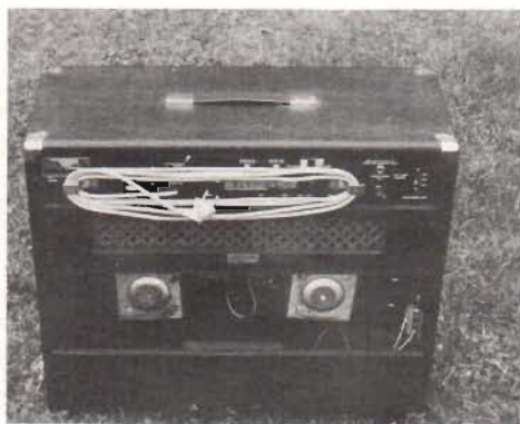
Fig 2. Att Ampeg är så tung torde främst kunna skyllas på chassiet med sina tunga komponenter. Chassiet är för övrigt upphängt i en mjuk elastisk upphängning som effektivt bör hindra direkt övergång av vibrationer från lådan. Som på alla de provade rörförstärkarna sitter strömbrytaren på baksidan liksom även uttag för extra högtalar- och fotkontroller. Observera "sladdvindan".
