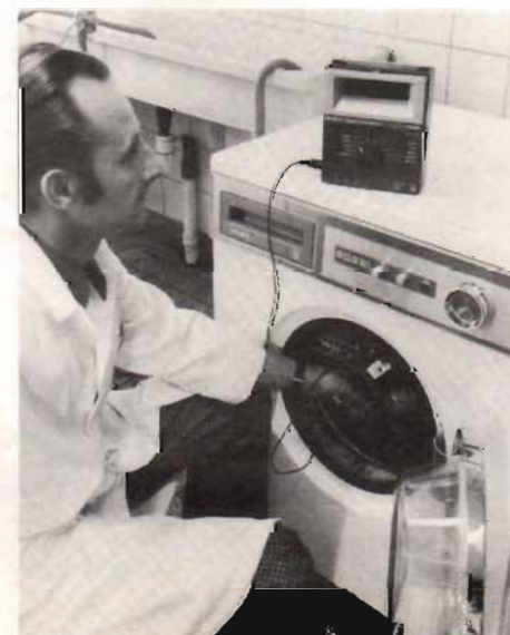
Fig 6. Genom att kontrollmäta vattentemperaturen i en tvättmaskin kan man avgöra om termostaten fungerar riktigt.
