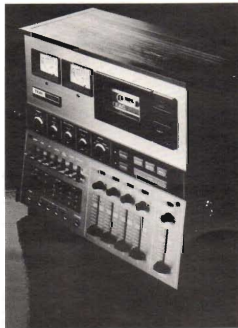
Fig 16. Teac, som också börjat göra receivers och skivspelare, vilka nu kommer i Sverige, har i A-860 sitt mest avancerade kassettdäck för cc-systemet. Inbyggd mixer med fyra ingångar och panpotar på varje. Före/efter-bandlyssning, Dolby och dBX II i samverkan! Inbyggd begränsare, omkopplingsbara utstyringsinstrument (medelvärde, topp) samt tre motorer, varav en servostyrd med fas-låskretsar. Tre tonhuvuden och dubbla kapstanaxlar samt självjusterande tryckrullar ingår i det här påkostade konceptet.
