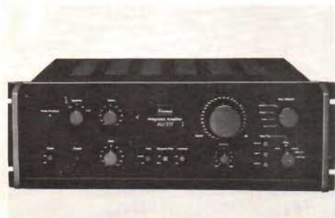
Fig 7. Här syns Sansuis nya dc-förstärkare AU-517, en sambyggd apparat som kostar 3 650 kr ca. Utöver kondensatorlös koppling har man fyra i st för annast vanligare två ellytar, här på 48 000 µF, dubbla nättransformatorer och en stigitid som är 32,3 V/µs. Effekt 2 x 65 W minimum. Flergångad volymrätt i 32 steg.
