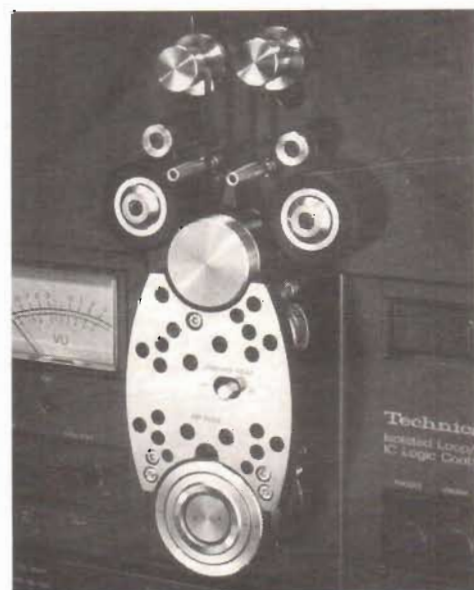
Fig 10. Närbild av Omegadrivningens originella slingor och symmetriska tryckrullar över capstandet med sin lysdiolindikator längst nedtill. Märk lägena för inställning av avspelningshuvudet i den perforerade skölden över huvudena.
