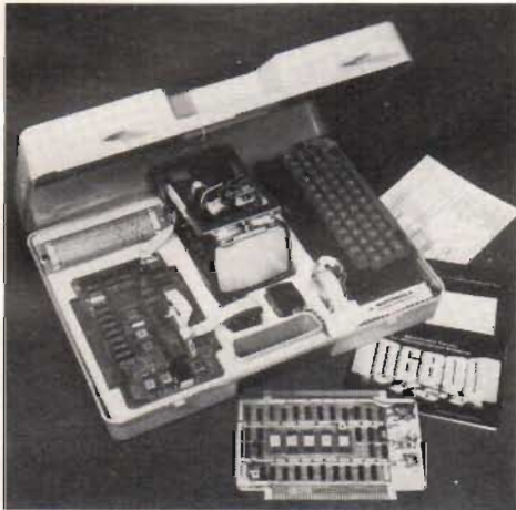
Fig 9. Motorolas ADS-system för utbildning och utveckling av mikrodatörer har ett alfanumeriskt tangentbord för inläsning och använder en TV-monitor för indikering.
