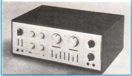
Fig 20. De fina Lux-byggsatserna omfattar bl a det här stora rörsteget, A 3600, liksom förstärkaren A 3400 med de kända tonkontrollerna vilka omfattar valbara övergångsfrekvenser.
