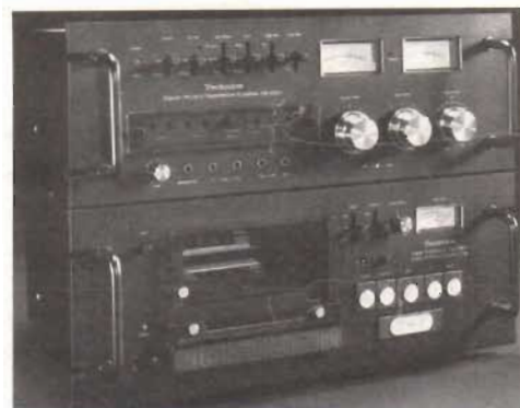
Fig 9. EL-kassetterna är väldigt påkostade och erbjuder hela maskinerier: Här Technics största, RS 690 U , som har tre motorer, tre tonhuvuden i HPF-ferrit, IC-logikkontroll och direkt drift med sluten slinga över dubbel capstan-drivning. Osäkert om någon import sker till Europa. — Märk banduret nere över firmalogon!
