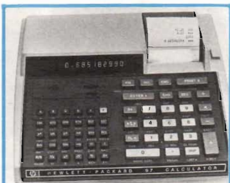
Fig 1. HP-97 är den dyraste dosan av de tre vi granskar ur programsynpunkt. Den har inbyggd skrivare och magnetkortläsare.
