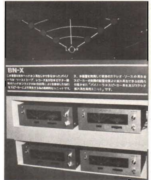
Fig 31. Lysdiödsymbolik i Nivico/RCA:s BN-X-apparatur som är ett försök att ge tvåkanalstereo från en ljudkälla, en tidigare provad idé som egentligen har vissa saker som talar för sig.
