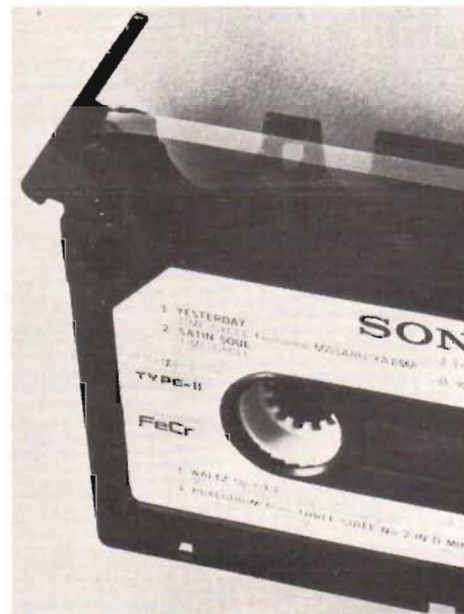
Fig 4. Perspektivet har här krympts ännu lite mera och detaljstudien här visar urtagen för bl a fotoelektriskt stopp för bandet samt tryckrullarna som lyfter bandet ur kassetten.
