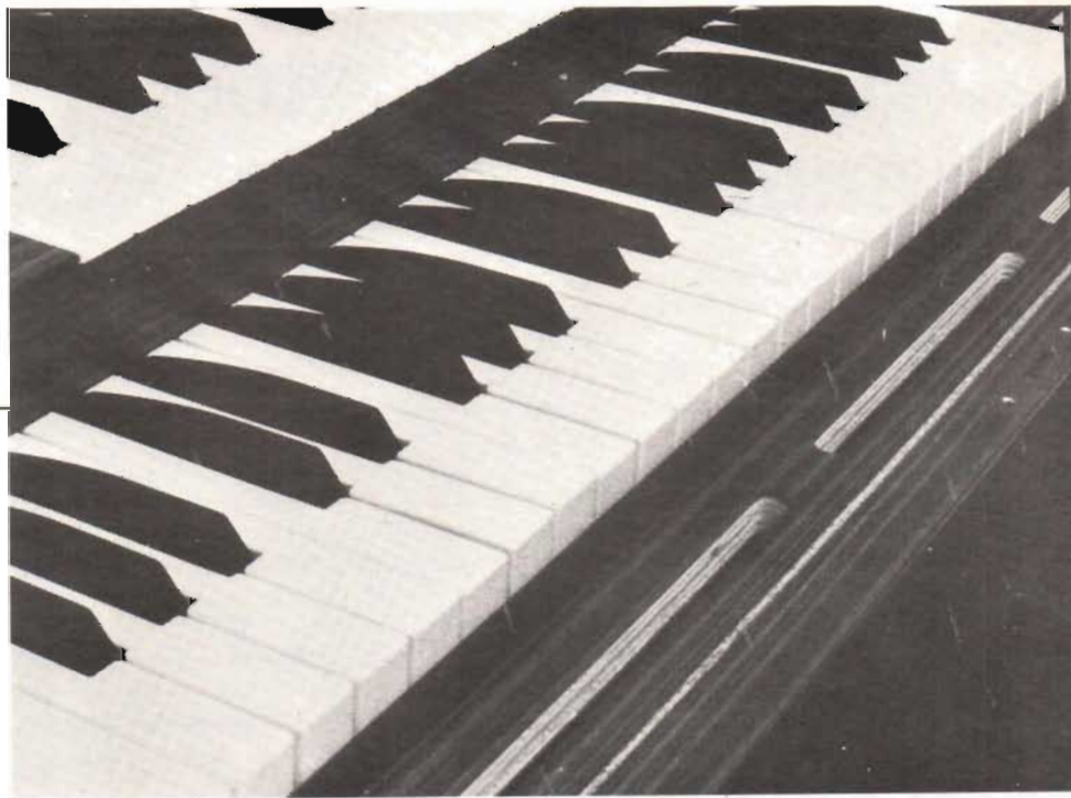
Fig 10. I orgelmöbelen finns en del hål för omkopplare och annat som ej används i grundutförandet. Dessa kan täckas över med träliknande plastlist. Här syns hål för omkopplare till rytmgenerator med tillsatser före övertäckningen.
