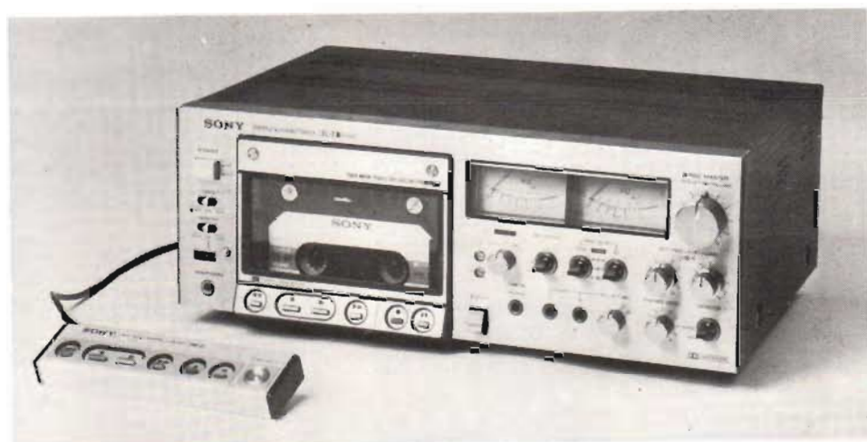
Fig 1. Som alla EL-kassetmaskiner är Sonys EL-7 en stor och solid spelare men i princip förmod som en gängse kompaktkassettspelare. Märk fjärrkontrollenheten, som är ett tillbehör.
