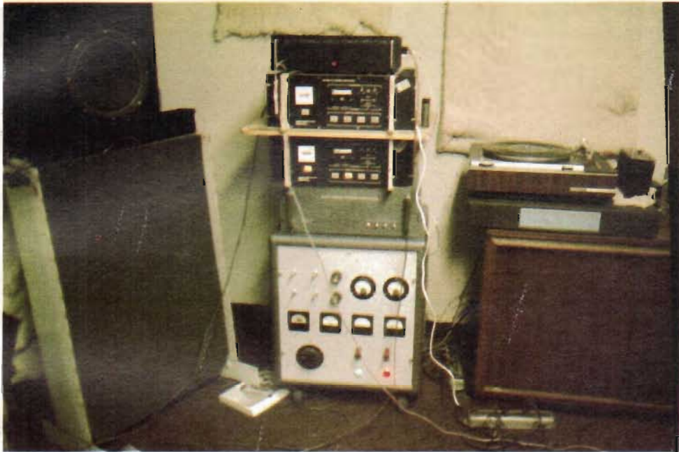
Fig 2. Unikt foto av Forced Field-ljudsystemet. Ty ses "högtalar"-panelen, alltså det rigida men ljudalstrande systemet. Mitt i bilden den elektroniklåda som försörjer panelerna med högfrekvent energi: Vid 70 dB ljudtryck ca 1 000 W. Uppå boxen ligger en trio av Iversons förstärkare A-75 men med lite olika utföranden. Ett effektsteg som skall driva den här anordningen måste ha en full effektbandbredd, obs detta, om minst 500 kHz! Längst upp på högtalarpyramiden syns den i Oslo byggda förstärkaren av "TIM-fri" typ som förf använde som referens under den aktuella USA-resan och som fick figurera mot bl a dessa: Threshold, Ampzilla II, Son of Ampzilla, Infinity Switching Amp, Futterman Mk III, Stax, Audio Research D-100 och ett par till.
