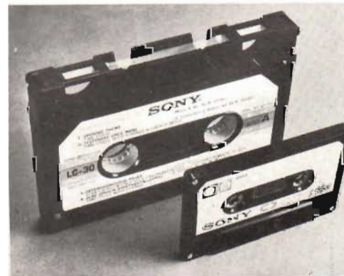
Fig 2. Den här storleksjämförelsen visar relationerna formatmässigt mellan en EL-kassett och en vanlig kompaktkassett.
