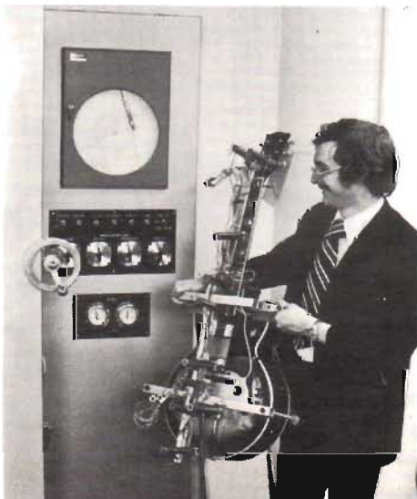
Fig 13. Gitarr i mättrigg för studium av deformationer vid olika belastningar och olika miljöförhållanden.
