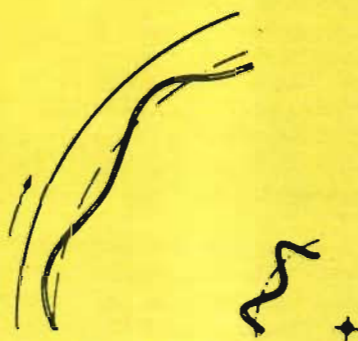
Fig 1. Skissen ger proportionerna mellan graverspårerna i en grammofonskiva för en och samma frekvens men vid förläggning i innerspår respektive utterspår. (Efter Bellander).
