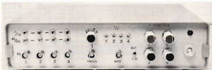
Fig 6. Den färdiga frontpanelen med monterade komponenter och gnuggade texter.
