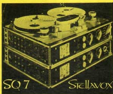
Fig 3. Så här ser en "sandwichad" Stellavox ut i utförandet SQ 7 för 4-kanalbruk — i princip två hopsynkade SP 7. Man kan ansluta 30 cm bandspolar på en utriggare. Modifieringen för M&K tycks alltså bestå i konvertering till åtta kanaler, eller också kan två SQ 7-or ha använts. Idén är smart men inte särskilt billig i jämförelse med en studiomaskin för åtta kanaler, som ju dessutom erbjuder sökautomatik osv.
