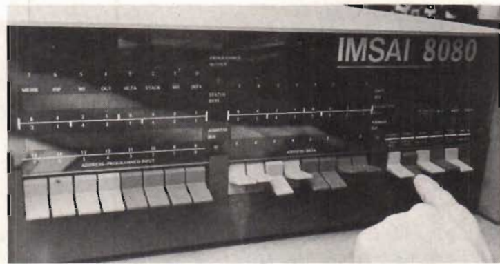
Fig 2. Nu "deponeras" ordet D3 i minnet genom att man trycker ner deposit-tangenten.
