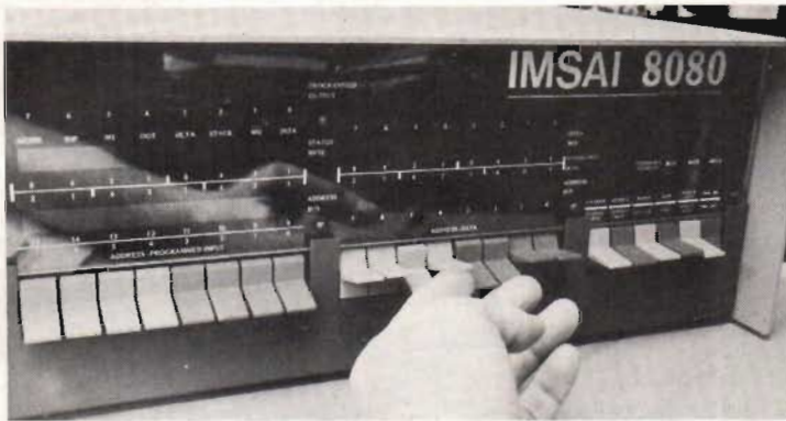
Fig 1. Så här matas det hexadecimala ordet D3 in. Binärt heter detta ord 11010011. Lagg märke till de mellersta omkopplarnas läge, de korresponderar mot binärkoden.
