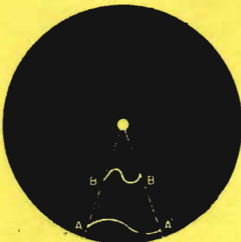
Fig 2. Det som antyds i fig 1 kan också uttryckas så här: En period kommer att uppta en mycket längre del av spåret i skivan vid A-A' än vid B-B' med dess skarpare "böj". Sk pinching uppstår då också lätt hos pick uppen vid avspelnningen av innerspåret i dess krökar, anläggningen äventyras. (Efter Dorff).
