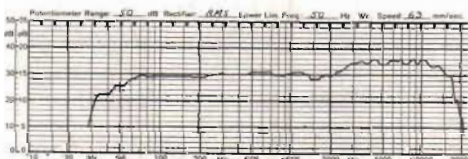
Fig. B. Samma högtalares direktljudkurva mätt i frifältsrum. Här avslöjas om högtalaren har ett överdimensionerat mellanregister.
