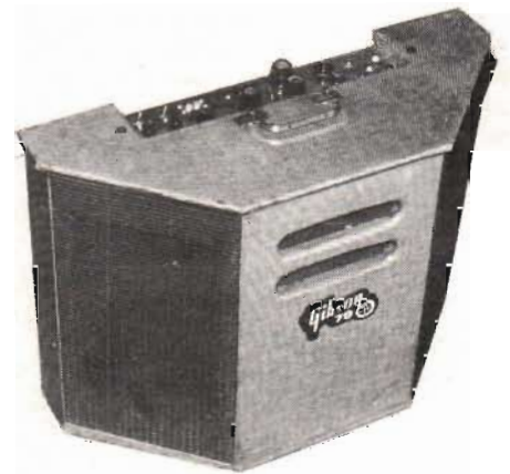
Fig 1. Gibson 79 RTV Multistereo (omkr 1959) stereoförstärkare med ca 2x17 W. Separata kontrollor för vol, bas och diskant för vardera kanalen. Tremolo och reverb (fjädereko). 2 st Jensen högtalare, vinklade 90° i förhållande till varandra. Gretsch lanserade samtidigt ett stereofoniskt gitarrsystem med två separata förstärkare, där den ena halvan tog hand om de tre lägre strängarna och den andra de tre högre.
