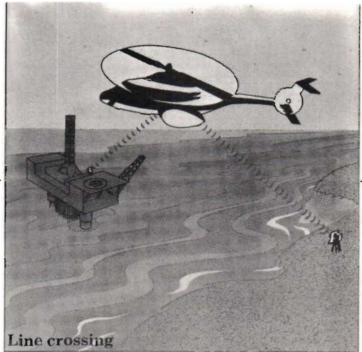
Fig 13. Tellurometers MRD I-installation används numera ofta som flygburet system, varvid både helikoptrar och flygplan kan sättas in. Skissen visar en i dag typisk användning, oljeborring.
