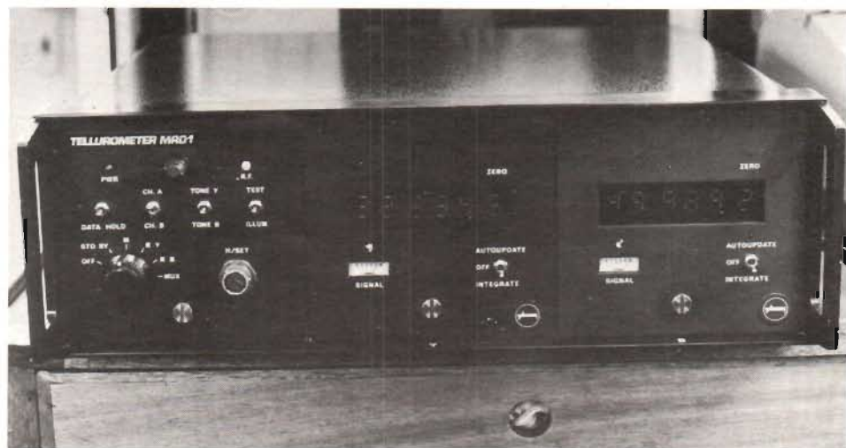
Fig 2. MRD 1-huvudinstrumentet med dess tre aggregat i ett hölje. Den egentliga driften av instrumentet kräver strängt taget inte annat än att man slår till det och kopplar in kanalväljaren. Alla ut-
