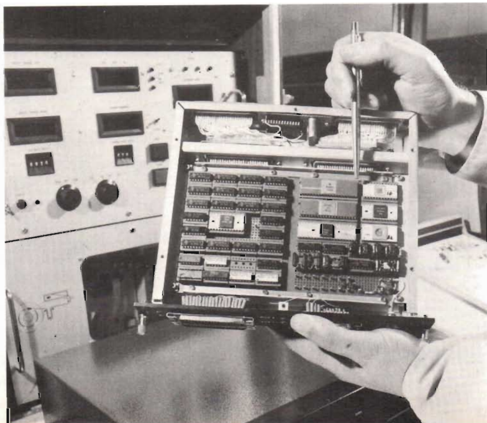
Fig 4. De stativburna fjärrenheterna i mikrovågssystemet behöver inte övervakas utan slås på från huvudinstallationen och går sedan kontinuerligt i drift samt kontrollerar själv närvaron av signal — bärvåg — därifrån.
