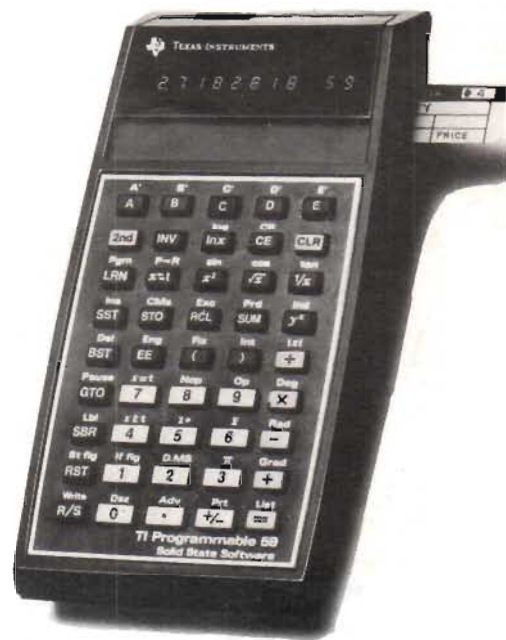
Fig 1. Trots ökad kapacitet har SR-59 nättare dimensioner än "gamla" SR-52. Märk dock att SR-59 blott visar 10 siffror mot den tidigare modellens 12.
