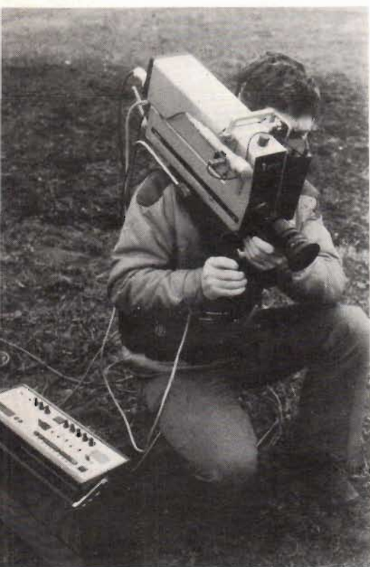
Fig 1. Här visas några av komponenterna i Philips nya system Video 80: Baskameran LDH 10 med 1,5" sökarmötor ansluten till TV-kassetbandspelaren LDL 1100.
