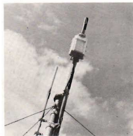
Fig 11. Antenninstallationen ombord till MRD 1. Antennen är rundtagande. Lobvinkeln är 14 grader.
