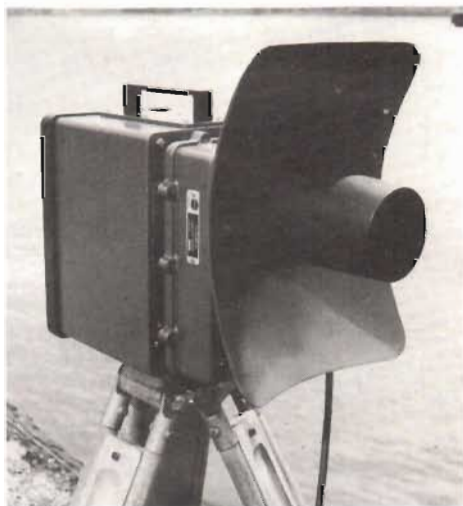
Fig 4. De stativburna fjärrenheterna i mikrovågssystemet behöver inte övervakas utan slås på från huvudinstallationen och går sedan kontinuerligt i drift samt kontrollerar själv närvaron av signal — bärvåg — därifrån.
