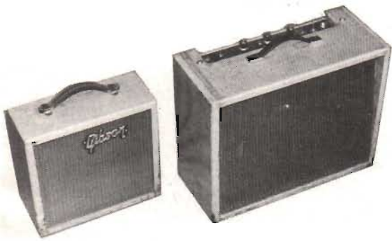
Fig 2. (Vänster). Gibson GA5 Skylark (1959). En liten tidig gitarrförstärkare som såldes i paket med en tapsteelguitar (som hålles på knät). Förstärkaren har bara en volymkontroll och saknar tonkontroll. Ett enkelt slutsteg med 6V6 ger 6 W. Förstärkaren, liksom dess motsvarighet Champ från Fender, är numera mycket eftersökt i USA för inspelningsbruk, då den ger det rätta "dist-soundet" vid mätliga ljudnivåer. En 8" Jensenhögtalare ingår. (Höger). Gibson GA 20T Ranger (1958). Två ingångskanaler med två ingångar på vardera. Separata volymkontroller för vardera kanalen men med gemensam diskantkontroll. Tremolo. Mottaktkopplade 6V6 i slutsteget ger 16 W till en 12" Jensenhögtalare.
