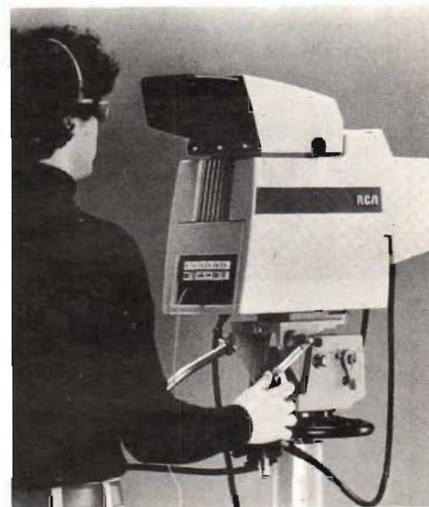
Fig 8. Som komplement till den lilla ENG-kameran TK-76 har RCA nu tagit fram TK-760 som visas på bilden.
