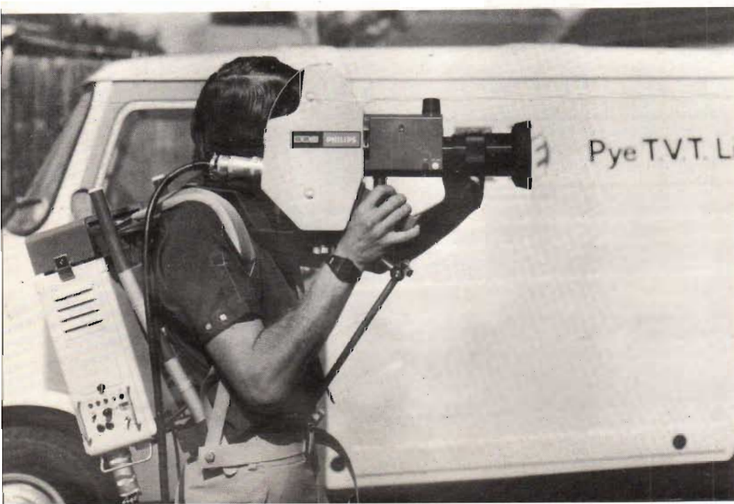
Fig 7. Philips LDK 11 är en portabel kamera som är användbar även för ENG.
