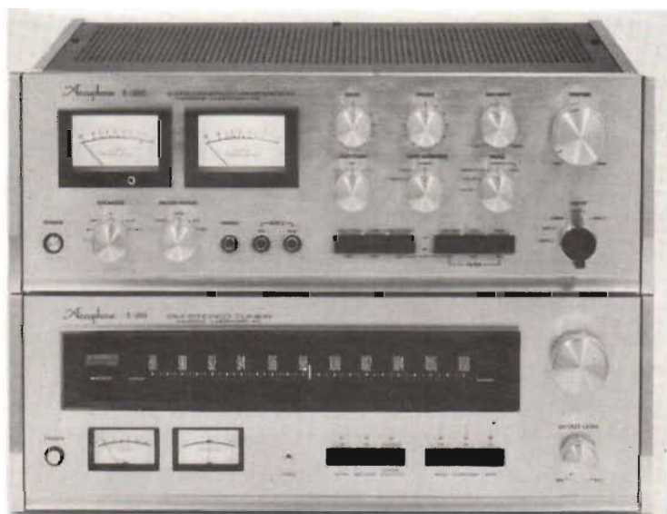
Fig 3. Här har vi den i RT redan provade förstärkaren Accuphase Kensonic E-202 ihop med FM-delen av samma design, T-101. Märk tunerens utnivåreglage längst ned t.h. Den har i Sverige presenterats enligt de nya IHF-normerna, och då får man i mono enligt importören t ex 11 dBf för 2 \mu V som lägsta användbara känslighet. För 50 dB S/N krävs 18 dBf eller 4,5 \mu V. S/N vid 65 dBf och 4,5 \mu V:75 dB. Selektiviteten är omställbar i två lägen, brett och smalt. Stereovärdet för S/N vid 65 dBf eller 1 mV är 70 dB.
