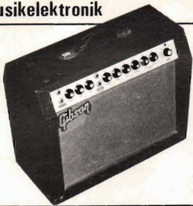
Fig 3. Gibson GA 20 RTV Minuteman (1964). Detta är en modernisering och vidareutveckling av föregående förstärkare (fig 2, h), där man dels har lagt kontrollpanelen ovanför baffeln enligt Fenders mönster och samtidigt utökat kontrollmöjligheterna (bas, diskant, reverb, tremolo), dels ersatt 6V6 med de modernare europeiska EL84. Mottaktkopplade ger dessa 17 W till en 12" Jensen.
