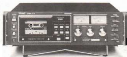
Fig 5. Teac modell C-1 är tänkt för professionellt bruk och erbjuder bl a möjlighet till brusreduktion med dBx. Omkoppling mellan olika bandtyper sker genom att man växlar ett instickskort på fronten. Mätarna är toppvärdeskännande och har stort dynamiskt omfång.
