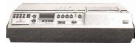
Fig 2. Grundigs SVR 4004 med upp till fem timmars speltid. Bandhastighet 3,95 cm/s, skrivhastighet 8,21 m/s, spårbredd 50 µm. Synbar upplösning större än 3 MHz, audiobandbredd 80 – 10 000 Hz inom 4 dB.
