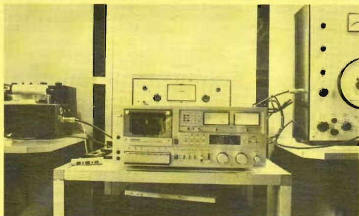
Fig 15. För den inspelningskunnige amatören: Teacs mixer model 2A påhängd utstyrringspanelen MB-20. Sex ingångar, fyra ut, tvåområdes tonkontroller, utläggning med panpot och externsignalanslutning möjliga. På panelen är 0 VU valbar från 75 mV till 1,2 V.
