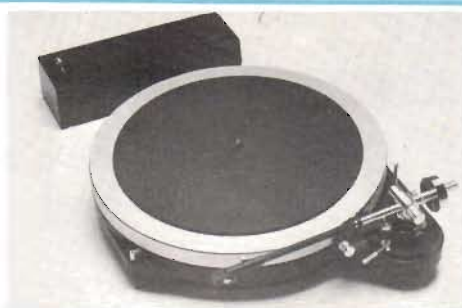
Fig 11. En ny, intressant variant av Micro-verket: Nya DQX, som har en diodmarkering och två hastigheter, extremt snabb fullrotation och en ny sorts skivtallrik. Tonarmen är kanske ändå intressantare - Micros nya 707, se texten.
