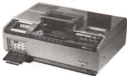
Fig 3. Sony Betamax SL 8000 med speltid upp till tre timmar och 15 minuter. Bandhastighet 1,873 cm/s, skrivhastighet 5,83 m/s. Signal/brusförhållande i bilden 42 dB, i ljudet 40 dB. Upplösning 270 linjer, audiobandbredd 50 – 8 000 Hz.
