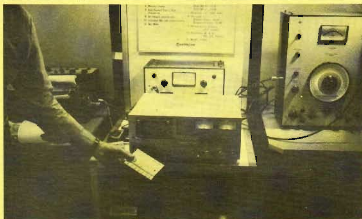
Fig 16. En framtidsvision: Hitachis labbprototyp 6500, mikrodatorstyrd kassettspelare med fjärrkontroll med IR i form av en pluggmodul som sitter i panelen. Alla magnetfunktioner som bias och ekvalisering trimbara steglöst, specialtonhuvuden; många driftlägen inprogrammeringsbara. Kommer kanske hit 1980.
