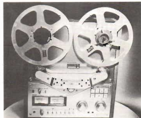
Fig 6. Akai GX-635DB heter denna bandspelare som förmodligen kommer till Sverige på allvar i slutet av 1979. Den har bl a ett räkneverk som visar tid i stället för bandvarv och den tillåter spel i bandets båda riktningar.
