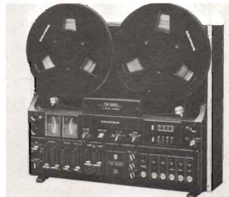
Fig 7. Grundig visade denna intressanta bandspelare, TS 1000. Den har de tre vanliga "amatörhastigheterna" 4,75, 9,5 och 19 cm/s samt dessutom kontinuerligt inställbar hastighet 4-22 cm/s. Räkneverket är försett med förval, dvs maskinen kan fås att stoppa vid en godtycklig mätarställning.
