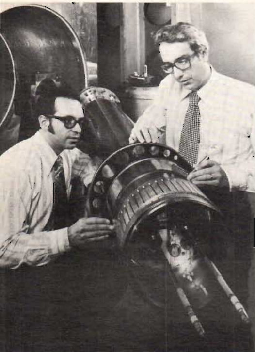
Fig 1. En supraledande elektrisk experiment-generator – rotorn kyls ner till den mycket låga temperaturen -452^{\circ}\text{F} – håller på att konstrueras vid General Electric, Schenectady, New York. Generatorn, som är betydligt starkare än någon annan som nu testas i USA, är konstruerad för att ge 20 miljoner voltampere (MVA) växelström vid varvtalet 3 600. Teknikerna dr Trifon E Laskaris (till vänster) och dr P Agustin Rios vid General Electric förbereder den 1 200 kg tunga, 3 meter långa rotorn för rotationsprov. Ångkylda strömledare, som sticker ut på rotorns framsida, leder magnetiseringsströmmen till de supraledande lindningarna i rotorn.
