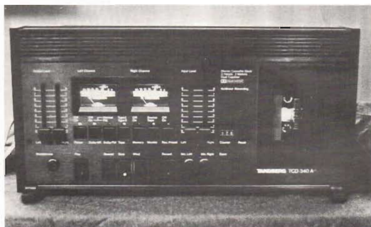
Fig 6. Detta är det nya kassettdäcket TCD 340 A i en version som trimmats för 3M:s Metafineband. Apparaten är dessutom svart, i motsats till standardmodellen som är metallfärgad. Denna version kommer inte att märkvasföras förrän metallpulverbanden finns tillgängliga. Det uppges dock att Tandberg utär sig omtrimning av standardmodellen TCD 340 A när en överenskommen standard är verklighet.
