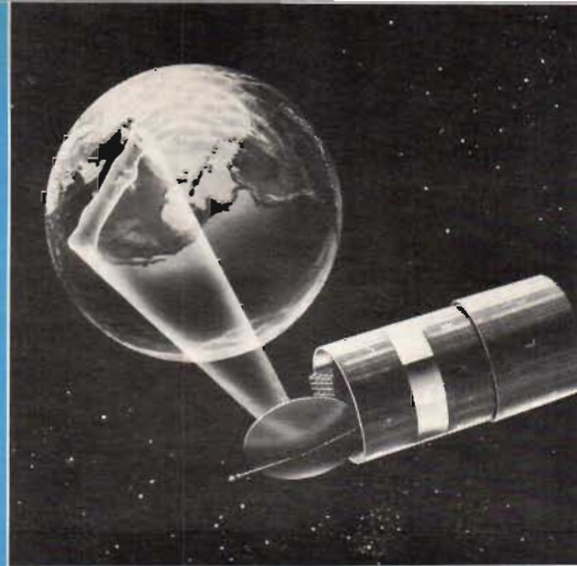
Fig 1. Teckningen visar hur Anik C-satelliterna kommer att täcka Kanada med sina signaler. Här har Hughes-satellitens "solcellskjol" dragits ned och sändarantennen fällts upp efter utskjutningen från rymdfärjan.
