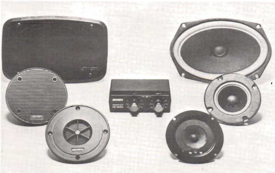
Fig 4. Den kända amerikanska firman Jensen tillverkar såväl högtalare som bilstereoapparater. Bilden visar ett 3-vägssystem med lösa element för valfri montering i bilen. I mitten syns högtalarfiltret som medger reglering av balansen mellan de olika registren.
