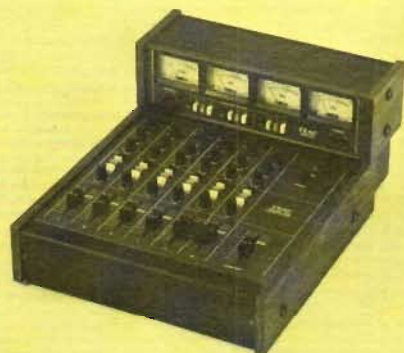
Fig 15. För den inspelningskunnige amatören: Teacs mixer model 2A påhängd utstyrringspanelen MB-20. Sex ingångar, fyra ut, tvåområdes tonkontroller, utläggning med panpot och externsignalanslutning möjliga. På panelen är 0 VU valbar från 75 mV till 1,2 V.
