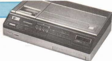
Fig 1. Philips videokassettspelare N 1700 med tre timmars speltid. Bandhastighet 6,56 cm/s, skrivhastighet 8,1 m/s, spårbredd 85 µm. Signal/brusförhållande i luminanskanalen 40 dB, i ljudkanalen 40 dB. Videobandbredd 3 MHz, audiobandbredd 80 – 12 000 Hz inom 8 dB, svaj i audiokanalen mindre än 0,3 %.
