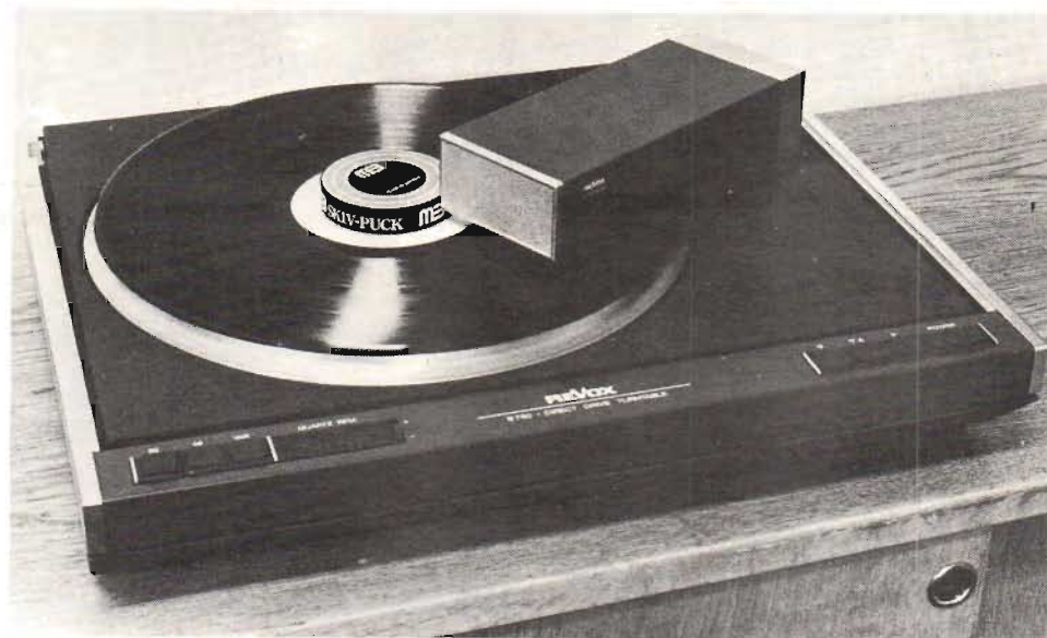
Fig 6. Skivpucken kan göra god nytta mot skeva skivor – men inte på Revox B790 med tangentialtonarm! Hela armhållaren skall föras in över skivans centrum innan man kan börja spela, och den rörelsen hindras effektivt av skivpucken.
