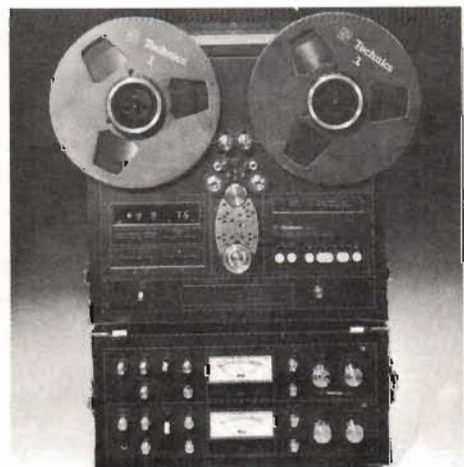
Fig 8. Technics RS-1800 var en av de i särklass dyraste bandspelarna som fanns att se. Den skall kosta runt 40 000 kr och rymmer egenskaper som kvartsstyrd motor med omegadrivning av bandet, digitalt avläsbar tonhöjdskorrektur, tidvisande räkneverk, automatisk inställning av förmagnetisering för olika bandtyper m m.
