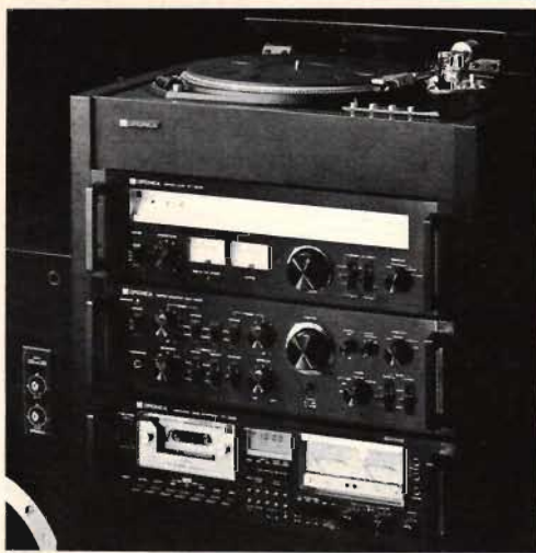
Fig 4. Det av Kjellbergs importerade Japan-märket Optonica (Sharp) utmärker sig för en rikhaltigt utrustad serie enheter. Här ett stativ där hjärtat är den svarta versionen av förstärkaren 4646 om 85 W per kanal med låg distorsion. Volymratten är stegrad i 32 rasterlägen. Tonkontrollerna har ett exklusivt drag – valbara brytfrekvenser. Slutsteget är helt likströmkopplat och komplementärt. Radiodelarna har am-band för både mv och lv (modellen 1616 H/HB) plus sk kalibreringsgenerator för bandning av radioprogram (beskrivet i RT nr 10).
