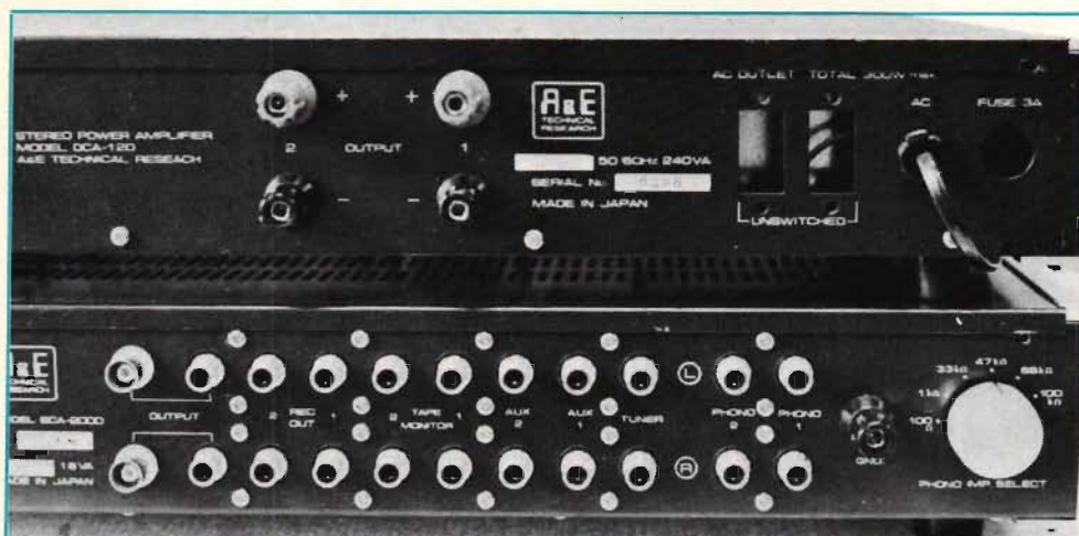
Fig 1. Överst slutförstärkaren och nederst förförstärkaren. Lagg märke till BNC-kontakterna till vänster och omkopplaren till höger för valbar ingångsimpedans hos gramfonsteget.
