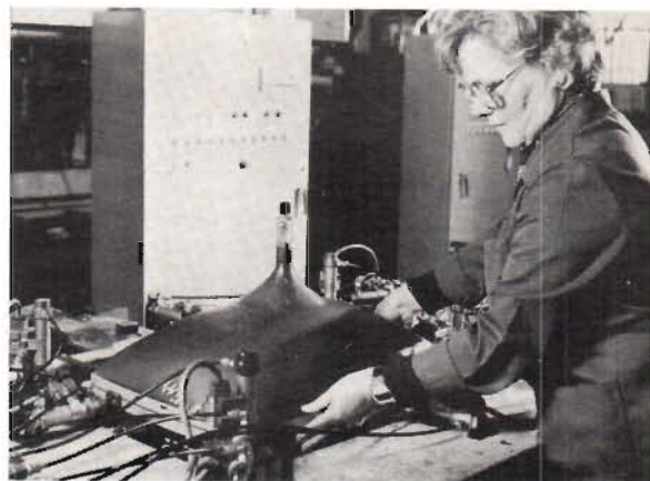
Fig 3. Bildröret implosionsprovas i den här mångarmade testuppsättningen.
