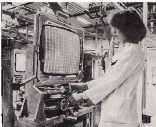
Fig 4. I den sk ITC-processen – som står för Integral Tube Components – sätts bildrören på små vagnar som flyttar sig stegvis genom processen enligt ett automatiserat program. Här förses rören med spolen. Korrekt slutlig inplacering av den sker dock manuellt sedan spolen väl fixerats i sitt läge.
