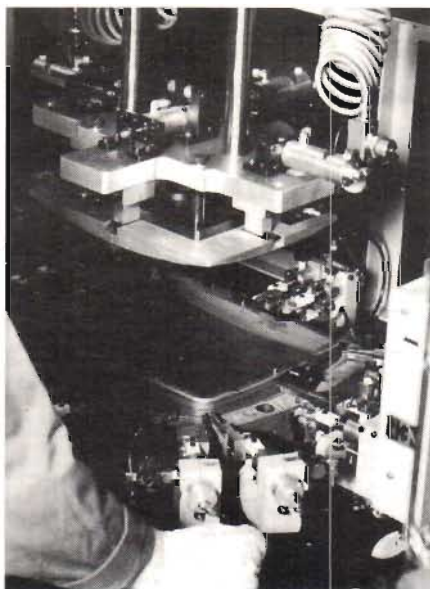
Fig 2. I den här snabba automatsvetsroboten med många punkter sammanförs skuggmaskmontaget i ett moment.
