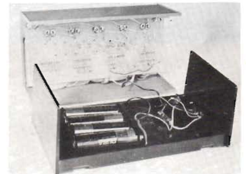
Fig 7. Ladans innanmäte. De stora lödpunkterna överst på det kretskort som skyttar avser anslutning till strömbrytarna.
