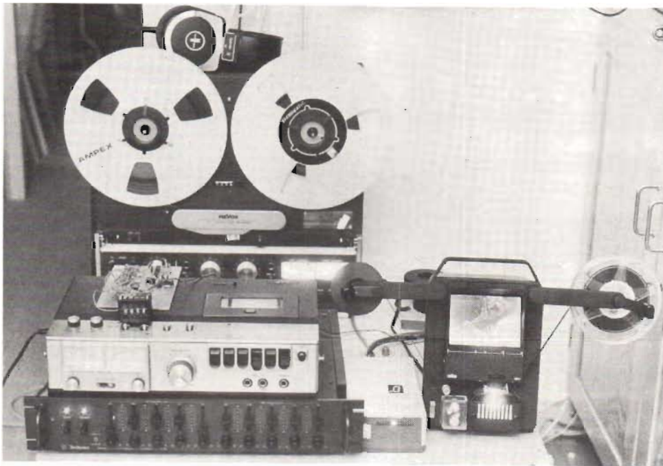
Fig 1. Redigeringen är trots allt den svåra biten i vårt ljudfilms-system. Med den här uppkopplingen kan man dock lösa de allra flesta uppgifter. Ljudet kan kopieras mellan kassettspelare och bandspelare, filmen kontrolleras i en betraktningsapparat, RT:s synk-system håller ljud och bild samman, med den inställbara pulsgeneratoren kan man ljudsätta även stumtagna scener (puls-generatoren här i prototypskick utan låda), ljudet kan bearbetas i det aktiva filtret under kassettspelaren och allt kan slutligen kontrolllyssnas i hörlurar, eller över högtalare om man så vill.
