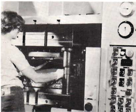
Fig 1. Skuggmasken formas till exakt geometri i ett pressverktyg. Märk ursprunget – Hitachi.
