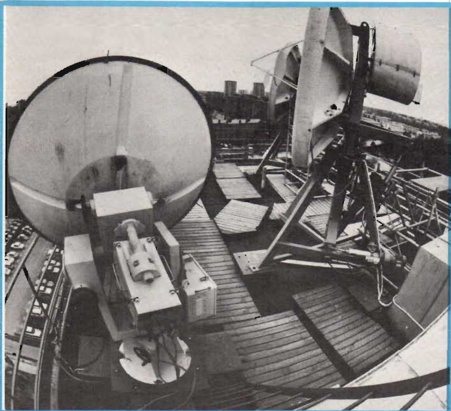
Förutom Televerkets båda antenner i Farsta (t h) har även ESA satt upp en flux-meter för att testa satellitens egenskaper.
