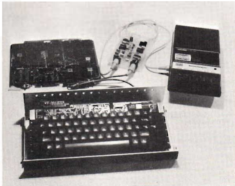
Fig 1. Bilden visar tangentbordet med avtaget lock. Till vänster D2-kortet och överst till höger kretskortet för kassetanpassningen.
