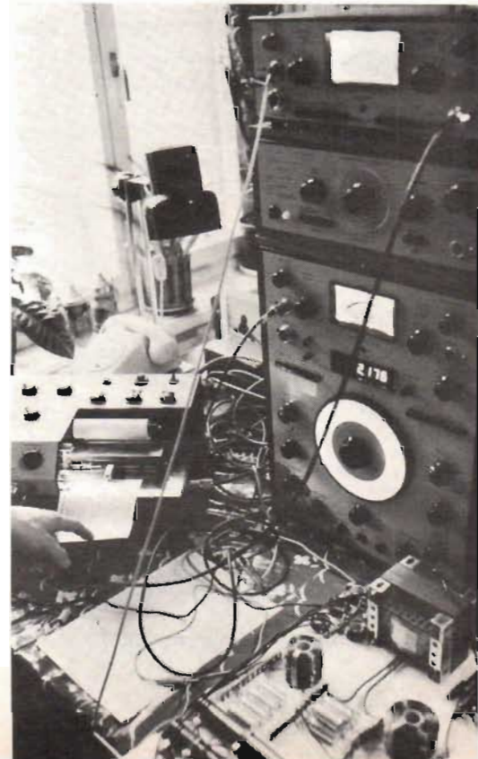
Fig. c. Högtalarna mättes in med svepförfarande och synkrona skrivaruptagningar av utsignalströmmen om matmikrofonen.
