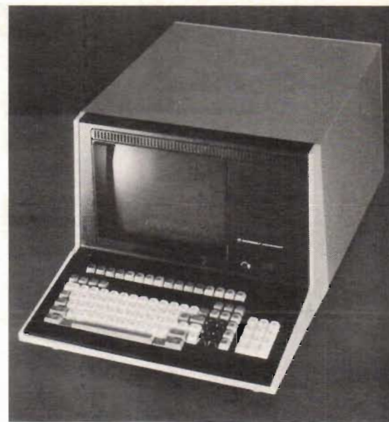
Fig. 2. Exorterm heter denna serie bildskärmsterminaler. Den kan fås med inbyggd Exorciser och tillsammans med flexskiva för Cobol bildar den en komplett dator, lämplig även för mindre företag. Systemet ligger i 50 000 kr-klassen före skatten vid import.
