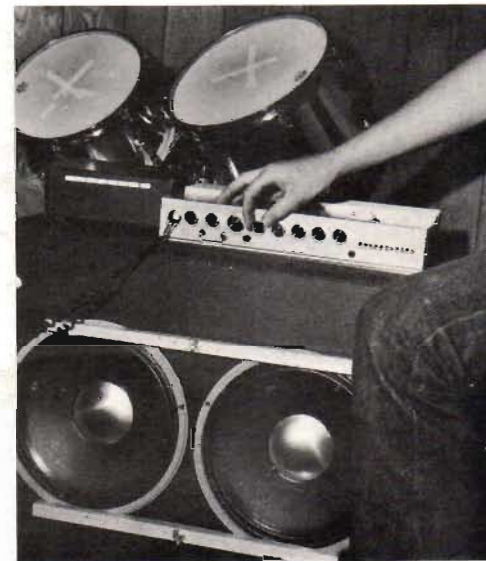
Till höger ser vi förstärkaren med CMOS i kompressionssteget, som skall beskrivas i ett kommande RT-nummer och till vänster den högtalarväxel som användes vid provningarna.
