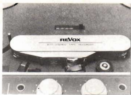
Fig 3. Det utrymme som bandet löper i framför huvudena täcks av ett bortfällbart lock. Även locket över huvudena går att avlägsna. Märk de färdiga hälen för ett fjärde diastyrhuvud mellan kapstan och högra brytrullen!
