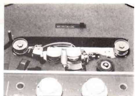
Fig 3. Det utrymme som bandet löper i framför huvudena täcks av ett bortfällbart lock. Även locket över huvudena går att avlägsna. Märk de färdiga hälen för ett fjärde diastyrhuvud mellan kapstan och högra brytrullen!
