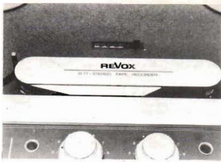
Fig 3. Det utrymme som bandet löper i framför huvudena täcks av ett bortfällbart lock. Även locket över huvudena går att avlägsna. Märk de färdiga hälen för ett fjärde diastyrhuvud mellan kapstan och högra brytrullen!
