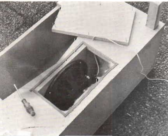
Fig 2. Här kan man se hur elementet är åtkomligt genom manluckan sedan hornet lagts på rygg. Observera, att ingen mellanvägg förekommer i hornöppningen på denna tidiga version.
