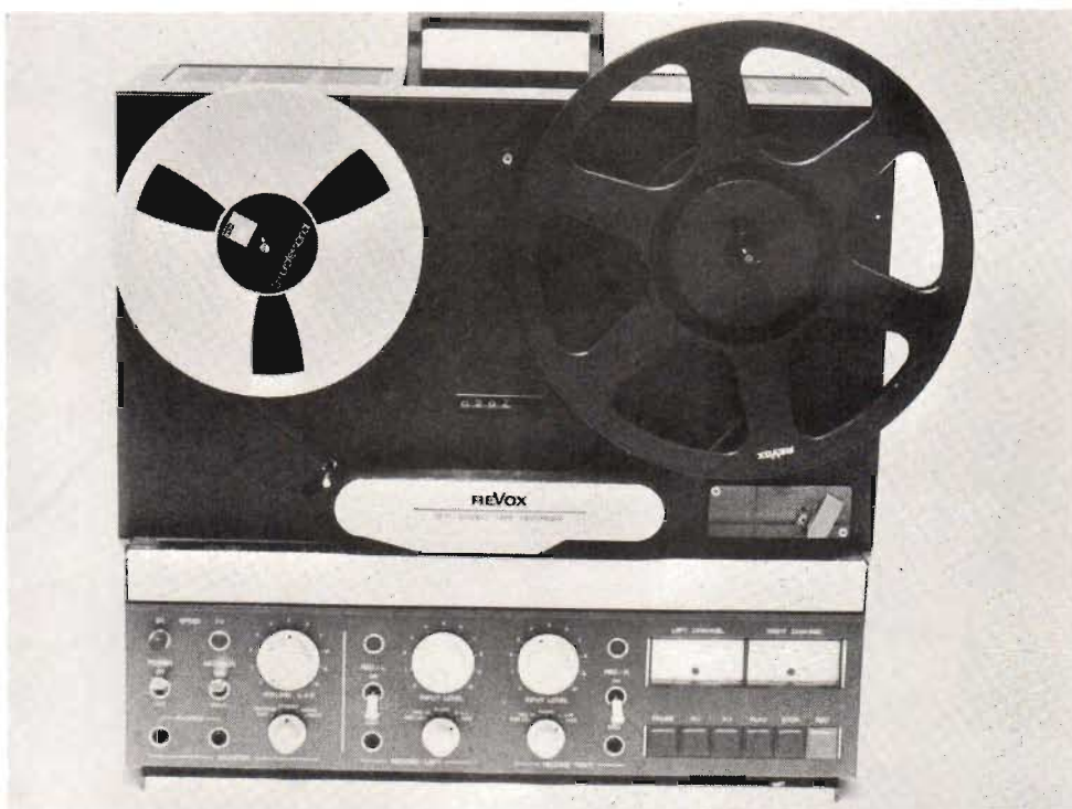
Fig 1. Nedtill på spelaren syns manöverfältet med omkopplare och rattar samt utstyrningsinstrument. Panelen är liksom tidigare upphöjd framför själva däckytan. Överst syns det kraftiga bärhandtaget.
