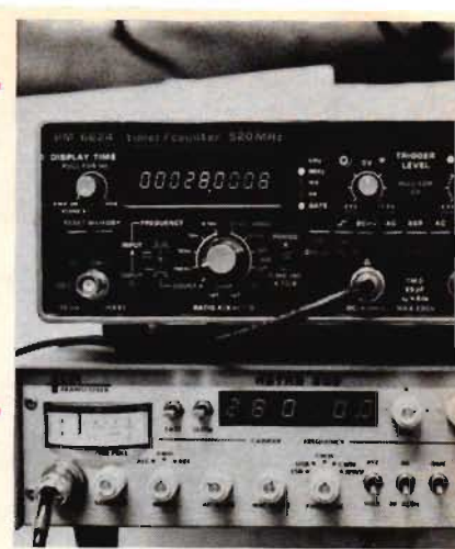
Fig 1. Ssb-transceivern Astro 200 är inte mycket större än en modern högklassig räknare, i det här fallet Philips 6624.
