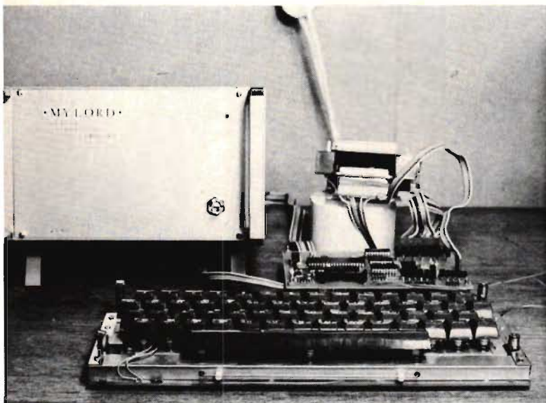
Fig 1. Datorn Mylord med tangentbord och tryckverksenhet (skrivare för 40 nedslag).
