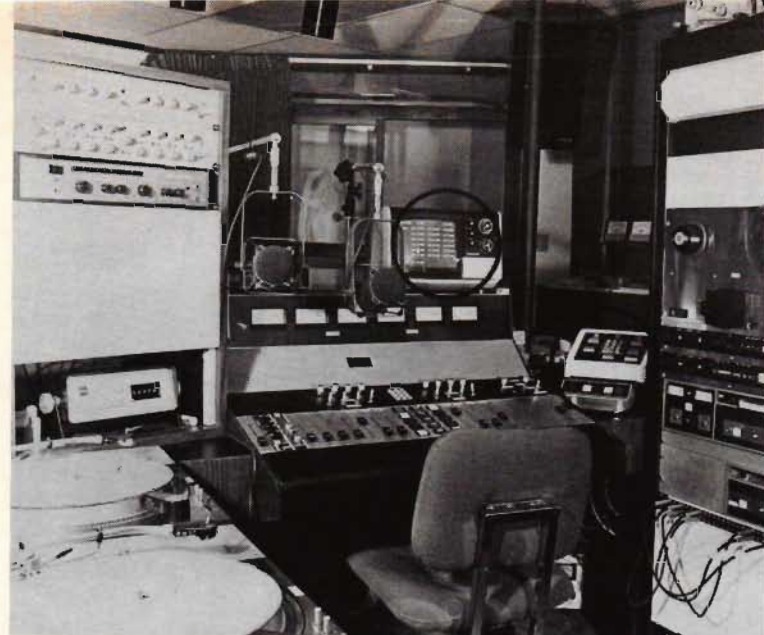
Fig 1. Den här interiören – som bra mycket liknar en mobil studio – ser ut som en typisk OB-vagn för överspelning och livesändande av musik och prat. Inringade på fotot syns de nya MARC-enheterna med sina tryckknappväljare o s v. Över kontrollbordet syns bildrörsenheter där alla inslag plus den digitala klockan kan visas. Märk de mycket stora och vindskyddade mikarna på två ställen ... Mycket av grejorna på fotot verkar hembyggen, man känner t ex igen en Heathkitgenerator uppe th.
