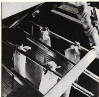
Fig 3. Anod-katod-arrangemanget för den elektrolytiska reningen. Man använder en nickelsulfamatlösning med kulor eller pellets för sk S-nickelanoder. Pumpen i behållaren har en kapacitet om 12 000 per timme och ett mikrofilter finns för mekanisk rening. Pumpstanken innehåller vidare bla värmegivaren om 2 500 W, temperatursensorer och nivåkontrollavkännare samt synliga, nivåkännande organ. Ner till en mikron små orenheter kan filtreras ut! Pumpen är av syrabeständig, rostfri metall (molybden). Filterhuset rymmer åtta filterskikt och verkan kan ställas in mellan 5 och 1 mikron. En huvudventil reglerar flöde och omsättning.
