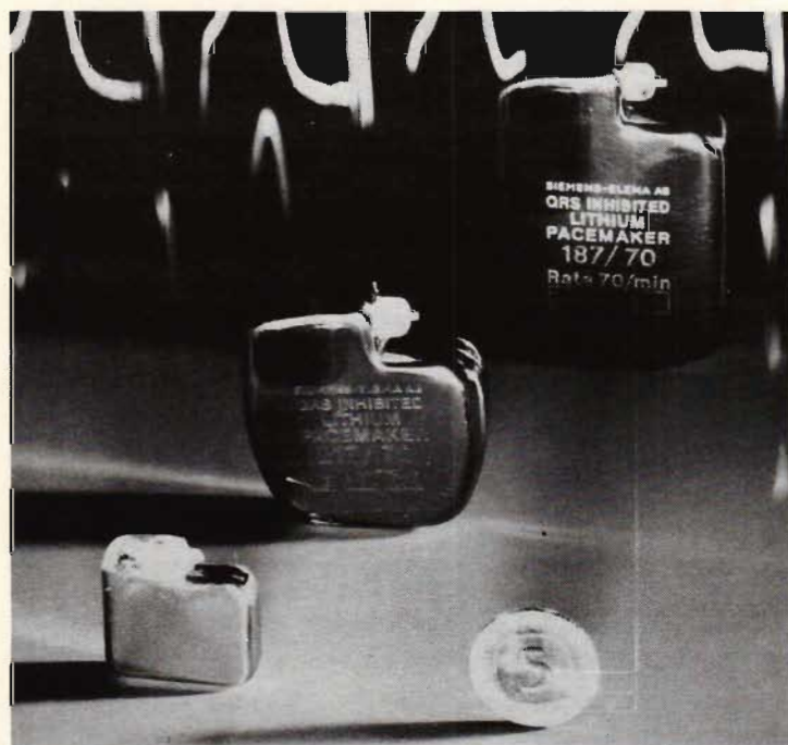
Fig 1. Siemens-Elemas nyaste litumpacemakers. Den minsta ar av samma storlek som 5-kronan i förgrunden.
