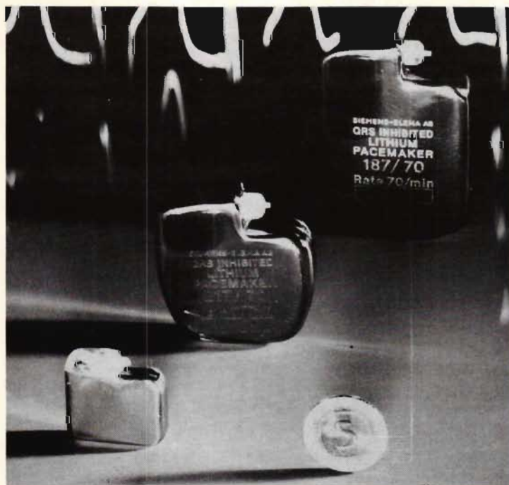
Fig 1. Siemens-Elemas nyaste litiumpacemakers. Den minsta är av samma storlek som 5-kronan i förgrunden.
