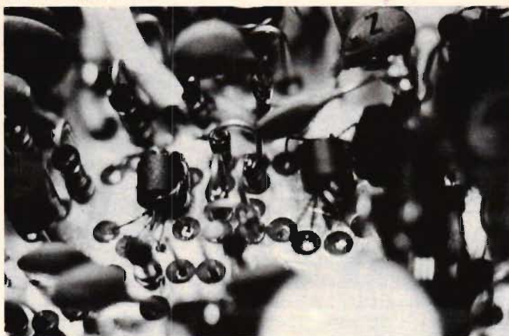
Fig 3. Svalt mottagarens som sändarens signaler blandas i dubbelbalanserade diodblandare. Vi ser här mottagarblandarens toroidtransformatorer och mellan dessa dioderna.
