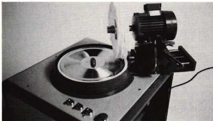
Fig 12. Polermaskin för modermatriser. Den beskriver en fram- och återgående rörelse i tre cykler, och väsentliga egenskaper vid poleringen avser skärvinkel, periferihastighet, polerskivans form och material samt polermedlet.
