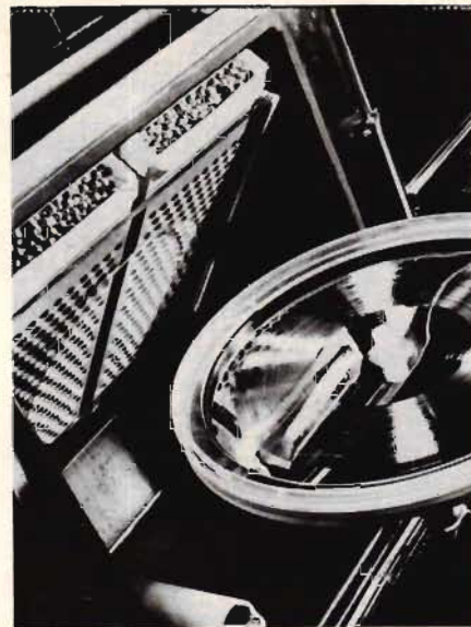
Fig 5. Varje utfällningsstation innehåller montageplattor för både 10 och 14 tums lackskivor (mödrar) och metalldelar. Den genomskinliga plastbaffeln mot vilken matrisen läses i navet erbjuder en lägeshållning om bättre än \pm 0,01 mm. Anodkorgarna, som syns på bilden, ligger lutade mot underlaget medan elektrolyten injiceras i rätt vinkel till katoden genom ett hål mellan anodkorgarna. Bronskatodaxlarna är vinklade för att medge tillförseln av elektrolyt till katoden, dvs till den del som skall beläggas eller elektroformas.
