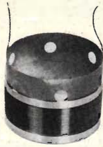
Fig 9. Talspole med kortslutningsring i varje ände, "Dynamic damping".
