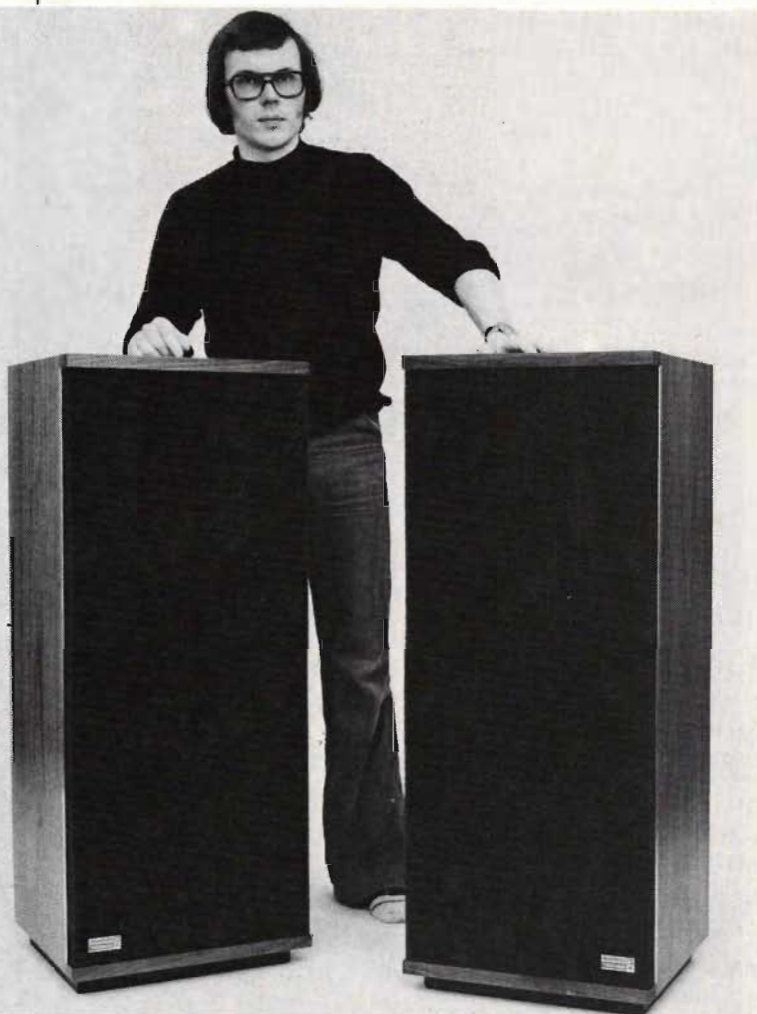
Fig 1. Artikelförf och CM 3, Mk 1 (ett baselement). Konstruktionen omarbetades och försågs i den färdiga versionen med två baselement. Se även fig 6.
