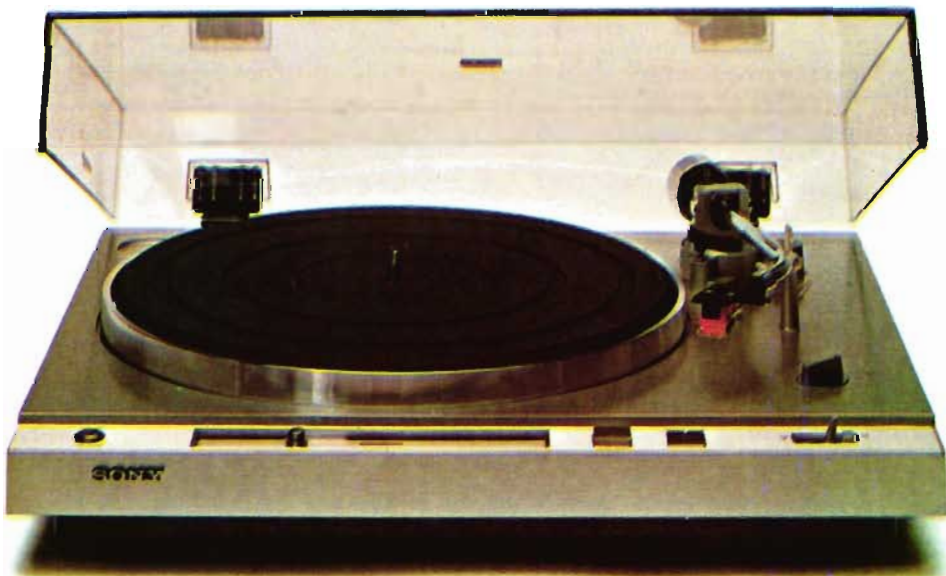
PS-X35 är en helautomatisk skivspelare som också går att manövrera manuellt. Den är direkt driven med en BSL-motor som bara har en enda rörlig del, ringmagneten. Den kommer aldrig i kontakt med någon annan del av skivspelaren, vilket gör motorn praktiskt taget outslitlig. Motorns varvtal regleras av ett kristallstyrt magnediskservo som ger skivspelaren ett så lågt svaj som 0,05%, vilket är långt under den hörbara gränsen. Den precisionslagrade tonarmen tillåter mycket låga nåltryck utan att spårningsförmågan försämrats. Cirkapris: 1600:—
