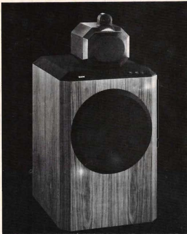
Fig 2. Den nya kontrollhögtalaren skall kunna drivas också i det här skicket. "Huset" med de två högtonelementen är vridbart. Basdelen med öppning mätt på sitter i ett eget inre hölje i lådan, som är mycket kraftigt förstärkt mot inre resonanser.
