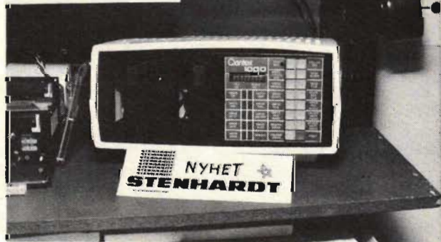
Fig 6. Quantex 1000 är ett massminne med 640 k byte kapacitet per två bandkassetter.
