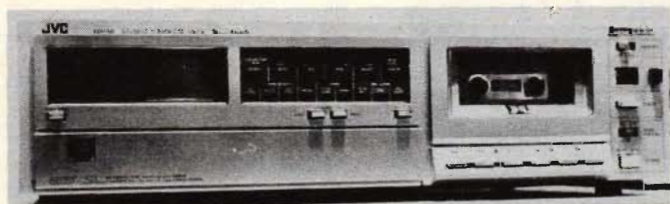
Fig 2. Ett annat sätt att använda mikroprocessorn på visade JVC med denna maskin som kallas KD-A8 och som också kan nyttja metallband. Mikroprocessorn ingår här i vad man kallar BEST Tuning System. BEST är då tänkt att stå för Bias, Equalization and Sensitivity of Tape tuning och är ett förfarande som själv ställer in nödvändiga parametrar för band av vad slag det vara må. Apparaten gör själv först en provinspelning, om man så önskar. Provinspelningen startar genom att 6,3 kHz spelas med ökande förmagnetiseringsnivå. Bandet återspolas sedan automatiskt och nivån känns av. Med ledning av hur utnivån varierar kan maskinen därefter bestämma en optimal förmagnetiseringsnivå och ställer så in den. Sedan spelar man in en signal på 1 kHz som referens för inställning av inspelningskorrektur. 1 kHz-signalen följs av en signal på 10 kHz med varierande inspelningskorrektur. Efter den ges åter en 1 kHz-signal med 16 olika nivåer för inställning av känsligheten. När detta block är inspelat, återspelar maskinen igen och läser av resultatet och väljer den korrektion och den förstärkning som ger rätt resultat för det aktuella bandet. Hela processen sker alltså alltigenom automatiskt.
