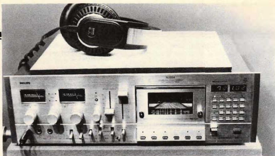
Fig 1. Philips visade detta kassettdäck, N2554, som är klart för metallband. Med metallband skall man uppnå rak frekvensgång från 30 till 20 000 Hz, en maximal utnivå som ligger 3 dB högre än referensband enligt DIN för krom vid 315 Hz och 10 dB högre än referensbandet vid 16 kHz. Signal/brusavståndet uppges till 57 dB för metallband utan brusreduktion. Två brusreduktionssystem finns inbyggda: Philips eget DNL och Dolby. Det senare systemet skall ge mer än 8,5 dB reduktion av brusnivån. Allt detta uppnås med ett kombinerat in- och avspelningshuvud av FSX-material, dvs Sendust.
