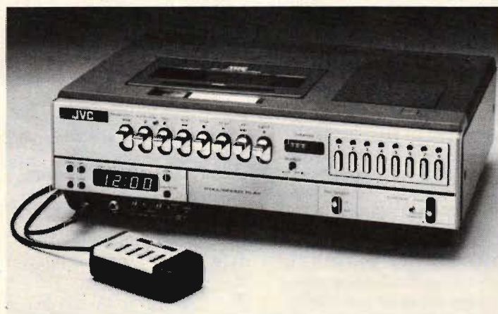
◀ Fig 4. JVC:s flaggskepp när det gäller VHS-spelare heter HR-3660EG. Den ger möjlighet till stillbild och långsam bildåtergivning liksom spelning med dubbel hastighet. I det senare läget kopplas en speciell tonsänkande krets in som bibehåller talet på samma tonhöjd trots den dubbla hastigheten! Japanerna tycks mena att vi på detta sätt kan konsumera dubbelt så mycket tv på samma tid... Nåja, en del tv-program kanske man skulle kunna avnjuta på detta sätt, och framför allt kan möjligheten vara nyttig om man letar efter vissa avsnitt i program.
