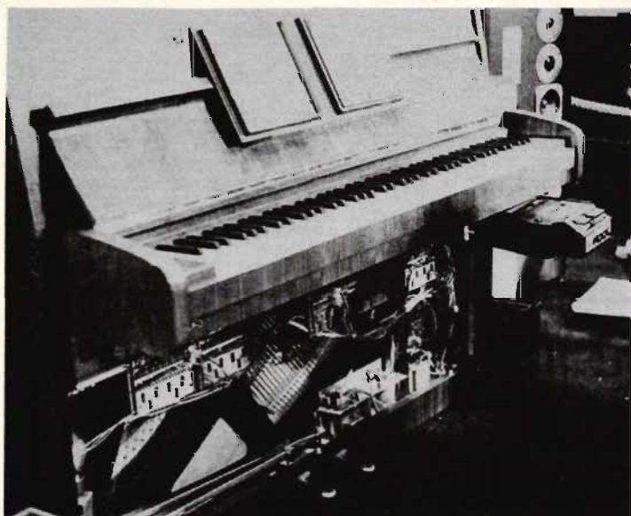
Fig 8. Här är sista ordet vad gäller ljudåtergivning: Ingen annan apparat kan återge pianoljud lika bra som ett piano, menar Marantz. Det har firman ju rätt i. Alltså bygger man in ett styrsystem i ett vanligt piano och låter det hela styras av en mikroprocessor. Inspelning i systemet sker genom att en pianist spelar på pianot och hans nedslag, kodade i tid och styrka etc, lagras digitalt på ett kassettband. Vid uppspelningen reproduceras hans framförande exakt genom mikroprocessorstyrningen! Det hela är alltså samma idé som pianolarullarna som fanns i början av seklet, med skillnaden att man nu använder elektronik i stället för mekanik i styrningen. Tekniken går framåt, men idéerna är eviga, skulle Platon ha sagt!
