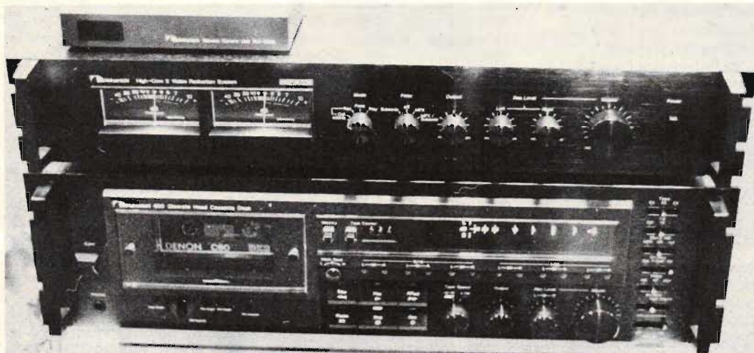
Fig 4. Nakamichi har också anammat Telefunken's hi-com men förändrat den och lagt till en egen II:a i beteckningen. Resultatet skall bli en ännu effektivare och felfriare brusundertryckning. Nakamichi hi-com II finns bara som lös enhet, här tillsammans med Nakamichi-spelaren 680.
