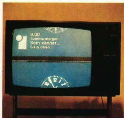
Fig 3. Text-tv sänds på lediga tv-linjer i bildväxlingsluckan. Normalt skall dessa linjer ej vara synliga i en tv-bild. Utöver text-tv-signalerna sänds också här testsignaler, s k ITS-signalerna.
