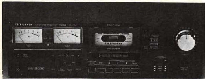
Fig 3. Telefunken's brusreduktionssystem hi-com återfanns hos inte mindre än 15 tillverkare, de flesta tyska. TC 750 från Telefunken är ett högklassigt däck med möjlighet att använda metallband och med inbyggda hi-com-kretsar. Med metallband skall man få ett brusavstånd på 78 dB, med kromband ett par dB lägre. Man använder ett kombinerat in- och avspelningshuvud av Sendust. Data i övrigt upptar frekvensomfånget 30-18 000 Hz med metallband och 0,12 % svajning enligt DIN. Kapstanaxeln är direkt driven och man har satt in en separat motor för bandspolarna.
