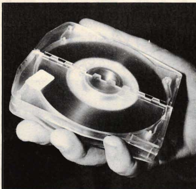
◀ Fig 6. Framtiden i våra händer? Här är Basf:s kassett till LVR-spelaren. Den är som synes mindre än allt annat vi sett i videoväg. Storlek och allmänt utseende är ungefär som en 8-spårskassett för bilstereo. Som synes innehåller kassetten blott en spole, upp-tagningsspolen sitter fast i apparaten. Det innebär att bandet måste spolats tillbaka helt i kassetten innan man kan ta den ur spelaren. Väntetiden kan bli maximalt ca 1,5 minuter, vilket kan vara ganska långt, och helt klart är många gånger längre än för något annat videosystem.
