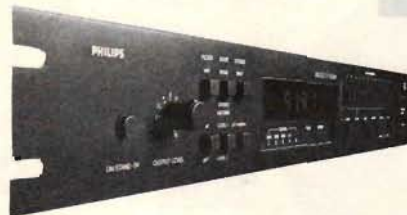
Fig 3. Konventionella fm-mottagare trängs alltmer ut av digitala syntesmottagare. Här är AH 180 från Philips. Syntestekniken ger oöverträffad stabilitet, men kan i stället ge andra bekymmer. Främst har det varit mycket dyrt att förverkliga saken, men numera kan man, tack vare de "obligatoriska" högintegrerade kretsarna, komma ner till rimligare kostnader.
