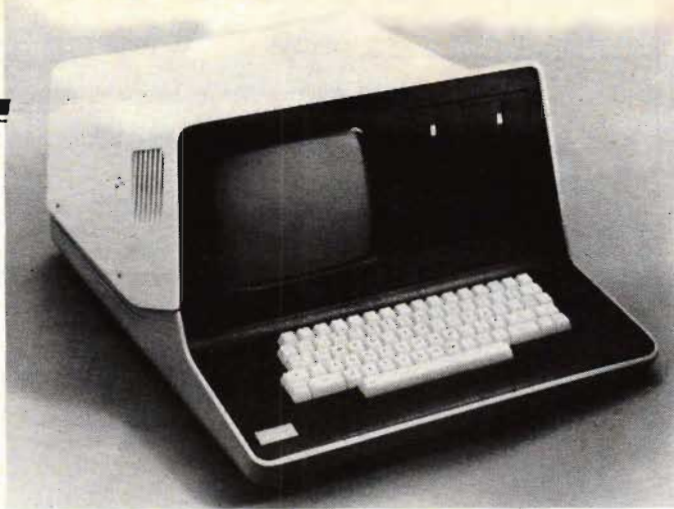
Fig 5. Microset heter ett nytt utvecklingsystem från Motorola. Det är framtaget vid den tyska divisionen. Processor är 6809.
