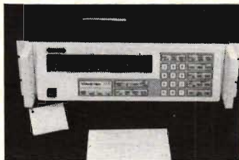
Fig 8. En generator där man kan programmera kurvformen tillverkas av Wavetec . Modellen heter 175 och har IEEE -bussanslutning.
