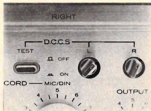
Fig 2. För anpassning till olika bandtyper finns också möjlighet till inställning av förstärkning för kompensation av olika bands känslighet. Om känsligheten avviker från det inställda värdet, hamnar Dolby-nivån fel och Dolby-kretsarna ger kraftig påverkan på ljudet.
