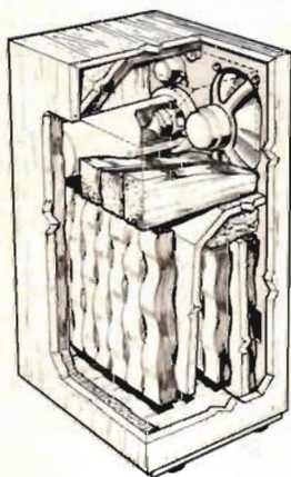
Fig 8. Referens nr 2 var IMF:s ljudledningshögtalare TLS80, som här visas i genomskärning. Märk särskilt pipans koniska utformning. Det var den här högtalaren som fokuserade vårt intresse på ljudledningsprincipen med dess goda basåtergivningsegenskaper.
