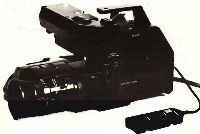
Fig 2. Sonys färgkamera för hembruk heter HVC 2000M. Den har elektronisk sökare med tvärställt bildrör, som framgår av bilden. Kame-rarörret har diametern 2/3 tum och zoomen har sex gångers omfång. Objektivet kan drivas med motor eller manuellt. Trots att man använt ett mindre kamerarör än Panasonic väger denna kamera något mer eller 2,75 kg. Den större vikten får väl då tillskrivas det motordrivna objektivet i första hand. Första gången vi passerade Sonys monter och såg kameran där suckade vi uppgivet över dess färgkvalitet. Nästa gång vi passerade hade man rättat till det hela. Det här tyder på att vi som tilltänkta användare i hemmen kan få problem med att ställa in rätt färgbalans: Här finns säkert otaliga tillfällen att glömma och göra fel. Enda möjligheten att effektivt kontrollera inställningen är att ansluta en färgmonitor, och till och med då kan man lura sig.
