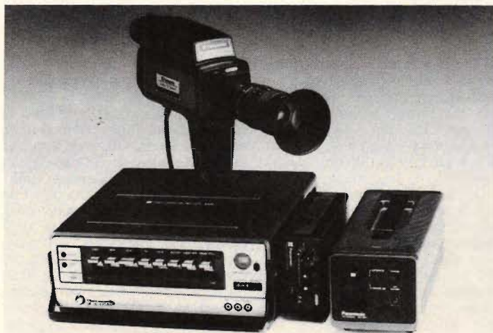
▶ Fig 5. Bärbara videospelare med tillhörande färgkameror visades av flertalet fabrikanter. Här är Panasonic NV-8400 E med nädel längst till höger och färgkameran NV-3300 E med anpassningsenhet mellan spelaren och nätdelen.
