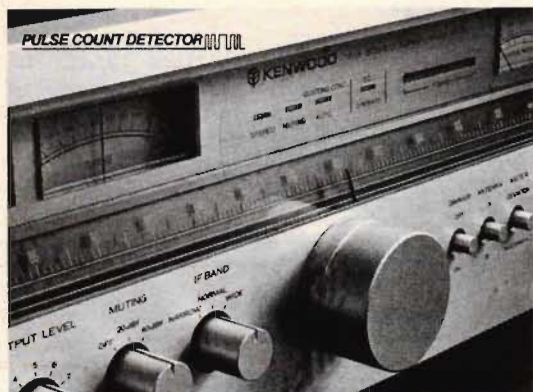
Fig 4. Kenwood har tillämpat en annan teknik för att få fram en högklassig fm-mottagare. Här har man koncentrerat sig på detektorn. En konventionell kvotdetektor i fm-mottagare kan ha svårigheter med att arbeta linjärt över hela fm-spektrumbredden. Därför använder man numera allt oftare en lösning med fas-låsta slingor, pll. De ger större linjäritet. Kenwood har valt att i stället använda en pulsräknande detektor som ger ett praktiskt taget obegränsat frekvensområde åt detektorn samtidigt som linjäriteten skall bli obegränsat god! God cigarr, det där, och faktiskt gammal: Redan 1960 hade vi i RT en byggbeskrivning på en mottagare med pulsräknardetektor. Den följdes av flera utgåvor under åren. Kenwood har alltså anammat den tekniken i tunern KT-917 och man uppger där att klirrfaktorn vid monomottagning är 0,02 % och i stereo 0,05 %!
