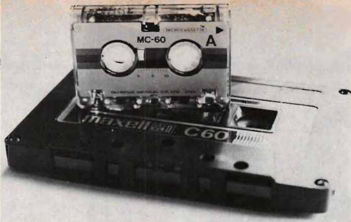
Fig 1. Den lilla mikroassetten innehåller hälften så långt band som den stora kompaktkassetten, men ger ändå lika lång speltid tack vare lägre bandhastighet. Själva bandet är dock lika brett och rymmer alltså i princip lika stora informationsmängd. Om man körde mikroassetten med normal kassetthastighet 4,75 cm/s, skulle man kunna åstadkomma en verkligt liten hi-fi-spelare. Vem nappar?
