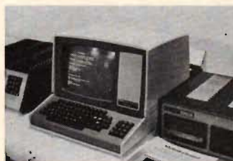
På senaste tiden har Heathkit presenterat flera datanyheter. Här ses WH 19 som är en intelligent dataterminal. Samma utseende har den kompletta datorn WH 89 som kan fås med inbyggd flexskivedrivare.
