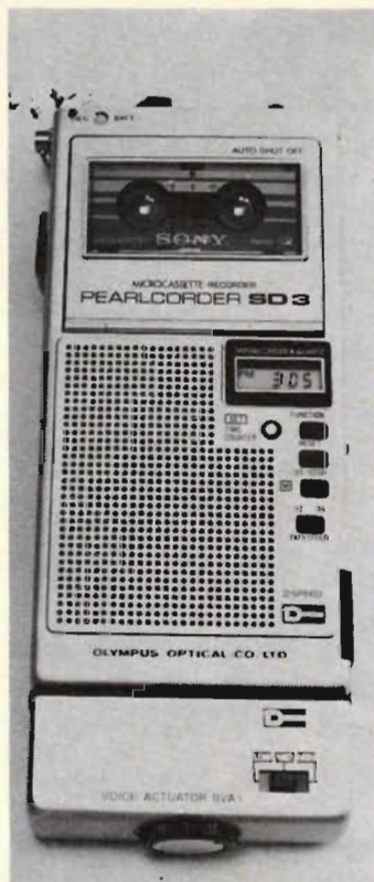
Fig 4. Här har vi anslutit en talstyrningsenhet, som startar bandet när något ljud hörs och håller den stilla när allt är tyst.
