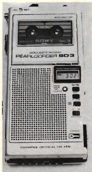
Fig 2. Olympus Pearlcorder SD3 är en liten, behändig och välutrustad dikteringsbandspelare. Det som skiljer den från andra är de små uttagen längst ner.
