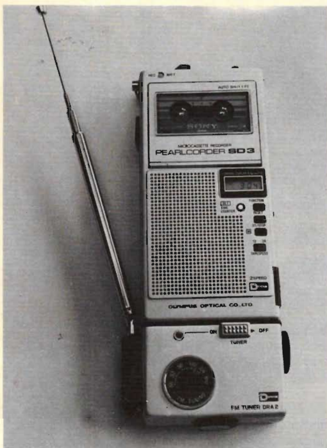
Fig 3. Till dem kan man ansluta olika tillbehör. Här är en fm-mottagare som förvandlar dikteringsapparaten till en radiorecorder.
