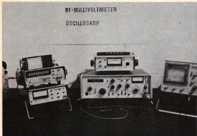
En mätstation för radiomateriel från Racal. Firman representeras numera av Saven AB i Vaxholm. Bilden visar syntesgenerator, millivoltmeter effektmotstånd med effektmeter, frekvensräknare och modulationsmeter.
