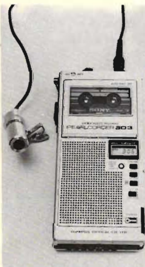
Fig 5. Man kan också ansluta en extra mikrofon för bättre upptagning i krävande situationer.
