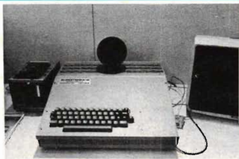
Fig 5. Enroterm-6 heter den här talande datorn som tillverkas av Euroka . En högtalare återgav det man skrev på tangentbordet.
