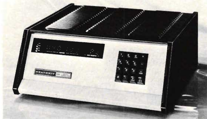
Fig 1. Heathkitsystemet H8/H9 bildar en högst användbar dator som är speciellt intressant i sådana applikationer där man behöver ha en flexibilitet i uppbyggnaden för att kunna ändra, bygga ut och anpassa utrustningen. Flexibiliteten får dock betalas med ett högre pris än för en färdigbyggd dator som dock kan vara för "färdig" och låst för en del applikationer.
