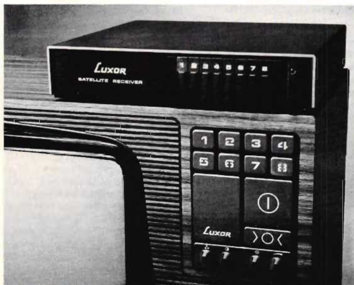
Fig 2. Större än så här är inte inomhusdelen av mottagningsanläggningen.
