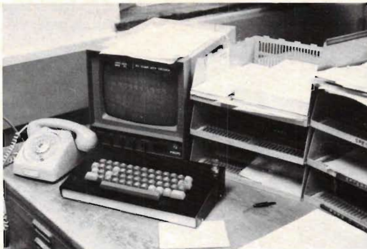
Fig 2. I Malmöinstallationen används datorn Altair 8800 medan de nya Newpacs-systemen är uppbyggda kring en dator som Frika Elektronik utvecklat.
