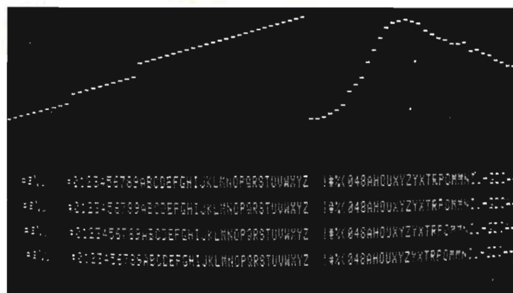
Fig 4. Det ges mycket små möjligheter till grafisk presentation på H9-terminalen. Ett speciellt läge, PLOT, ger emellertid denna presentation. Läget på varje streck i bildens överdel svarar mot ASCII-kodens numeriska värde för de tecken som visas i bildens underkant. Varför de tecknen måste visas fyra gånger är obekant.
