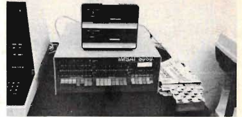
Fig 15. Micropolisdiskar kompletterar här en MSAI-dator i Hobby Datas monter.
