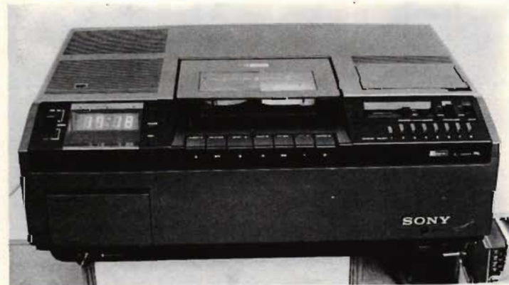
Beta-spelaren är utformad i gra plast i två nyanser. Maskinen är tung och stabil med metallbotten, vilket också krävs med den låga bandhastigheten man använder.
