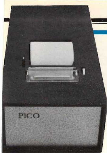
Fig 1. Kontrollenheten Pico sammanbyggd med tryckverk i låda.
