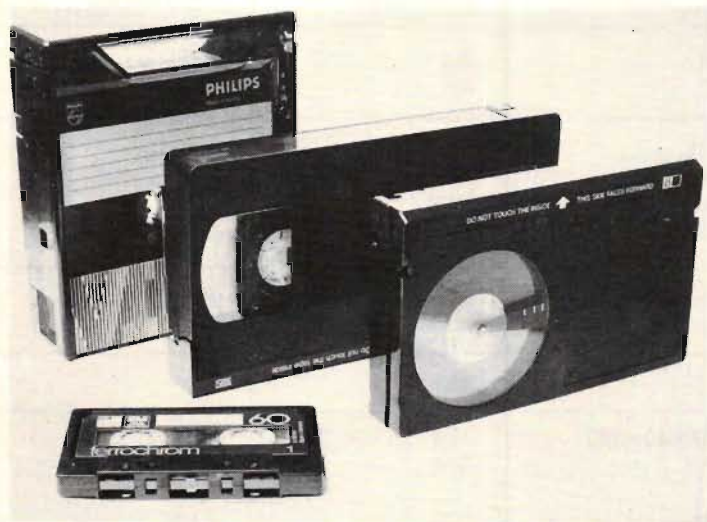
Här är de tre kassettsystem som finns hos videospelarna. Längst bak står Philips VCR-kassett som används också av Grundig i SVR-spelaren. Framför den står en VHS-kassett och längst fram en Beta-kassett. Som storleksmått har vi också lagt en vanlig kompaktkassett för ljud längst fram.
