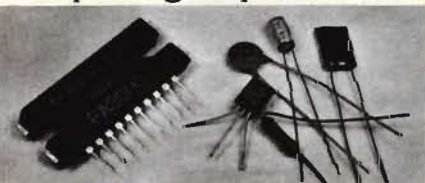
Somliga dämpar pilottonen med vanliga komponenter. Pioneer har utvecklat en speciell integrerad krets som tar bort den.
