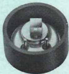
Fig 5. Den mycket lilla laserstrålealstraren av compoundtyp, aluminiumgalliumarsenid, i CD-spelaren. Bilden här förstord.
