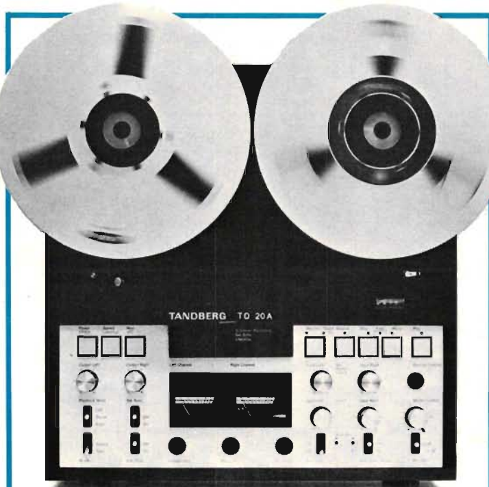
Fig 1. Bandspelaren är innesluten i en trälåda med metallfront. Bland reglagen kan vi särskilt nämna omkastaren för "Sel Sync" tv om utstyringshuvudet som avspelningshuvud. Därigenom kan man synkronisera spelarens båda kanaler med varandra för trickinspelningar.
