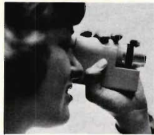
Fig 14. Ett litet, behändigt men effektivt hjälpmedel för en mörkerblockerad människa där bara centrum av synfältet fungerar och det kanske dåligt: Mörkerkikaren kan man ha i fickan eller handväskan och ta till vid behov, tex i en dåligt upplyst portgång, i en trappa o dyl. Med ett finger kan man reglera in den ganska vidvinkliga optikens fokus. Det är som att låta sig ledas av en stor tv-skärm fast mycket skarpare och tredimensionellare.
