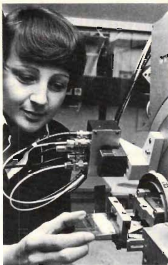
Fig 1. Hundra ggr snabbare än tidigare kan man nu utföra pulverdiffraktometri. De korta undersökningstiderna, 1–2 minuter, har uppnåtts med positionskänslig röntgendetektor, anpassad till Siemens diffraktometer D 500.
