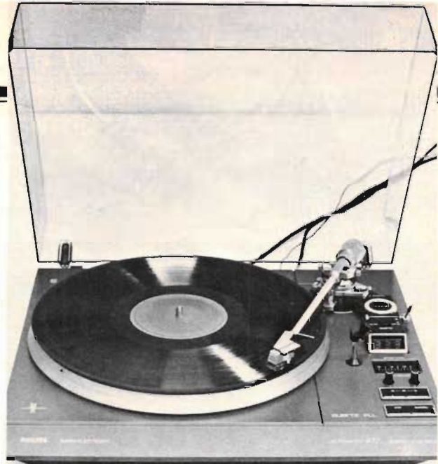
Rak tonarm och kvartsstyrt, remdrivet verk är de främsta kännetecknen hos AF 977. Som meddelande till omvärlden har spelaren dessutom texten "Philips Super Electronic Automatic 977 Direct Control" på fronten. Så nu vet vi det.
