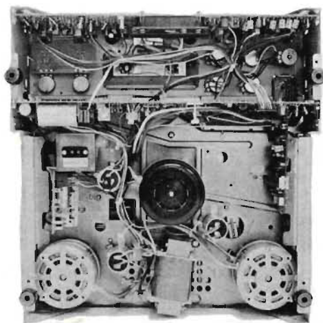
Fig 2. Innanmätet är luftigt med elektroniken samlad på två kretskort som här syns i överkanten, på kant mot betraktaren.
