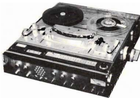
Fig 2. Nagra T1 är en mätbandspelare för fyra kanaler med åtta hastigheter fram- och baklänges. En ljudvariant av denna lär komma.
