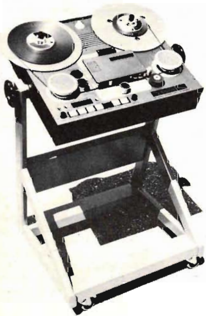
Fig 1. Stellavox TD88 i serieproducerat utförande. Bandspelaren har fem hastigheter.
