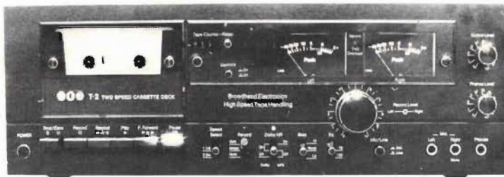
Fig 1. Sedvanlig japansk design fast med svart borstad aluminium utmärker BIC T2. Volymreglaget vid inspelning är centralt placerat under de två utstyringsinstrumenten. Tangenterna som sköter kassettsens rörelsetillstånd är mekaniskt direktverkande och något trögtryckta.
