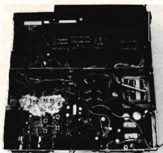
Fig 4. Lyfter vi på apparatladans övre plåtsvep ser vi två stora kretskort: Nederst mottagardelen och överst mikrodatordelen. Det mindre kortet överst i bilden bär upp kretsarna för kanalindikatorerna.
