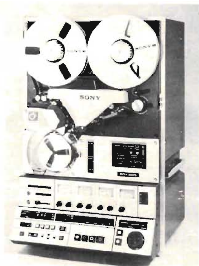
Fig 3. Sonys nya BVH-1100PS för C-formatet. Blå tillåter den slow motion baklänges utan bildstörningar.
