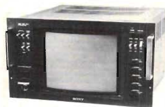
Fig 11. Denna monitor, BVM-1300 från Sony , har ett högupplösande trinitronrör
