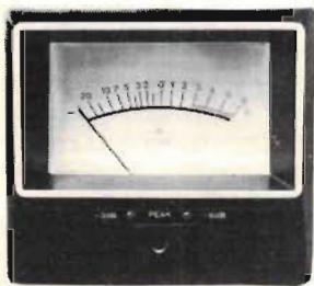
Fig 4. Utstyrningsinstrumenten är inte hänförande vackra att se på men fungerar i stället desto bättre. Genom omkoppling kan man välja att studera signalens toppvärde eller medelvärde.
