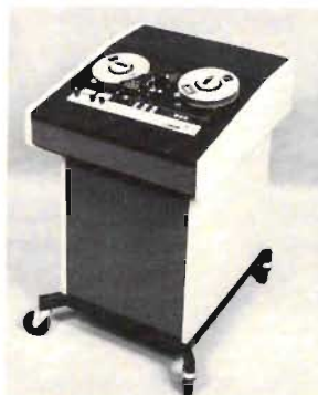
Fig 5. IVC 1-11 heter denna nya 1" maskin med IVC-format.
