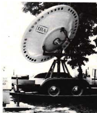
Fig 3. IBA- det engelska fristående tv-bolaget- ställde ut denna Ferrantitillverkade markstation som utnyttjar experimentsatelliten OTS. Detta är en ny lösning av problemet överföring från OB-buss till tv-studio.
