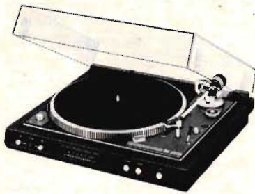
Fig 2. Dual har alltid varit ett stort märke i USA. Här är St. Georgenfirmans senaste, modell 731 Q som är en automatisk spelare med kvartsstyrd faslösning för direktdrivningen på motorkretsarna plus ett avstämbar anti-resonansfilter. ULM-tonarmen plus den speciellt gjorda Ortofon-pick upen ULM 60 E – en "Concorde" av den nya direktfattade typen – uppgår bara till 8 g. Det går bra också med standardstora pick uper. Kvartsoscillatorstyrningen medger upp till 11% tonhöjds kontroll. Belyst stroboskop ingår. Manöverpanelen delvis fram till. I övrigt de välkända Dual-dragen med inställbar repetition, automatstart och -stopp etc.
