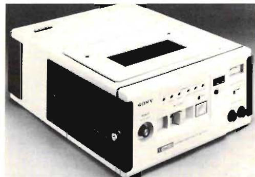
Fig 6. Denna portabla U-matic-bandspelare från Sony väger bara 5,6 kg!
