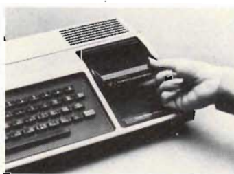
Fig 2. Programkassetterna sätts in i ett utrymme till höger om tangentbordet. I närbild framgår också att tangenterna har ett avlångt format som även det skiljer sig från standard på området.
