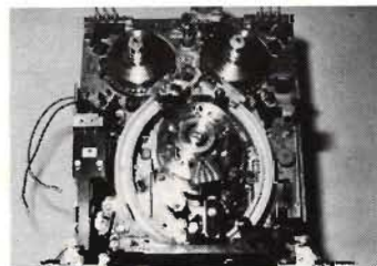
Fig 7. Laddningsmekanismen i VR2020. Kassetten läggs i upptill på bilden och den roterande videotrumman ligger centralt i bilden.
