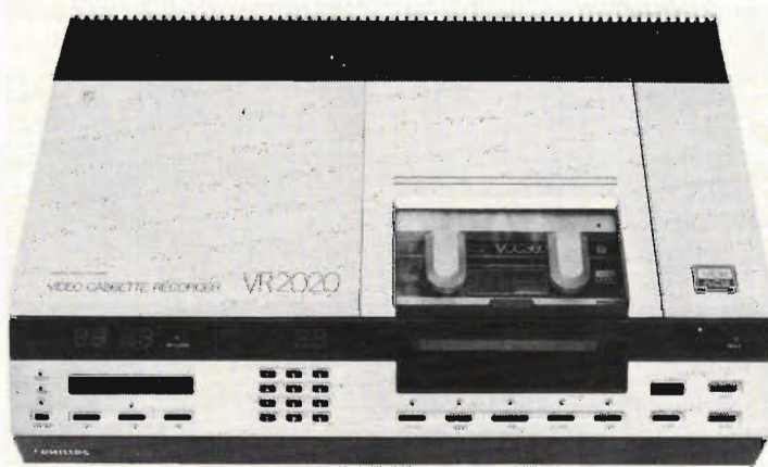
Fig 1. Spelaren VR2020, som är den första i Philips nya system Video 2000. Den har elektronisk styrning av alla funktioner. En mikroprocessor ingår även för effektiv kontroll.
