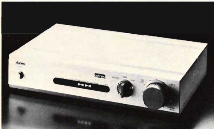
Fig 2. Det nya brusreduktionssystemet adres finns endast som separat enhet. Det arbetar med nivåberoende diskantshöjning/sänkning och en fast kompression/expansion på 1,5 gånger.
