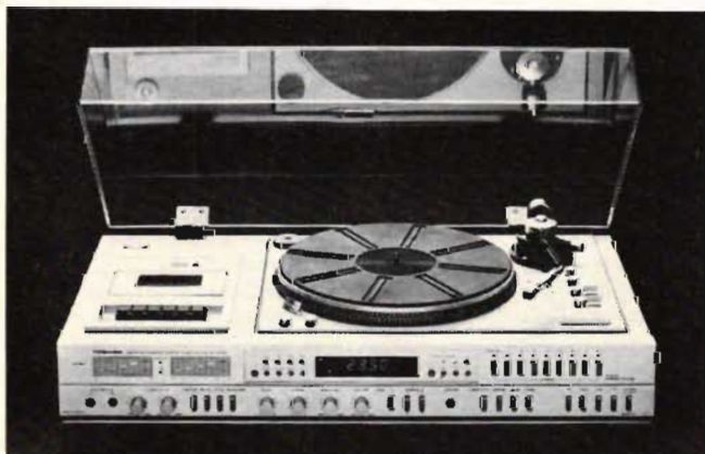
Fig 3. Musikanläggning SM-4750 har digital syntesavstämning på alla våglängdsband: Lång-, mellan-, kort- och fm-ultrakortvåg.
