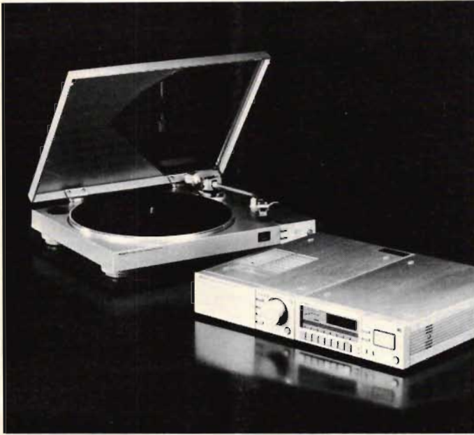
Fig 2. Mini-grejorna är oftast verkligen läckra och mycket välgjorda, men kanske för dyra ännu så länge. De slog inte särskilt väl ut på CES. Här är Sonys PS-P7X direktdrivna skivspelare med BSL-motor för jämn kraftansättning och minimum "kuggning". Kvartsstyrning. Den lilla men 50 W mäktiga stärkaren som heter TA-P7F har Sonys termodynamiska kylning med sk heat pipe-avledning. Pulsat nätaggregat och en krets konstruktion som sägs vara transientkonande... ingen tim. Bredvid ligger tunern ST-P7J av syntestyp. Ingen avstämning med instrument, allt ligger som digitalindikering i mitten med fluorescensdisplay. Tunern stegar digitalt fram i bandet med 0,1 MHz inkrement.
