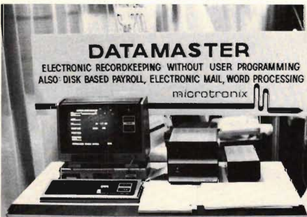
Fig 3. Datamasters är en sammanställning av Radio Shack, dator, micropolis flexskivenhet och programvara.
