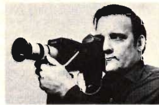
Fig 2. En prototyp till en färg-kamera med ccd-element från RCA. Den skall ge en vanlig färg-tv-signal ut och skall kunna börja säljas i slutet av 1979, enligt uppgift.
