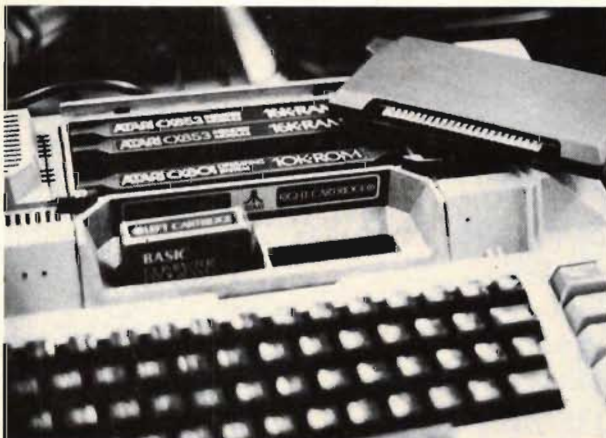
Fig 2. I Atari 800 finns plats för två ROM-kassetter.
