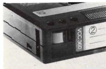
Fig 9. Kassetten har tre kod-hål som kan ange bandlängd, eventuell typ av band (tex metallband) osv. Endast bandlängden är tv kodad. Under kodningen sitter en infällbar inspelningsspärr som används om man vill förhindra radering av ett band. Spärrningen kan hävas genom att man för spärren åt sidan.
