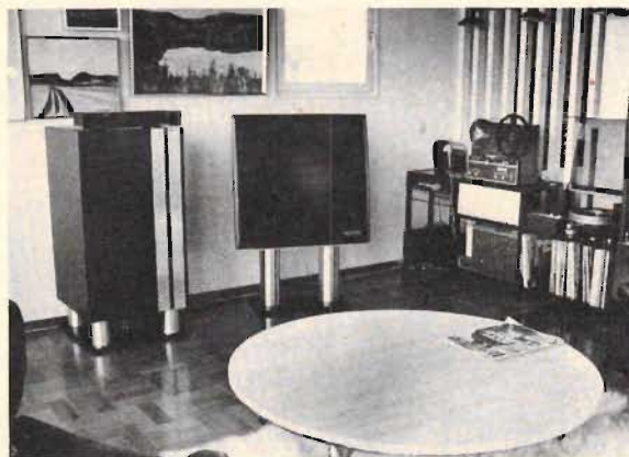
Fig 7. En av de anläggningar som använts för att prova ut bashögtalarna visas här. Till vänster ser vi 220 l lådan och som sidosystem används Dalqvist-högtalare. Det är en mycket god kombination! Man bör lägga delningsfrekvensen mellan 50 och 100 Hz för 220 l lådan. Läger man den för högt kommer stående vågor att göra sig gällande.
