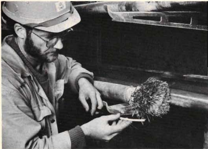
Fig 1. Den fiberoptiska kabel som mannen på bilden håller i, överför 6x480 kanaler. Den ordinarie kabeln bakom, överför 280 kanaler. Fördelarna vid installationen är uppenbara!
