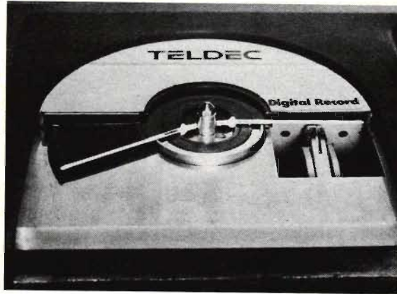
Fig 4. Bilderna visar kassetten med sin skiva. En magnet håller skivan på plats vid avspelingen.
