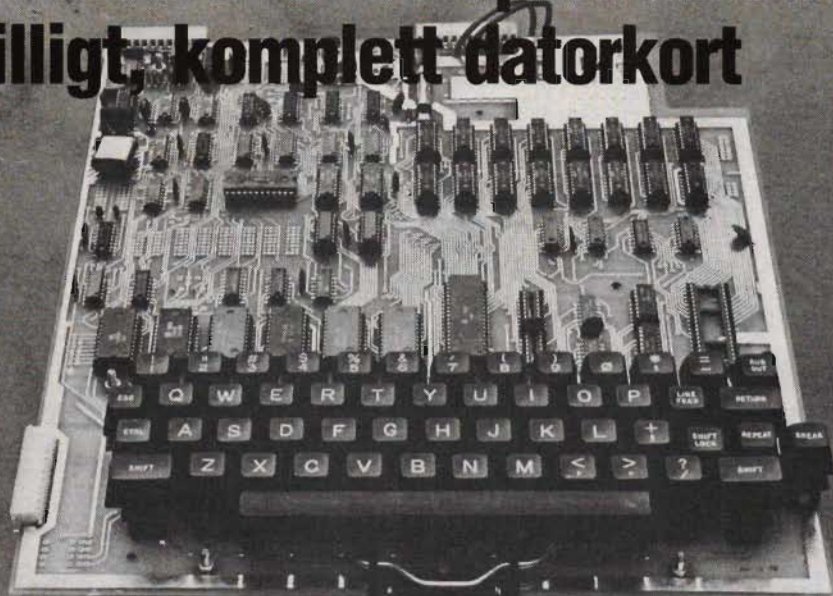
Fig 1. Det kompletta datorkortet. Fullständigt tangentbord, basic i läsminne, videokretsar och kretsar för lagring på audiokasset ingår.
