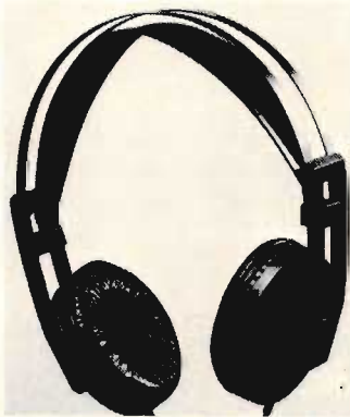
Fig 8. Yamaha har uppmärksammat en hel del för den nya hörteltelefonvarianten som heter YH-100, liksom det dyra YH-1000 ett s k ortodynamiskt system, lite högre prissatt än den populära YH-1. Här har talspolen fotoetsats över membranytan, vilket ger fördelar i form av mycket jämn verkan.
