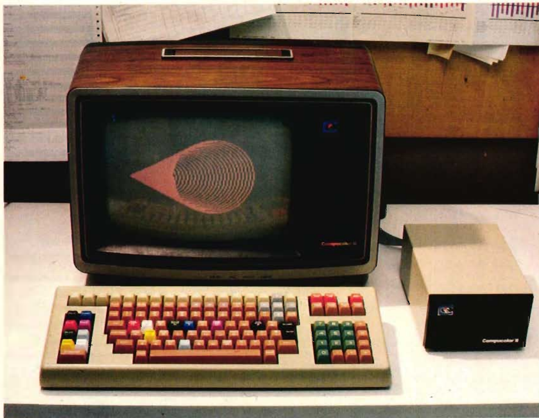
▲ Fig 1. Compucolor II består av två delar; bildskärm med flexskiva och tangentbord. Här har vi dessutom en yttre flexskiva inkopplad. Inte bara på skärmen finns det färg. I tangentbordet är också somliga tangenter färgkodade och de kan användas för styrning av skärmens utseende. För styrning av skärmen från basic används särskilda kommandon.
