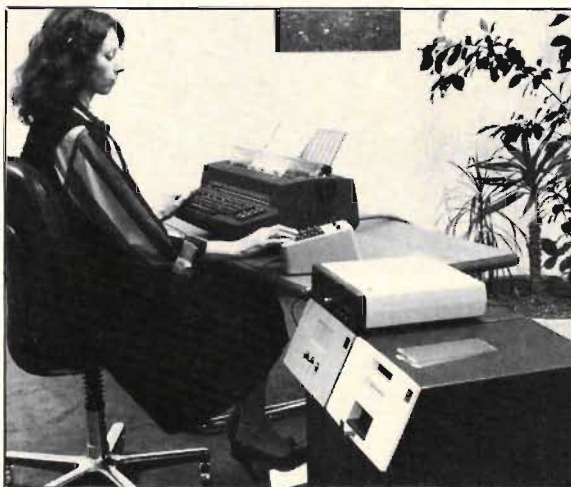
Fig 2. "Den talande skrivmaskinsutrustningen" består av en IBM skrivmaskin, ett separat tastatur och en fristående datorenhet.
