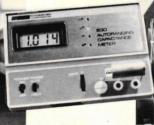
Fig 4. BK, nu representerat av Elit, tillverkar den här lilla kapacitansmätaren. Presentationen av kapacitansvärdet sker som synes digitalt och områdesomkopplingen sker helt automatiskt.
