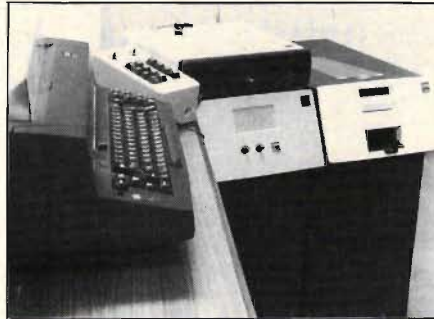
Fig 2. "Den talande skrivmaskinsutrustningen" består av en IBM skrivmaskin, ett separat tastatur och en fristående datorenhet.
