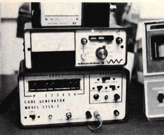
Fig 3. Saven säljer många instrument som lämpar sig för service på kommunikationsradio. Bland dem finns, på bilden, Sinadder 3, som används vid SINAD-mätningar (känslighet m m). Under den ser vi en generator som ger 5-ställig tonkod för kontroll av exempelvis selektivavrop.
