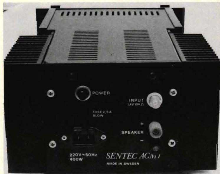
På baksidan ser vi polskruvar för högtalaren, BNC-kontakten för ingången, nätanslutning, nåtsäkring och strömbrytare som av brum-skål hamnat här.
