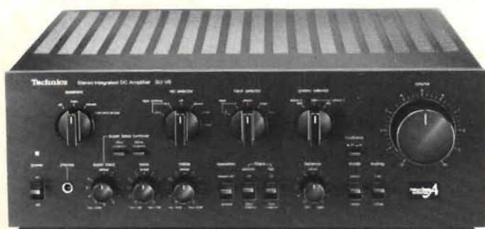
SU-V8. INTEGRERAD FÖRSTÄRKARE 2 × 105 W IEC. Uppbyggd enligt nya klass A. Extremt låg distorsion -0,007% THD vid full uteffekt. Två separata spänningsaggregat undanröjer all påverkan mellan höger och vänster kanal. Kompakt effektblock med minimala anslutningsavstånd till andra kretsar. Ren DC-koppling - förbikopplingsbara tonkontroller. Ingång för MC-pickup. Separat bandspelareomkopplare för samtidig lyssning/bandning av olika programkällor. Extra tonkontroll för superbass kompenserar bastoner som annars inte skulle höras. Ca pris 3.000:--
