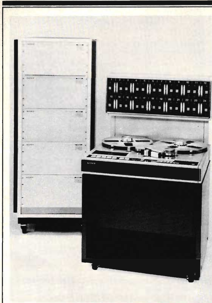
Fig 2. Sonys 24-kanaliga pcm 3324 digitala bandmaskin har sedan senast fått lite nättare dimensioner med flera funktioner överförda till stativet som syns i bakgrunden. Bli tittade SR:s - Riksradios och TV-bolagets - folk intresserade på den här under AES-expon i New York i höstas, men något köp blir det inte, har RT fått besked om. Primärt vill Riksradiion hellre ha en 2-kanalig pcm-enhet som man använder ihop med en U-Matic. SR har hittills inte kunnat studera digitalinspelningstekniken i egen regi då man saknar sådan apparatur, vilken dock blir allt vanligare hos radio- och gramfonföretagen ute i världen.
