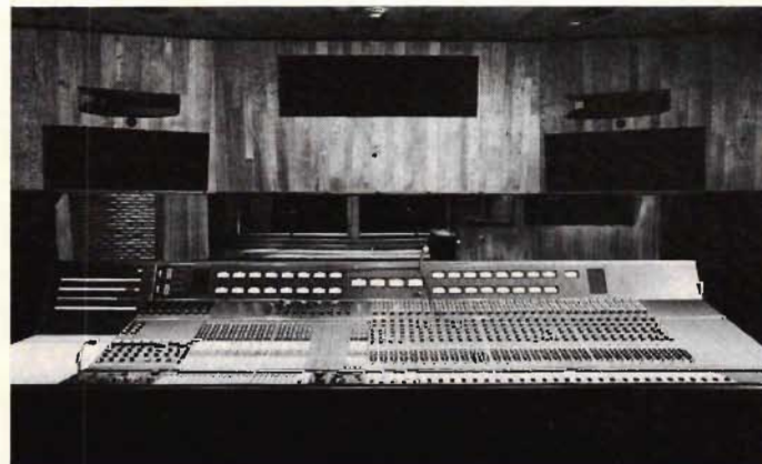
Fig 4. Del av kontrollrummet intill Studio 1 med mixerbordet och kontrollhögtalarna, arrangerade på typiskt Hidley-sätt.
