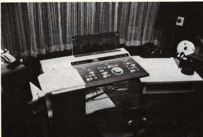
Fig 8. Något som ytterst få av världens grammofonstudior ännu har - en digital redigeringsenhet för mångkanalbruk. Vid RT:s besök gästades CBS-Sony av amerikanskt branschfolk som tog del av nyheterna.
