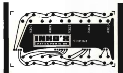
Fig 6. Mönsterkort för reglagen till fk-variatorn i 40% av naturlig storlek.
