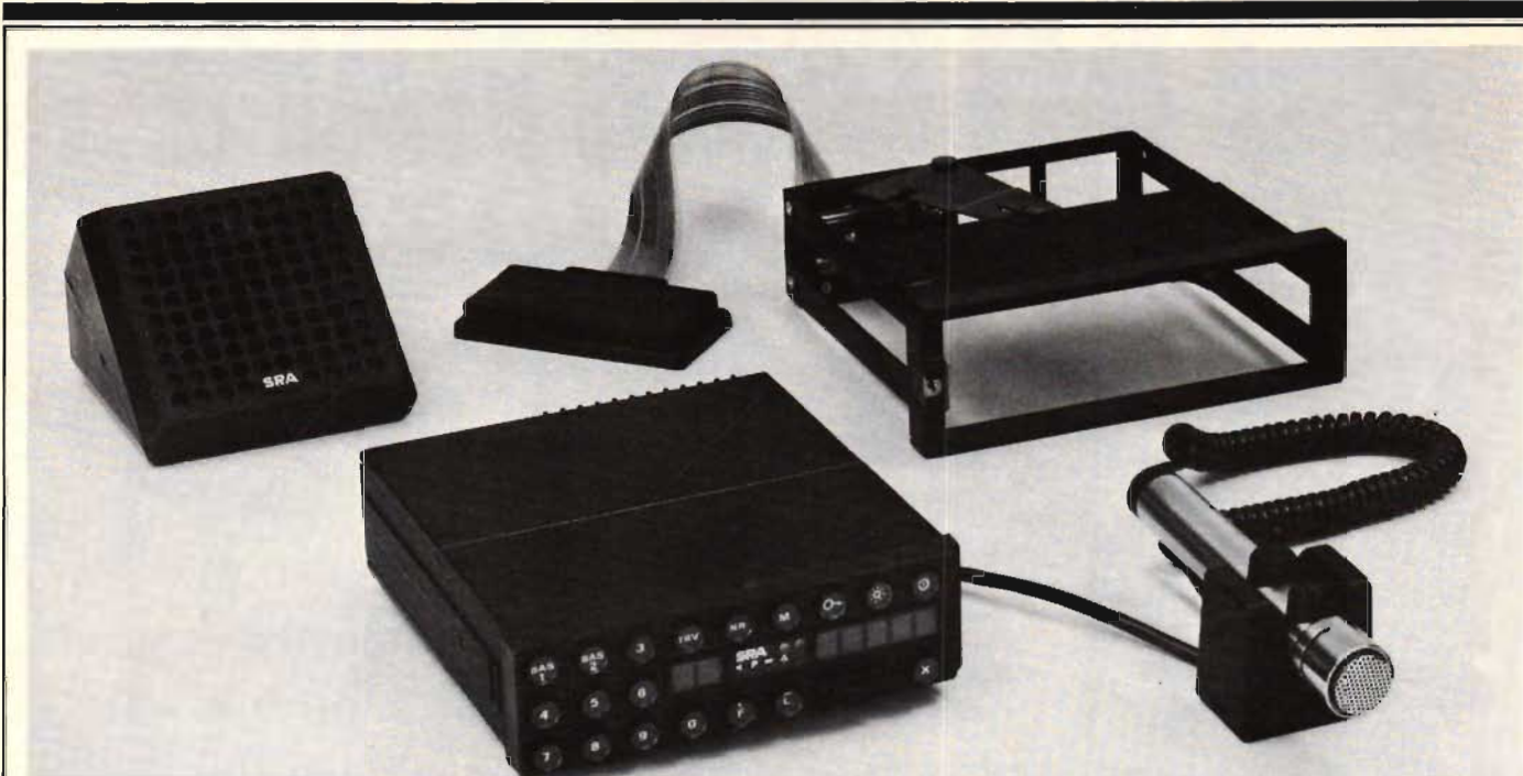
Fig 1. En radiostation i 600-serien med tillhörande bilkassett, högtalare och mikrofon. Som framgår har panelen inga vred, utan enbart tryckknappar för olika funktioner. På mikrofonen finns sändningsknapp och en potentiometer för ljudvolymen i mottagarläge.
