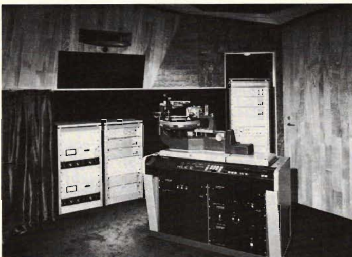
Fig 7. "Mastering room" i komplexet eller graveringsstudion med Neumann-utrustning, kompletterad med Discomputern och Sonys egen kristallstyrda servo-verkenhet.
