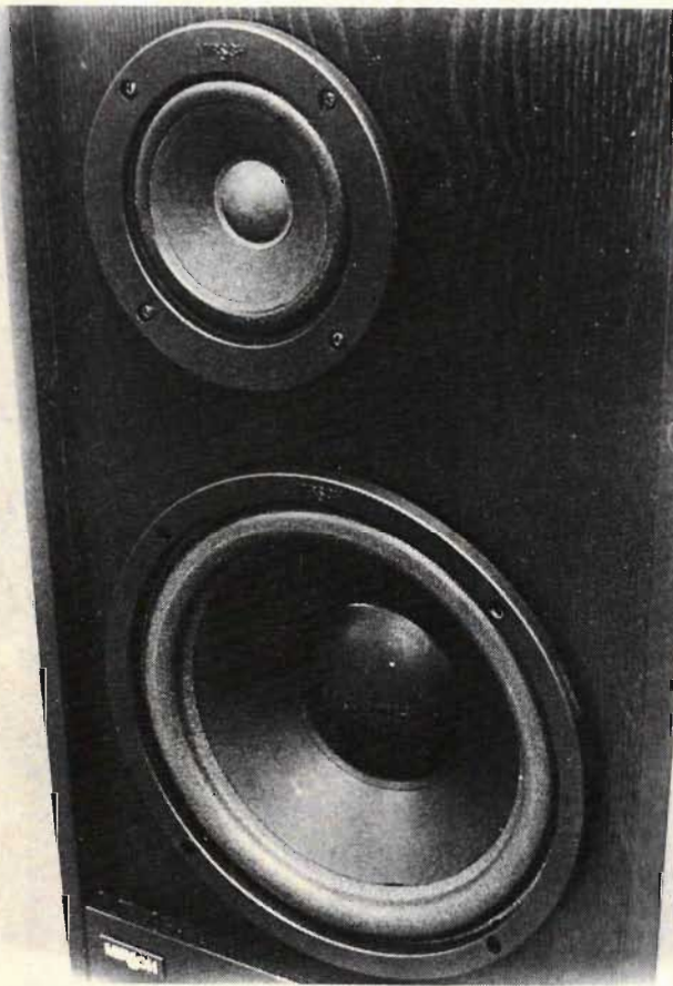
Fig 2. De specialbeställda högtalarelementen är samlade i fronten - minus diskanten, förstås - och solitt infästa i baffeln, som ligger försänkt. Elementen är lätta att skruva ur och lossa framifrån, en serviceunderlättande detalj.
