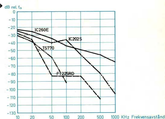
Fig 14. 10 kHz från bärvågfrekvensen skall inte några nyckelknäppar ge sig till känna. I princip skall signalen bara breddas några 100 Hz vid normala nycklingshastigheter. De här visade störningarna är så starka att stationerna är olagliga att användas som de är! Nycklingsfilter eller ombyggnad måste till. Bara IC 251 E hade godtagbar nyckling.
