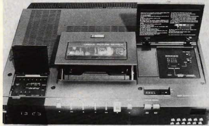
◀ Fig 2. Inprogrammering av tider och frekvenser sker under de skyddande lock som här är öppna. Tidmaskinen sköts från vänstra panelen och mottagaren från den högra. För inställning av mottagaren har man två metoder att välja på. Antingen kan man låta maskinen programmera knapparna framtill, alltså kanalväljarna, helt själv. Den sveper då genom hela frekvensområdet och tilldelar de olika frekvenserna över knapparna i den ordning signaler påträffas. Somliga knappar kommer då att ge svaga, brusiga och ointressanta kanaler, men man behöver inte själv bry sig om frekvenser etc. Det systemet är snarast tänkt för områden med fler kanaler än våra två. Som alternativ kan man också svepa manuellt och lagra de funna och utvalda mottagningsfrekvenserna på önskad knapp.
