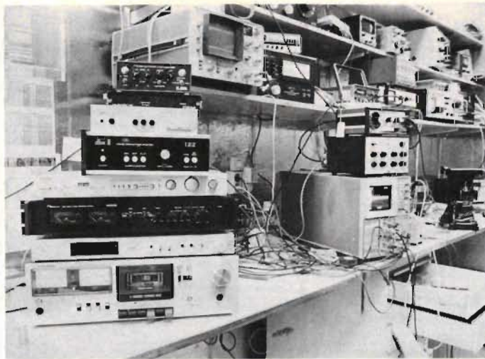
Hela stapeln med provobjekt i RT:s lab. Mätningarna kunde vara rätt besvärliga att utföra på grund av den stora dynamik systemen ger ut. Vi kunde bli inte ha alla systemen i gång samtidigt, eftersom deras nådelar kunde inducera brum i intilliggande apparat!
