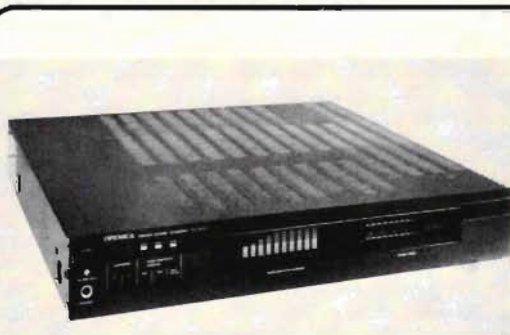
2. Optonicas nya slanka 2x100-wattare SX-9305 med fet-förstärkeri i dc-koppling med dubbla fet, ingångssteg i kaskodad differential etc. Intressant är ett nytt kylpaket som arbetar med gas och flytande medium som värmeavledare. Färgade lysdiod-rampen ger nivåbesked; där jämte en 3-färgs "audio spektrum analysator".
