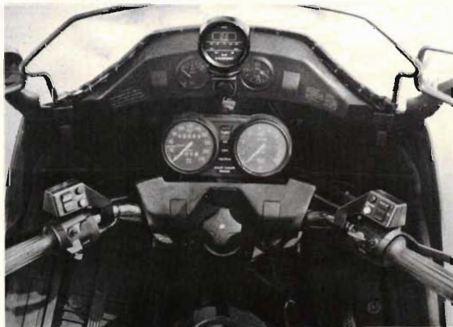
Fig 3. Även till motorcyklar finns radio att tillgå. Anläggningen på bilden tillverkas av Blaupunkt och omfattar såväl fm-rundradio som privatradiosändare/mottagare. I centrum syns indikatorn för frekvens, privatradiokanal och kontrollampor för olika funktioner i systemet. Manövreringen sker med reglagen vid styrstångens båda handtag.
