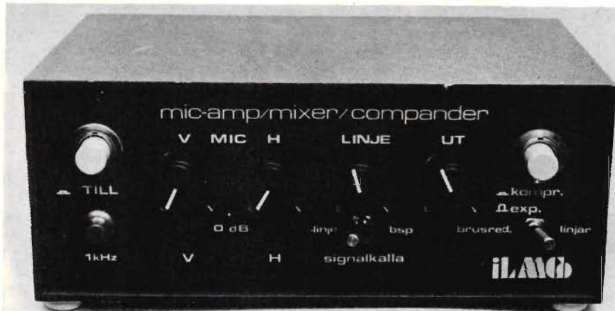
Fig 1. I en liten behändig låda kombineras här funktionerna högklassig mikrofonförstärkare med mixbar linjeingång och komponder för inspelning och avspelning. Det hela drivs med uppladdningsbara batterier. Utrustningen är alltså högst mobil men kan också drivas med ett yttre nättaggregat, vilket tillika fungerar som laddningsaggregat.
