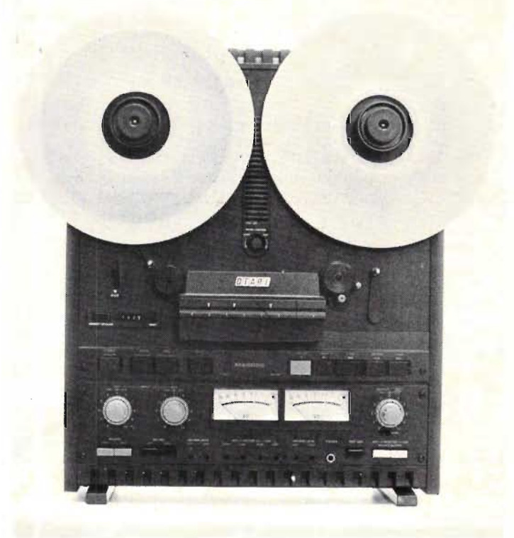
Fig 1. Otari MX 5050 är en mycket hög spelare. Tyngden ligger dock så fördelad att den ändå står stadigt om man vill arbeta med den i upprätt läge. Hela fronten ligger i ungefär samma plan, vilket gör god åtkomst av huvudena vid rengöring och redigering. Locket ovanpå huvudsatsen med skarvdon går lätt att fälla upp på gångjärn.
