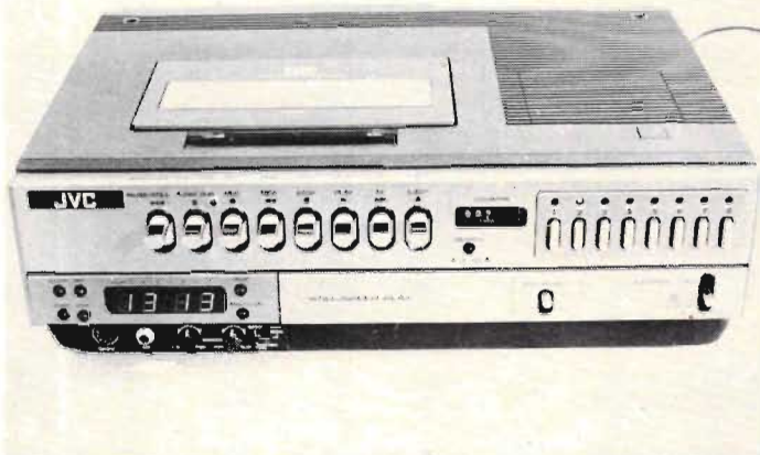
Fig 1. JVC 3660 med programverk för en vecka, avspelning med dubbel hastighet och oförändrad tonhöjd, slow motion m.m. Maskinen har ärvt mycket av sin föregångare 3300, bla de små tangenterna th för kanalinställning. De är mycket lätta att trycka in, även av misstag. Vi har flera gånger råkat ut för att missa inspelade program på grund av att någon oavsikligt tryckt ned en önskad tangent!
