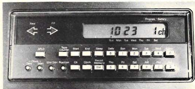
Fig 4. Här är tangentbordet till mikrodatorn hos Sharp 6300. Pilarna upp tv lyser rött under respektive snabbspolning. Med tangenterna ställer man klockan, räkneverket, tiduret, programsökningen, kanalväljaren etc.
