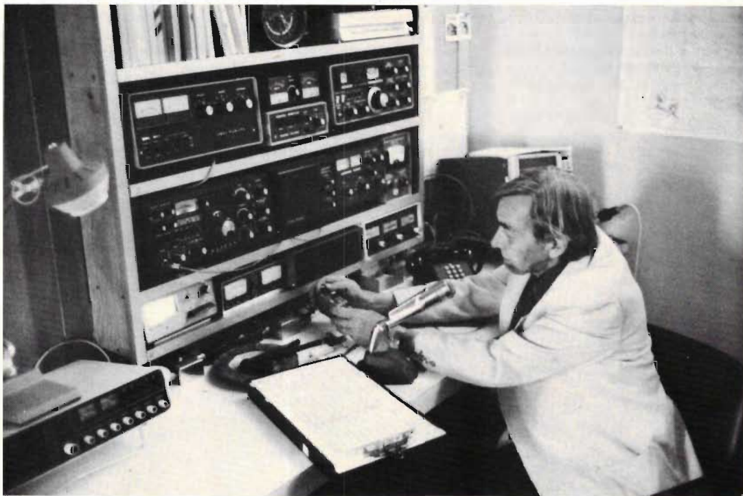
Fig 3. Nej, det är inte AX-processorn som Curt Knoppel pekar på här under en paus i trafiken: AX-kretsarna ligger i den lilla skärmade burk som skyttar alldeles bakom och t h om den bordsstativfästa mikrofonen framför honom.
