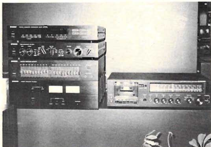
2. Den här stereostapeln från Tatung är typisk för de nya audioprodukterna från Taiwan som rycker fram nu. Fr v syns uppifrån am-fm tryckknappsstyrd digitaltuner, stereo-förförstärkare, 10-bands fk-variator, slutsteg och th kassettdäck jämte receiver.
