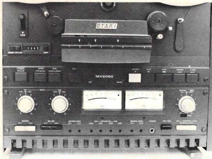
Fig 2. I manöverpanelen ingår åtkomliga inställningar för inspelningskorrektur, inspelningsnivå och förmagnetisering. Räkneverket är tyvärr inte tidvisande, men väl försedd med automatstopp vid 0000 under snabbspolning.
