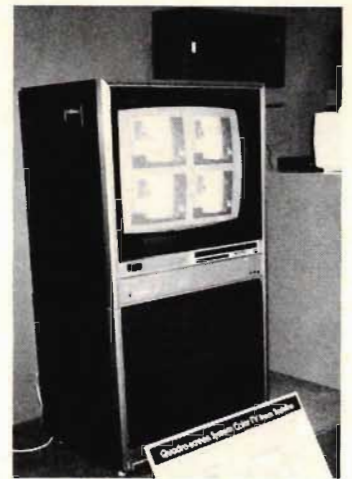
4. Man kan se upp till fyra program i färg på den här 63,5 cm Toshiba tv-monitorn – varje program på 25 cm-rör eller två på de små skärmarna 1h i bilden med hälften av ett tredje på den fulla bildrörstorleken, alternativt två i form av en liten bild nere 1h plus en fullstor bild på resten av det stora röret, eller slutligen en enda 25-tums bild. Mottagaren sköts med trådlös fjärrkontroll.
