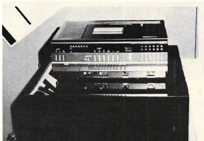
3. Videospelaren från Toshiba av lättvikstyp använder 300 kanaler på en liten videobandkassett. Modell L-10 S ger två timmars speltid med farten 5,5 m/s.
