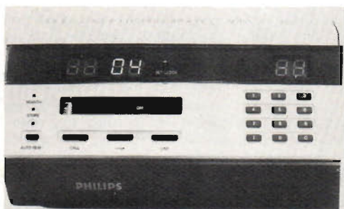
Fig 7. Vid programmeringen av tidverket hjälper mikroprocessorn till. Man försätter maskinen i programmeringsmod genom att trycka ned CALL-tangenten. Då tänds texten START i fönstret och operatören skall slå in önskad starttid. På det sättet går man igenom hela proceduren med nya uppmaningar från tablån tills verket är fullbordat.
