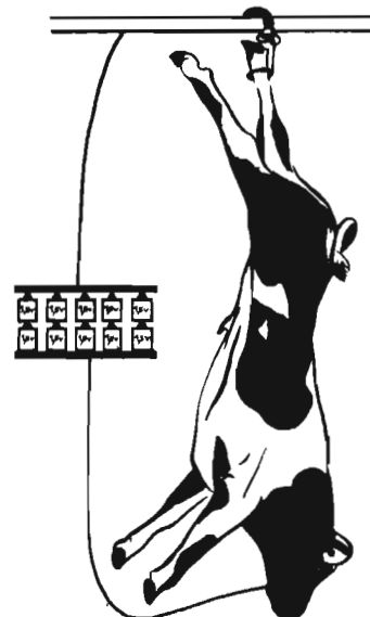
Fig 2. Principskiss för impulsbehandlingen. I praktiken används dock ett flertal elektroder i ryggmuskulaturen.
