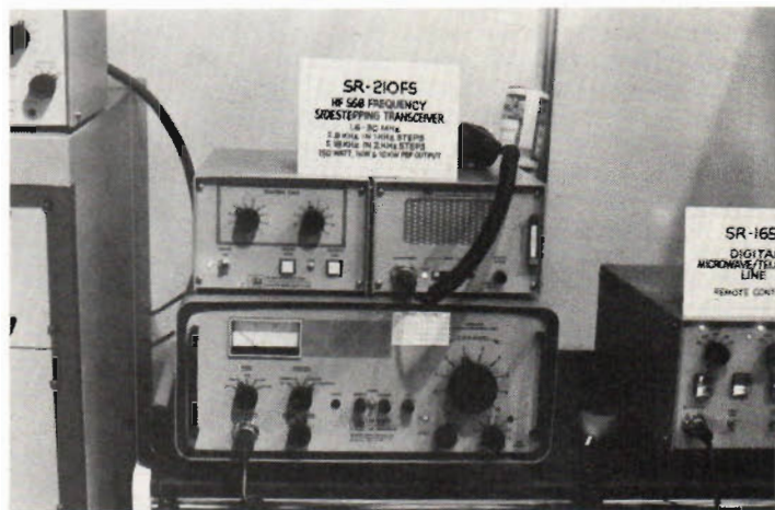
Fig 7. Scientific Radio Systems, USA, tillverkar kortvågstransceivern på bilden. Den täcker 1,6-30 MHz, ger 150 W "barfota" uteffekt på 10 fasta kanaler. Kanalerna kan dock justeras \pm 9 kHz i 1 kHz steg och \pm 18 kHz i 2 kHz steg. SR tillverkar även passande slutsteg för 1 och 10 kW.
