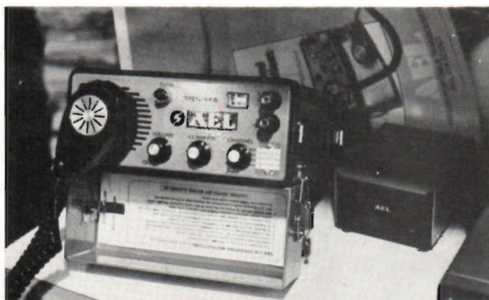
Fig 6. AEL Scout 11A är en liten, mobil transceiver för ssb-kommunikation.
