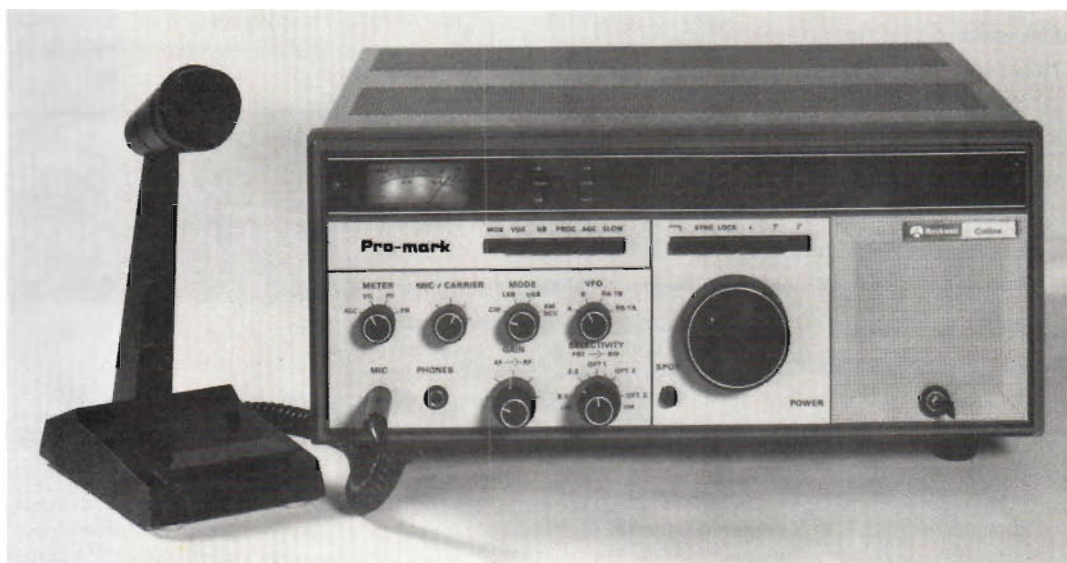
Fig 1. Collins HF-380 är en fullständigt halvledarbestyckad transceiver för 0,5-30 MHz vid mottagning och 1,6-30 MHz vid sändning. Den mikroprocessorstyrda syntesapparaten saknar, som framgår av bilden, bandomkopplare. All avstämning sker med en ratt.
