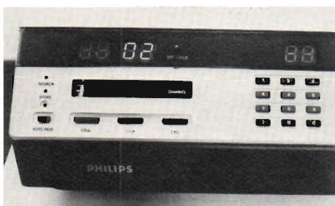
Fig 7. Vid programmeringen av tidverket hjälper mikroprocessorn till. Man försätter maskinen i programmeringsmod genom att trycka ned CALL-tangenten. Då tänds texten START i fönstret och operatören skall slå in önskad starttid. På det sättet går man igenom hela proceduren med nya uppmaningar från tablån tills verket är fullbordat.
