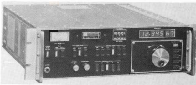
Fig 17. En "lågprismottagare" från Watkins Johnson. Modellen på bilden, WJ-8718, täcker 5 kHz till 30 MHz.
