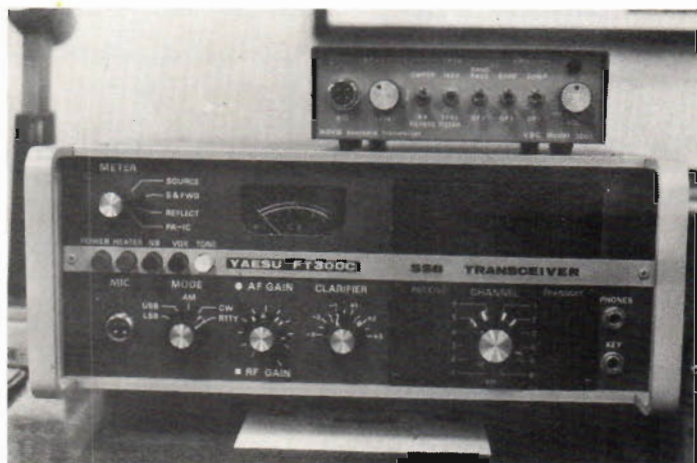
Fig 11. Namnet Yaesu förknippar väl de flesta med amatörradiomateriel, men apparaten på bilden, FT300C, är avsedd för professionellt bruk. Stationen har 10 fasta kanaler.
