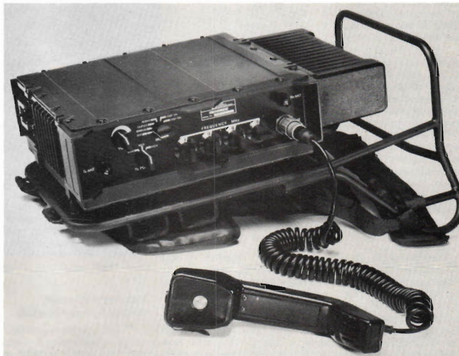
Fig 13. Groundsat från Plessey. Transceivern är unik genom att den erbjuder samtidig sändning och mottagning på en frekvens. Konstruktionen har fått utmärkelsen "Design Council Award". An så länge tillverkas bara en militär version, men Plessey antyder att principen kan komma att tillämpas även i civila apparater.
