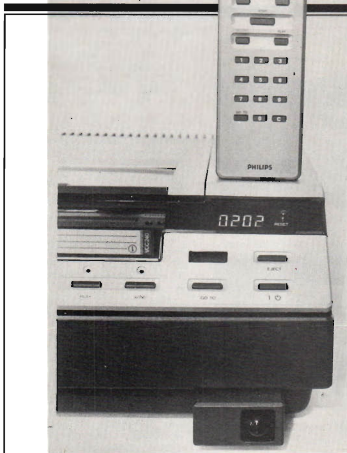
Fig 8. Med fjärrkontrolltillsatsen kan man styra alla funktioner hos spelaren. Det mottagande elementet placeras på spelarens framsida och övrig elektronik i en burk för sig på baksidan.
