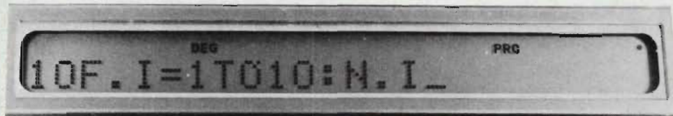
▲ Fig 3. Basic-instruktionerna kan skrivas på vanligt sätt från tangentbordet. Om man vill kan man emellertid förkorta de kommandon man tycker är långa. Förkortade kommandon avslutas med punkt vid inskrivningen -
