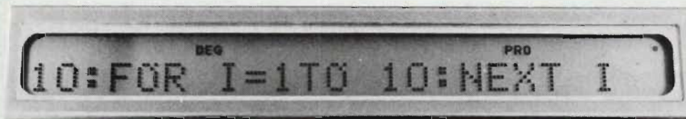
Fig 4. - och datorn fyller på till läsbar text sedan ENTER-tangenten tryckts ned. Ett vettigt system som tillåter användaren att välja mellan att skriva kommandon som han eventuellt är van vid eller ta hjälp av maskinen där det känns bättre. ▼
