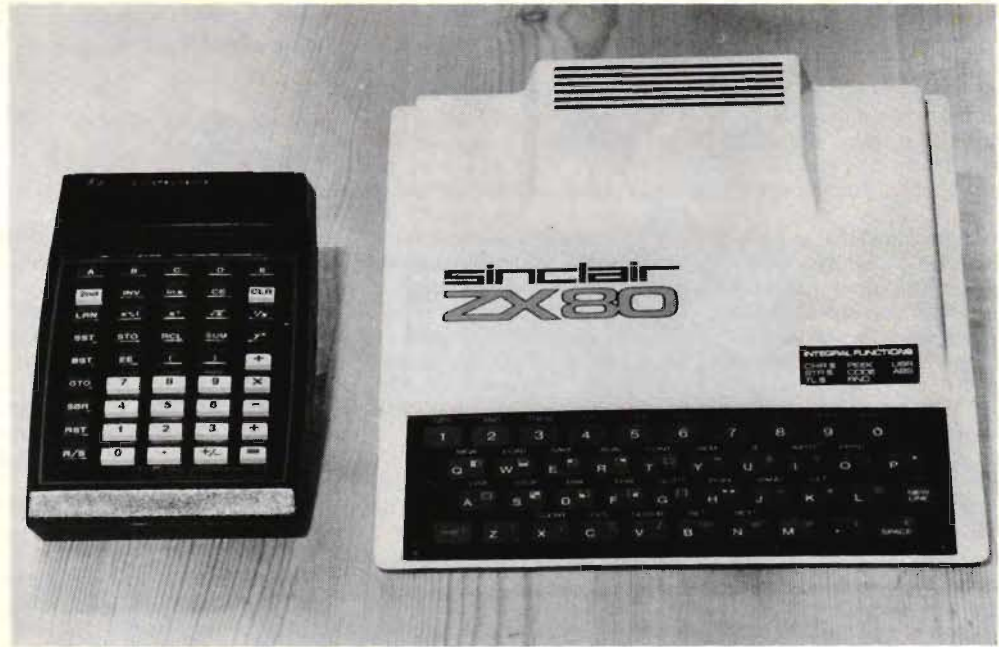
▲ Fig 1. Så här liten är ZX80 jämfört med Texas Instruments räknedosa TI 59. Tangentbordet blir alltså mycket litet. Tangenterna består av kontaktpunkter under en flexibel plastfilm.
