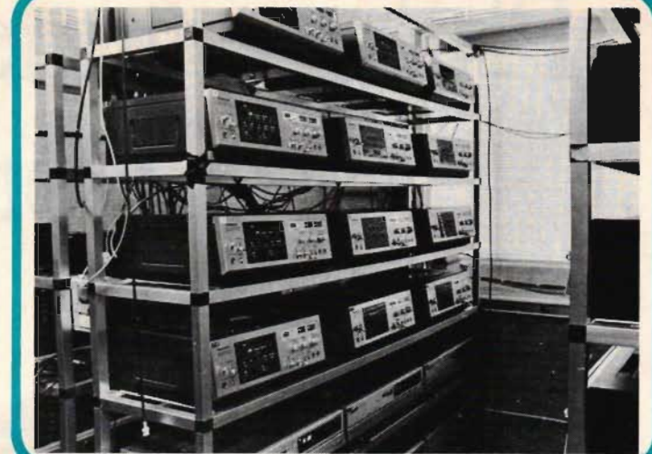
Videosignalen fördelas ut till ett stort antal kassetmaskiner som spelar in kopierna. F n använder man ca 70 VHS-maskiner och ca 50 Beta. Här står överst i hyllan ett antal Panasonic NV 8200 och under dem NV 7000.
