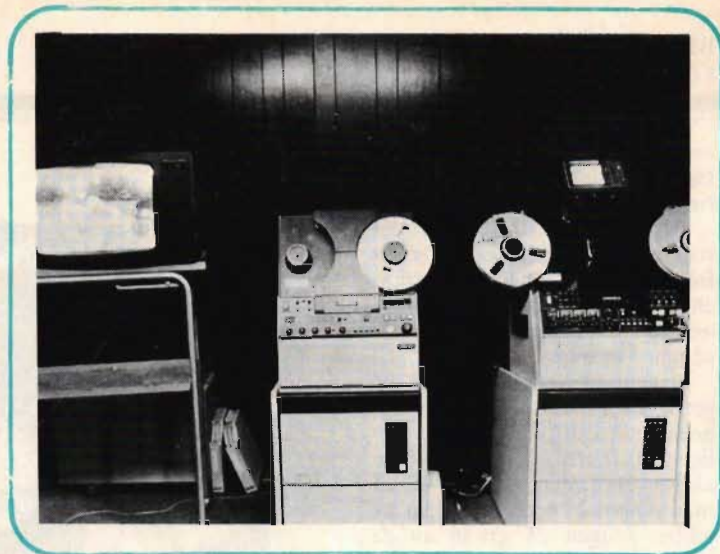
Det vanligaste originalformatet vid kopieringen är 1 tums video. I höst har man installerat två nya Ampex VPR-2 för det ändamålet hos Frekvensia.
