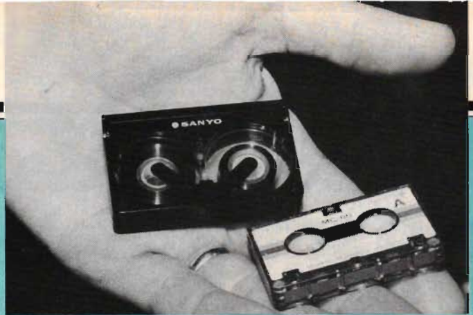
Kassetten som används i Sanyos utrustning har ungefär samma storlek som en mikrokassett för ljud. Speltiden är 20 minuter, och storlek och speltid är därmed mycket lika Sonys Video Movie.
