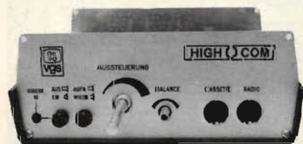
Fig 6. En nästan färdig enhet. Här återstår bara monteringen av rattarna, locket och trimningen. Den bör man vara noga med för att få ett gott resultat. Annars blir följsamheten mellan in- och avspelning dålig.
