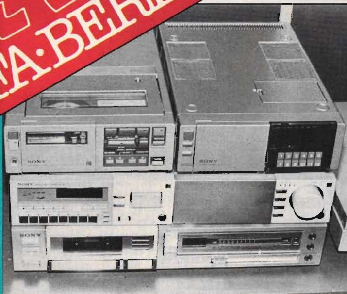
Liten stapel från Sony. Apparaten längst upp till vänster är en videospelare, SL V1. Dimensionerna är de minsta vi sett på någon 1/2 tums videospelare. Storleken är ungefär som ett A4-ark med tjockleken 8 cm. Till höger om spelaren en passande tuner och programverk. Undertill ligger dels en syntestuner för fm-stereo, dels en effektförstärkare. Längst ned ett mycket flackt kassettdäck med en höjd som bara överstiger den stående kassetten med 5 mm.
