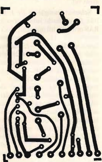
Fig 16. Mönsterkortets komponentsida för digitaltermometern.
