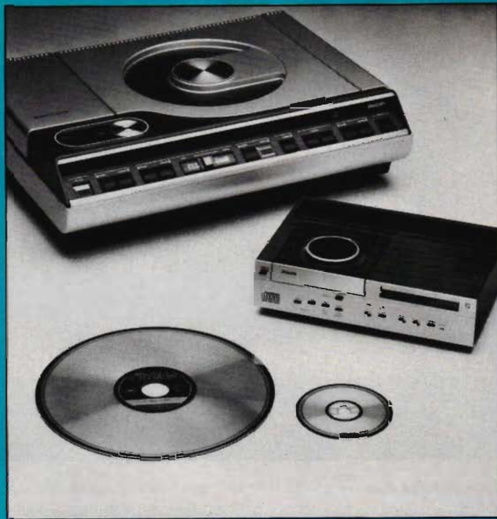
Philips trycker hårt på att det är samma system som används i Laser Vision, videoskivan, som Compact Disc, digitalskivan. Både apparat och skiva blir dock mindre om man "bara" skall lagra och återge ljud.
