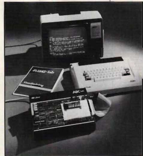
Fig 3. ABC-lab är en tillsats till datorer som tillverkas av Liber Teknik . Tillsatsen använder man för att låta datorn styra diverse utrustningar eller för att ta in data. Kort sagt utgör ABC-lab den felande länken mellan datorn och omvärlden. Utrustningen säljs tillsammans med en handledning i lämpliga laborationer. Fig 4. Mikro datorn Piccolo från Scanips Data .
