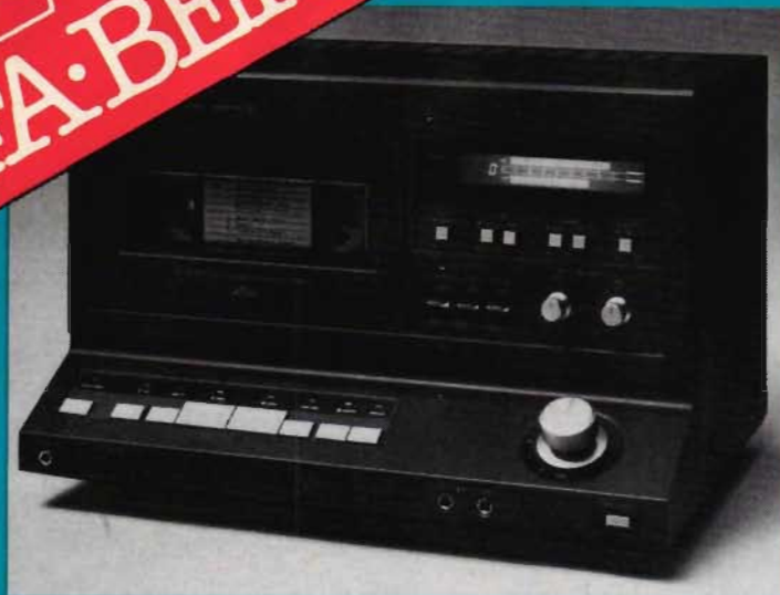
Digitalt ljud på videokassett är däremot kommersiellt tillgängligt. Här en specialbyggd spelare från Technics som innehåller både bandspelare och digitalomvandlare.
