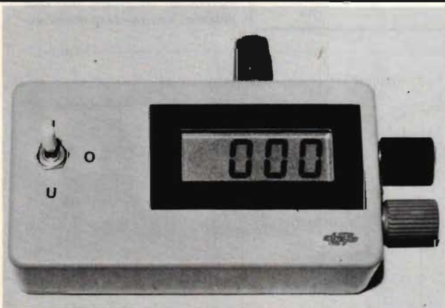
Fig 9. Rc-instrumentet byggs in i lämplig låda.
