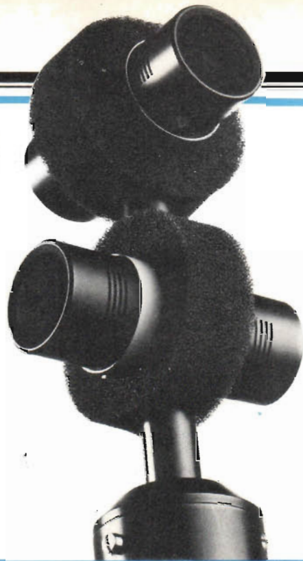
Fig 1. Den originellt formade nykomlingen från MB-Peerless i Tyskland har två friliggande individuellt vridbara upptagningsssystem, där upptagningsmönstret naturligtvis dels kan varieras, dels medger variabel öppning mot det ljudfält som skall täckas in. Principerna bakom gör miken lika lämpad för stereofoni som för sk kvadronfoni, enligt tillverkaren.
