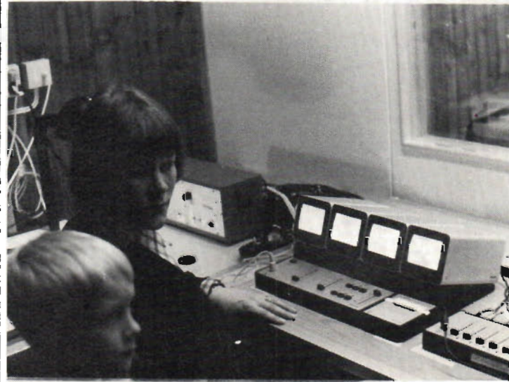
Interiör från kontrollrummet i när-tv-studion i Flemingsbergskyrkan. Vi ser här video- och ljudmixer samt i bakgrunden tv textkameran.
