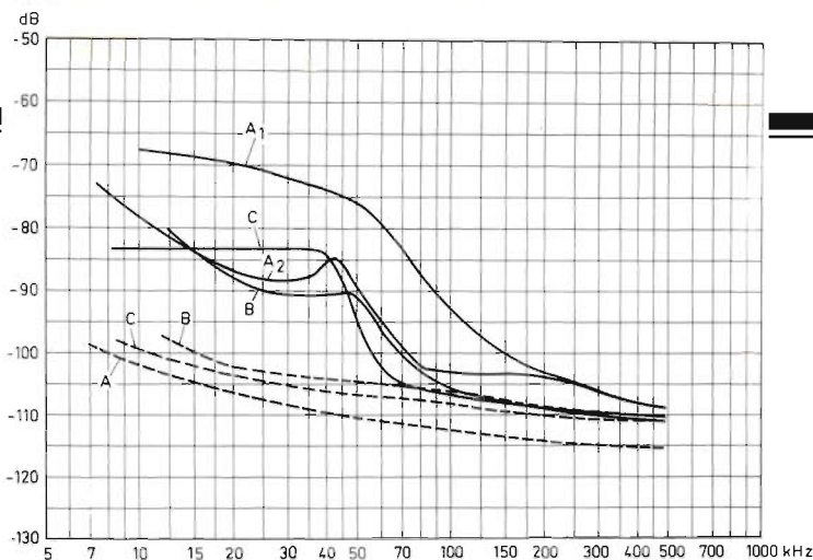
Fig 1. Sidbandsbruset vid olika frekvensavstånd från mittfrekvensen. Det visar här för tre olika stationer av senare tillverkning. De streckade kurvorna visar bruset från stationerna efter ombyggnad. Förbättringarna ger mycket mindre störutstrålning från sändaren.
