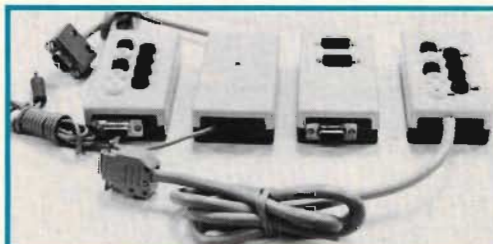
◀ Fig 1. De här tillbehören till ABC80 saluför och tillverkar Lasse Data . Här finns bl a V24 -anslutning med polerna utdragna till lättåtkomliga bananpluggar. Vi ser även en demodulator för telegrafi och fjärrskrift ( CW/RTTY ).
