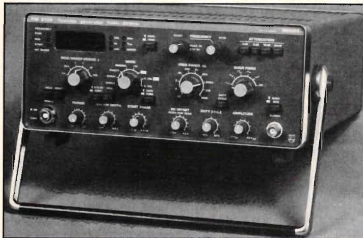
Fig 3. PM 5134 är en annan funktionsgenerator som täcker 1 mHz till 20 MHz. Den kan frekvenslåsas till en kristall samt amplitud- eller frekvensmoduleras, och den ger hög utspänning.
