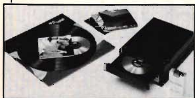
Fig 19. Philips och Sony har nu bilagt de sista meningsskiljaktigheterna kring Compact Disc och gemensamt har man slutfört " betydande förbättringar" på främst modulationssystemet och felkorrektionen. Data är nu 60 min speltid i stereo, spårindelning 1,6 mikrometer, skivdiameter 120 mm precis, skivtjocklek 1,2 mm, kvantisering 16 bitars linjär per kanal, samplingsfrekvens 44,1 kHz och felkorrektion CIRC (Cross Interleave Reed Code) och modulation EFM (8-14-modulation). Här ses Sonys förslag till spelare med skivenheten upptill som i en byrålåda, vilken skjuts in i spelaren.
