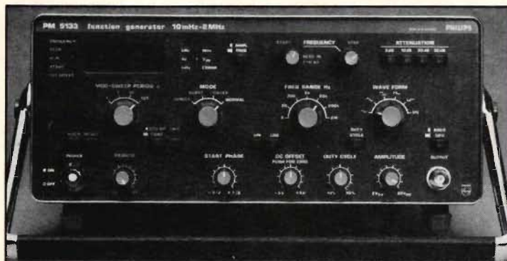
Fig 2. Funktionsgeneratören PM 5133 har sinus-, fyrkant- och triangelvåg samt pulsfrekvenser från 10 mHz till 2 MHz. Det logaritmiska svepet täcker mer än fyra dekader.
