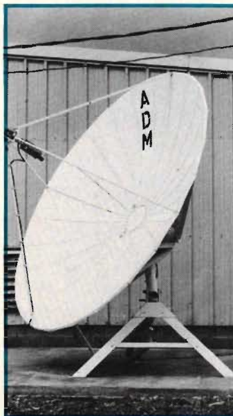
En 5 meters parabolantenn för 4 GHz. En sådan antenn kostar ca 2 500 amerikanska dollar.
