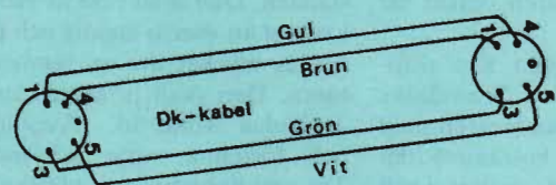
Fig 2. Så här kopplas den kabel som förbinder lärarens och elevens enheter vid dubbelkommando.
