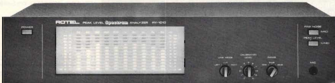
RY 1010. Spektralanalysator för kontroll av FK-variatorns inställning. Mätmikrofon medföljer. Analysatorn innehåller även brusoscillator. Ca pris: 2.400:–
