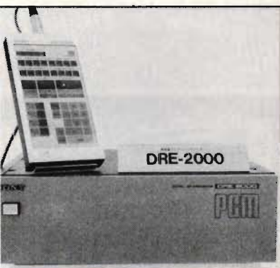
Fig 14. Sonys pcm-program utökas varje år nu med nya digitalenheter. Här tillskottet DRE-2000, som är en digital efterklangsenhet med tillhörande tablå för inprogrammering av fördröjning, karaktär, etc.
