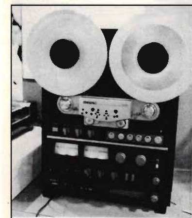
Fig 15. Sony är inte minst analogbandsspelare också, och här ses fabrikatets största modell i TC-serien med alla finesser, inklusive den under hemlighetsmakeri utvecklade egna brusreduktionsenheten som sitter längst ner. Med de här specialtillsatserna håller to m kassettdäcken på att få data som överträffar digitalmaskineriets, som någon lite ironiskt framhöll i Tokyo. Det går ju att få över 100 dB brusfrihet – men det skall helst låta bra också.
