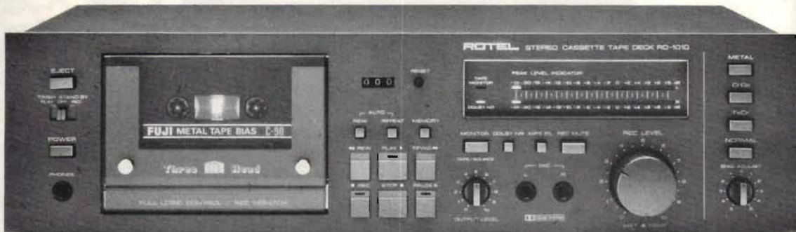
RD 1010. Relästyrt kassettdäck med tre tonhuvuden (sendust), för samtliga bandtyper. Svaj: 0,045% (WRMS). Signal/brusförhållande (Dolby): 64 dB. Frekvensomfång (metallband): 30–19.000 Hz \pm 3 dB. Ca pris: 2.400:–
