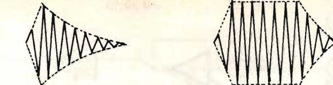
Fig 2. Typiska signalformer från slaginstrument tv och stråk- eller blåsinstrument th. Skillnaden består här i att de senare instrumenten ger en fas under vilken tonens nivå hålls konstant.
