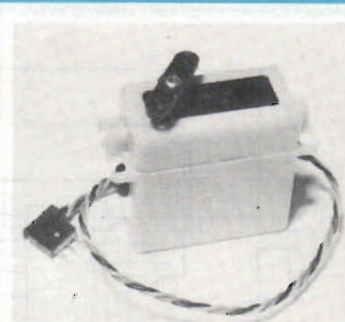
Fig 6. Det färdiga servot.
