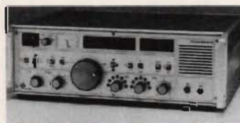
Telefunken E1700 täcker 10 kHz - 30 MHz med mycket goda prestanda.
