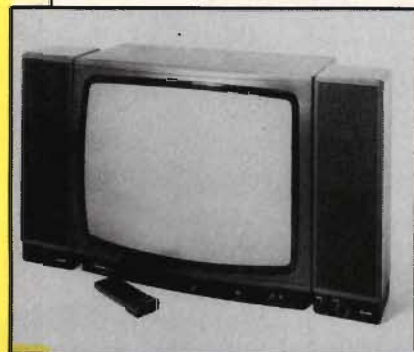
▲ Denna Luxor-tv är hjärtat i ett helt audiovideo-system. I grundutförandet ingår två slutsteg men ingen högtalare. Genom att komplettera med en eller två högtalare kan man få vanligt ljud resp möjlighet till stereo, när sådana sändningar blir aktuella. Med två högtalare kan man också få simu-
