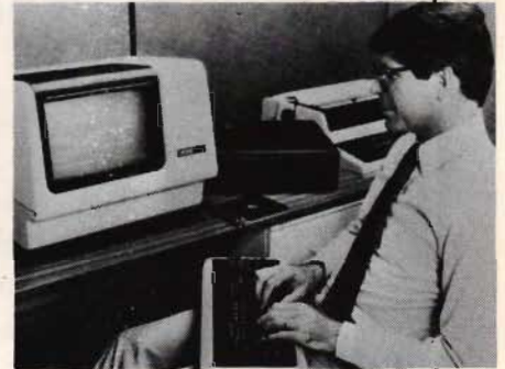
Digital Equipments terminal, VT 100, kan nu kompletteras till ett smådatörsystem med CP/M som diskoperativsystem. Skrivare och dubbel flexskivminne ingår.
