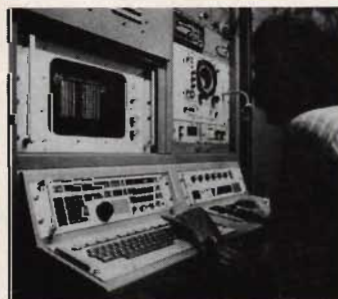
Telefunken 1800 i en typisk miljö: Systemet på bilden är gjort för övervakning. Mottagaren styrs helt av en dator men kan även skötas manuellt.
