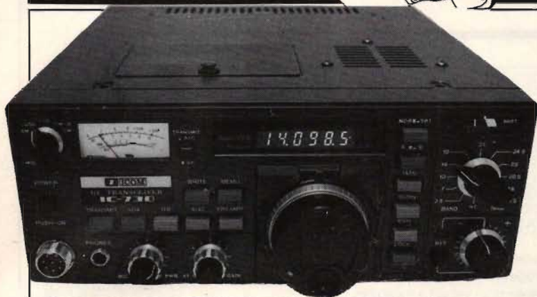
Fig 1. Den är liten IC 730, bara 241 × 94 × 275 mm, men ger trots det över 100 W ut.
