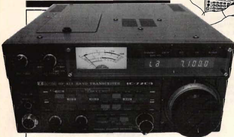
Fig 1. Sändaren/mottagaren IC 720A mäter bara 31×24×11 cm, väger 7,5 kg och ger över 100 W ut.
