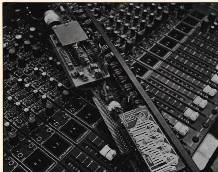
Midas mixer för pa-bruk. Lagg märke till hur omsorgsfullt man isolerat alla anslutningar till vippomkopplare och övriga panelkomponenter.
