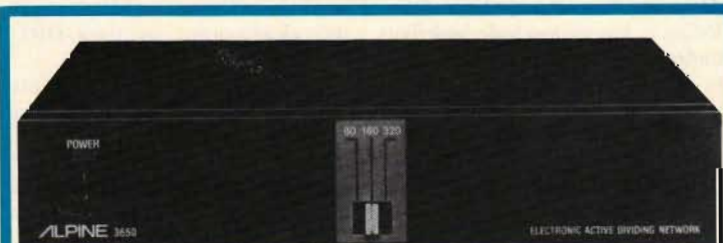
Ett aktivt delningsfilter för bilstereo: Här är Alpine Electronics modell 3650 elektroniska filter som omfattar en frekvensväljare, en tvåvägs reglermöjlighet för 12 dB fall per oktav, en omkopplare för frekvensstufaldigande, koppling för fjärrstyrning, DIN-kontakter(!) och en switch för ingångsreglering. S/n uppges till 100 dB (IHF), brytfrekvenser 80, 160, 320, 1 600, 3 200 och 6 400 Hz. Frekvensområdet 10 Hz – 50 kHz inom 3 dB avvikelse med 0,02 % klirr, enligt data.
