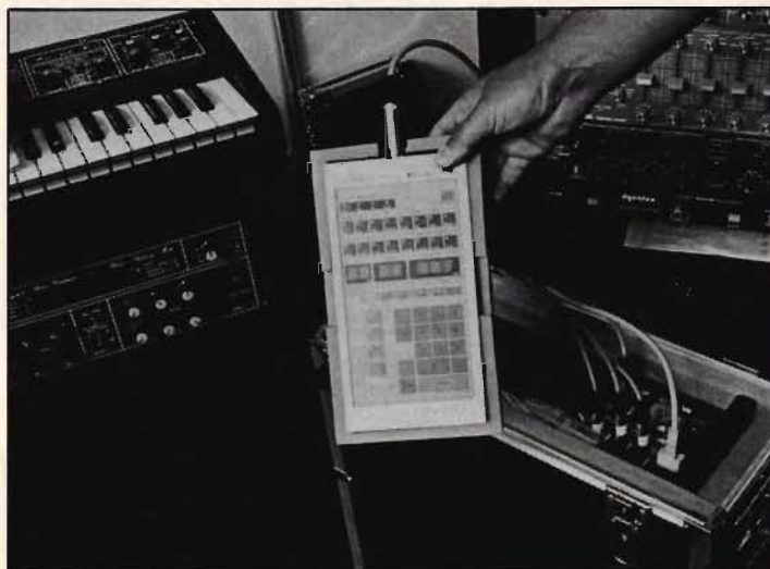
Sonys digitala för­dröjningsenhet DRE-2000 med sin originella fjärrstyr­ningspanel i för­grunden. Den är helt slät och borde motstå flertalet av de i studiomiljön förekommande vät­skorna.
