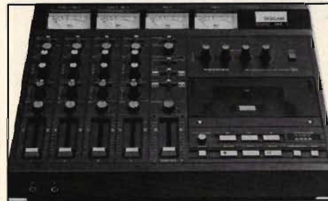
Teac/Tascams version av detta med musikerbandspelare och privatflerspår ser ut så här. Likheterna med Fostex är slående. Modellen heter 244. Här tillgår man dock dbx-brusreduktion.
