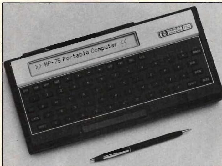
Fig 2. HP 75C är liten men har trots det samma basic som i 80-seriens maskiner.
