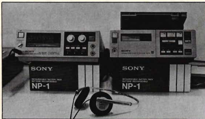
Sonys digitalljuddillsats för videobandspelare ses här tillsammans med en videobandspelare från samma firma. NP-1, som nyheten heter, är även av intresse för t ex Televerket, som provar den för överföring av ljud över tv-länkar.
