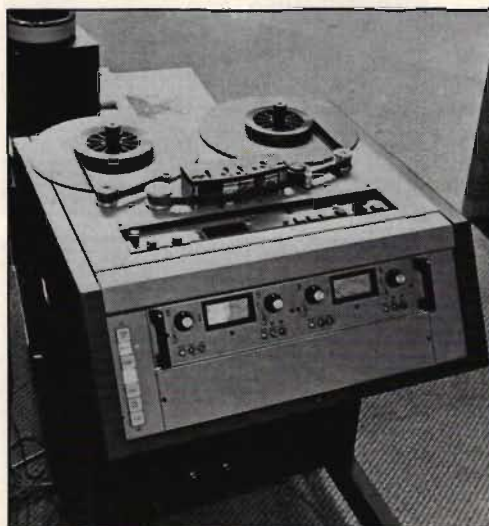
Sonys digitala för­dröjningsenhet DRE-2000 med sin originella fjärrstyr­ningspanel i för­grunden. Den är helt slät och borde motstå flertalet av de i studiomiljön förekommande vät­skorna.
