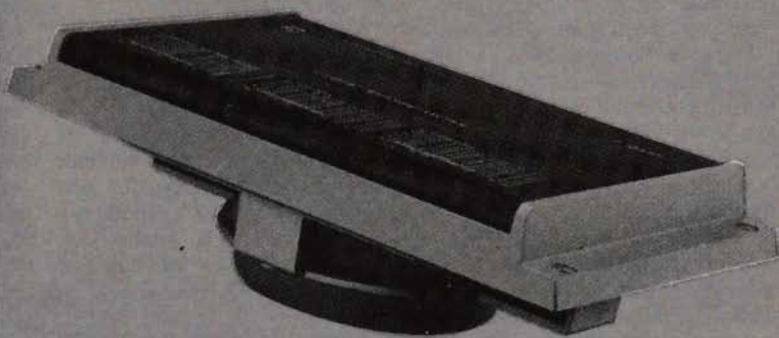
Fig 3. Basprocessorn i DRC-seriens högtalare. Den ger en förstärkning av upp till 8 dB i den undre tonregionen, enligt Philips. Frågan inställer sig om detta förrycker ursprungsbalansen i vissa fall.
