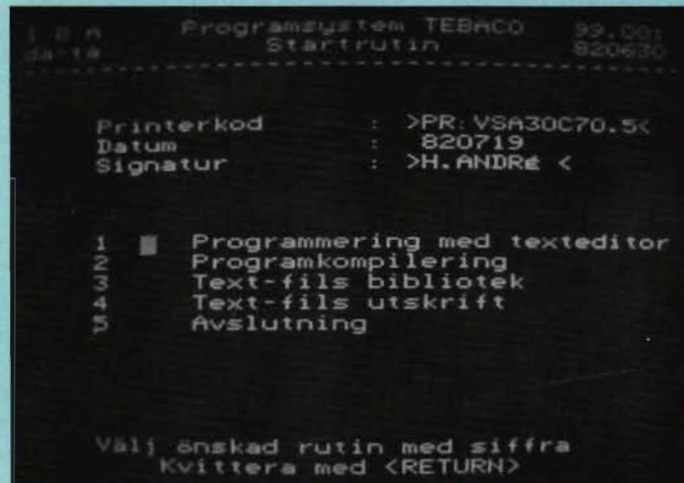
Fig 2. Bildskärmens utseende under startsekvensen efter det att man har angivit kod för skrivare, datum och signatur. Startrutinen står i läget för val av rutin. Till det läget återkommer alltid de olika programdelarna efter avslutad funktion.
