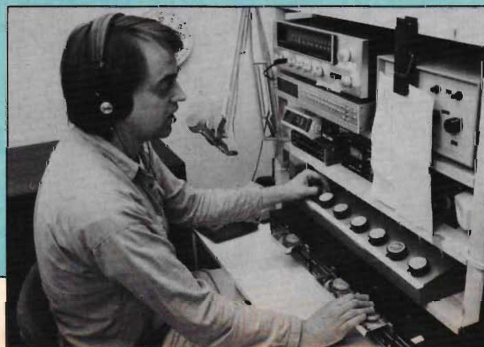
Lasse Lundeberg i SBC:s studio har endast 6 spotmaster bandspelare och en hembyggd mixer med runda rattar. Inga vanliga band eller skivspelare förekommer i studion.
