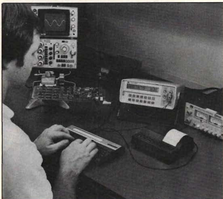
Fig 3. HP 75C har inbyggd anpassning för HPIL och kan därför direkt anslutas till instrument med nämnda buss, så som digitalmultimetern på bilden. Vi ser här också den lilla skrivaren till höger som matas över HPIL.
