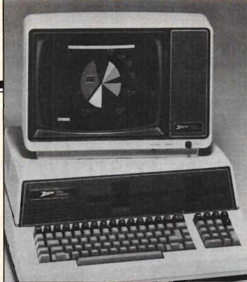
Fig 1. Zeniths nya Z-110, som arbetar med 8 resp 16 bitar alternativt. Den har färggrafik och 128 kbyte internminne.
