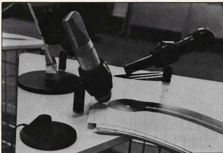
Milab i Åstorp, f d Pearl, presenterade sitt sortiment av högkvalitativa mikrofoner. Här ses i bakgrunden t h den trafolösa kondensatormikrofonen LC-25 som ger linjenivå ut. I mitten den välkända DC 63 som är en kondensatormik med hela 44 kombinationsmöjligheter för upptagningskänsligheten. Omkopplingen sker elektriskt med en ring-switch, som är baserad på tungelement och magneter. Längst fram Milabs svar på de USA-gjorda PZM: Det rör sig alltså om en tryckzonsmikrofon av elektrettyp. Den kan placeras på talarstol, golv eller på en vägg - möjligheterna är många. Mikrofonen ger en hemisfärisk upptagningskaraktäristik.
