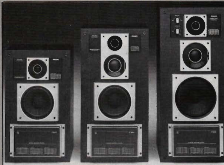
Fig 1. Uppenbart lämnar den japanska designen och finishen de europeiska högtalartillverkarna ingen ro: Här är Philips svar på diverse utmaningar (jämför brittiska Wharfedale). Mycket maffiga pjäser med påtagligt "teknisk" framtoning men också med något innanför höljet – högtalarna har baserats på krav på renare ljud än hittills främst i basområdet. Alla högtalarna är utförda som slutna lådor.
