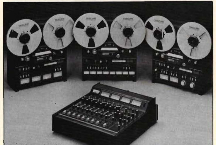
Ur Teac/Tascams 30-serie ses fr v modell 34 för fyra kanaler, i mitten modell 38 för åtta kanaler på halvtumstape och t h står modell 32, som är en normal stereomaskin. I förgrunden ses den lilla mixern M-30.
