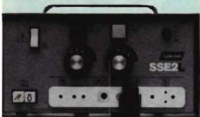
Fig 2. Valleylabs senaste elektro-kirurgiska utrustning. Utformningen är tilltalande och kontaktdonen har utvecklats med tanke på att det skall vara omöjligt att göra felkopplingar.
