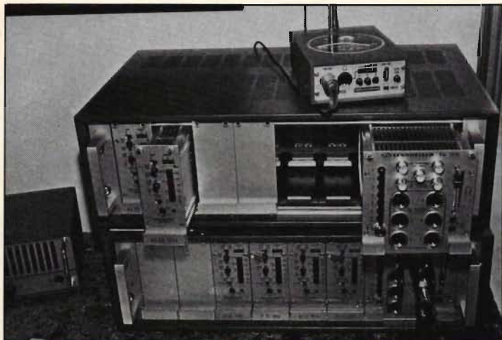
Tyska Sennheisers system för trådlösa mikrofoner omfattar ett antal mottagaralternativ, av vilka det enklaste är EM 1003 och det mest utbyggda är EM 1026. Trådlös överföring är en relativt dyr sak som dock medger hög flexibilitet och många fördelar vid i ex scenframträdanden.
