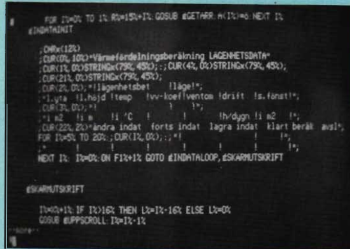
Fig 3. Bilden visar en del av ett textbaserat program då vi använder editor och 80 teckens tillsats. För överskådligare utseende använder vi extra linfeed och textindragning. På liknande sätt sker utskrift av programtexten av textformateringsrutinen.
