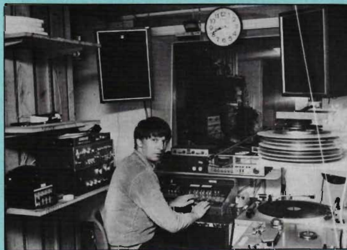
Studio 88 är privatägd och hyrs ut till 16 föreningar. Utrustningen består av begagnad materiel från Sveriges Radio (Lyrec och Telefunken M5) och en hembyggd mixer med 13 kanaler.
