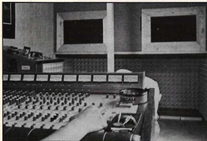
Innanmätet i Morec-mobilstudio är kompakt och interiören väl dämpad. Kontrollrumsdelen är uppbyggd som en bur, vilken "flyter" på gummiunderlag fritt från bilchassiet. Mixern är en Teac/Tascam M 16 och bandspelare är en 85-16 B från samma leverantör för 16 kanaler.
