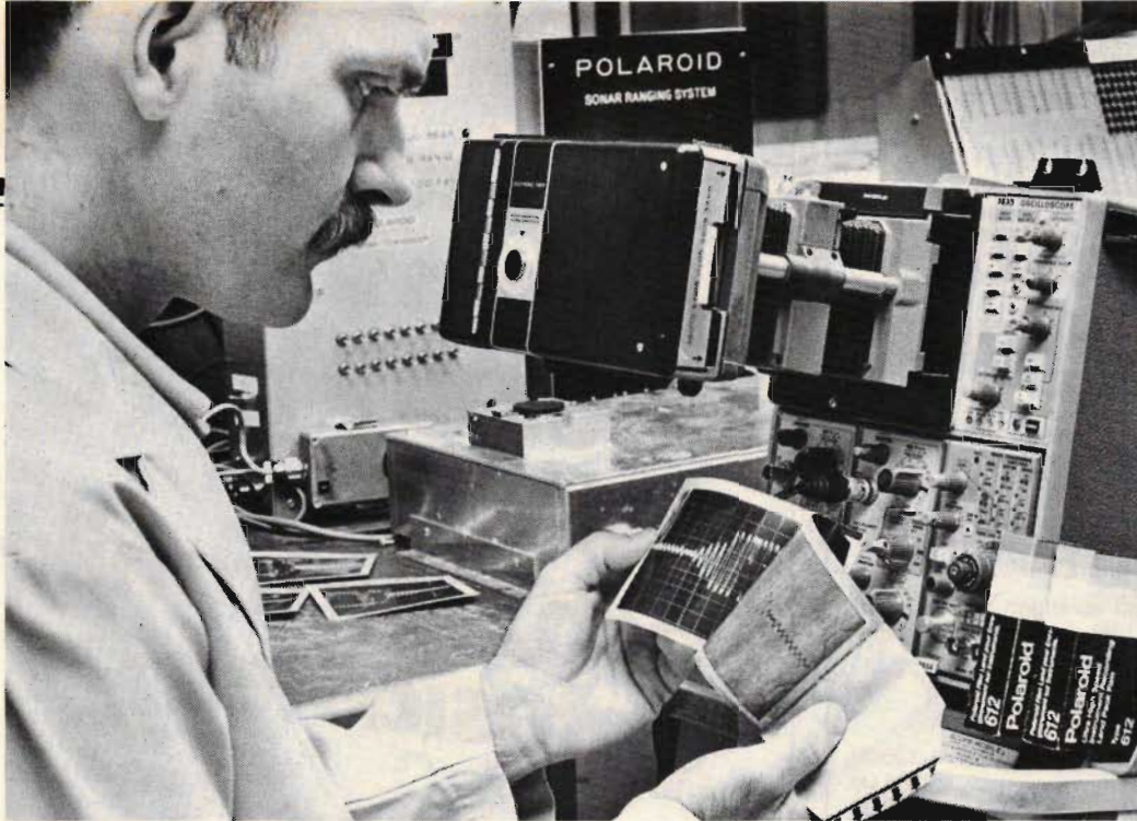
Foto från katodstrålerör i oscilloskop är en typisk labbapplikation för direktbildanvändning och Polaroids nya typ 612-film har med sin rekordhög känslighet om 20 000 ASA/ISO möjlighet att
