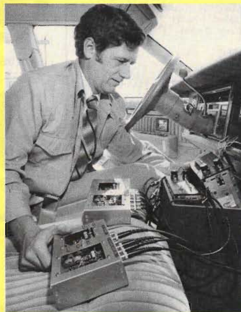
Den inte helt missbelätne mannen i framsätet är Keith Schultz , Delcos projektchef, som här har pluggat in både sig och lite mät- och testinstrumentering i samband med fältproven man gör för att värdera stereosändningarna från am-stationen WIRE i Indianapolis. Receivern är Delcos egen GM 2000 och bilen är en Cadillac Seville 82:a . Se texten för fakta om försöken.
