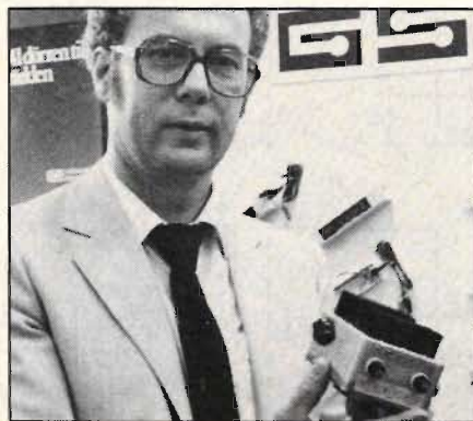
Fig 2. Ett switchat spänningsaggregat för bussar, lastbilar etc med 24 V batterispänning. Ut kan man få 12 V reglerad spänning med upp till 120 W belastning. Tack vare switchtekniken är förlasteffekten låg liksom den avgivna värmen. Spänningsaggregatet säljs av Quito HB och demonstreras av firmans innehavare, Dag Zetterquist.
