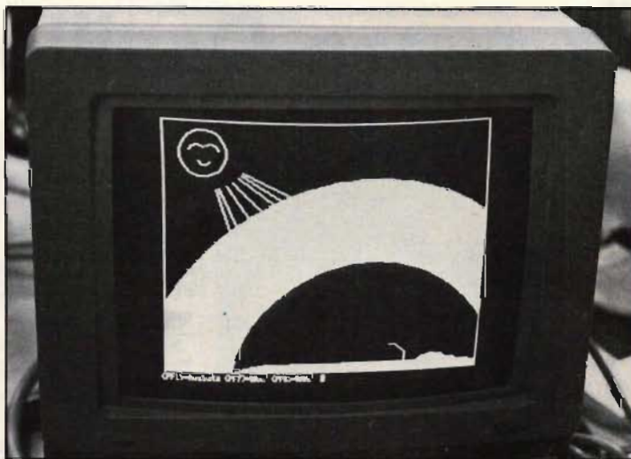
Fig 3. Luxor 812 är en ny högupplösande färgskärm till ABC 80. Skärmen tillåter presentation av 80 tecken per rad.
