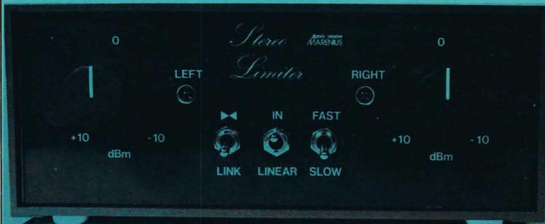
Fig 1. Limitern byggs i en liten låda och har reglage för begränsningsnivå för varje kanal samt omkopplare för sammankoppling kanalerna, tidkonstant på återgången och en förbikoppling.
