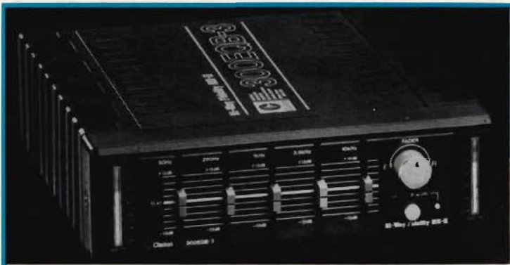
Boostern 300 EQB3 Hi Way Fidelity Mk II (puh!) från Clarion ger 80 W ut, 2 x 40, och har en 5-bands fk-variator, lysdiodindikeringar för uteffekten, fram/bakledsreglering, förbikopplare, hög- resp lågnivågång, en ny effektivare kylkropp och bättre installationsanpassning, fick vår utsände veta i Las Vegas.
