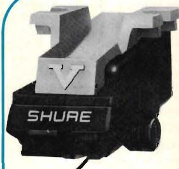
Fig 1. Shures nya V 15 typ V debuterar nu. En intressant detalj bland många är att höljet har formats genom en inneslutande formpressteknik som håller alla delarna i inkrämet på plats. Huvudsyftet är att uppnå ett maximum av motståndskraft mot alla resonanser som kan färga eller distordera signalen och inverka på stereoljudbilden. Man når hög likformighet vid tillverkningen och mycket jämna produkttegenskaper, inte minst därför att risken för avbrott och kortslutningar internt i kretsarna inuti avtar betydligt.
