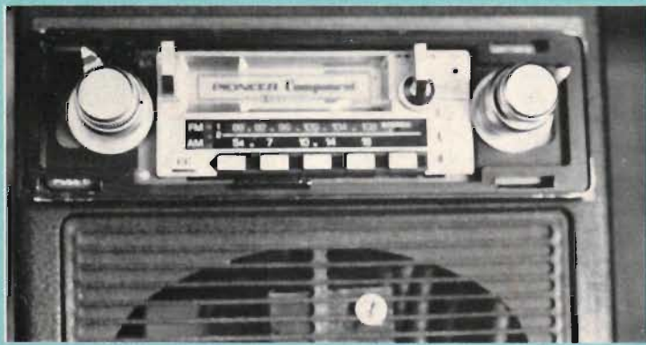
Bilradion fästs genom potentiometeraxlarna i bottenstycket till Audio Safe.
