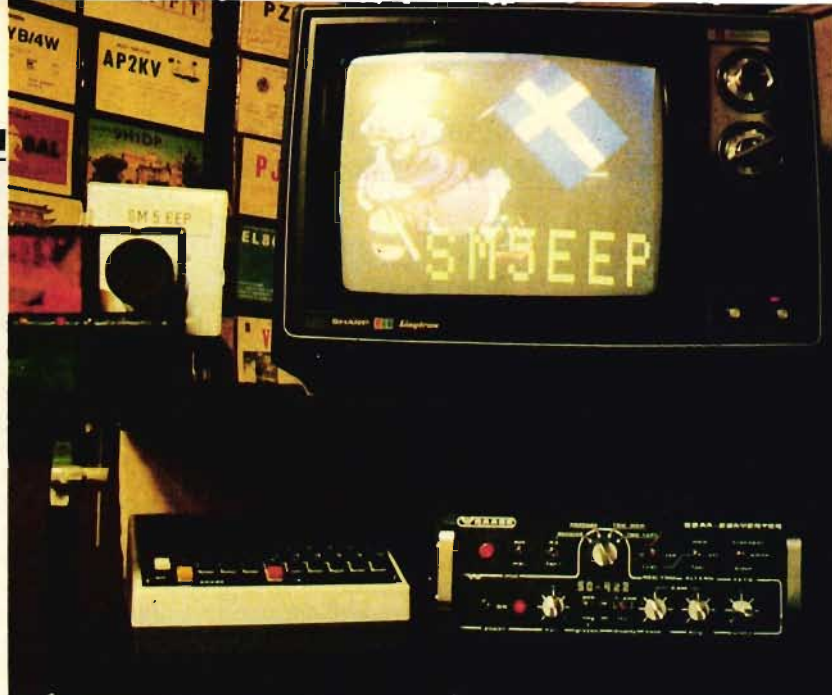
Fig 3. Th Här ser vi utrustningen som behövs för färg-sstv: Konvertern SC 422A med tangentbord, tv-mottagare och överst till vänster, sv-kameran med de tre filtren. Som kortvägsstation används en Trio TS 720.
