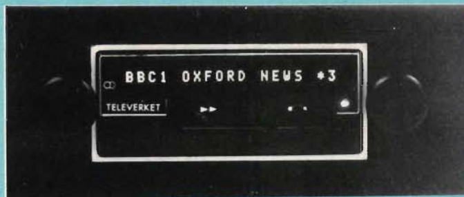
Framtidens bilradio blir trafiksäkrare. Redan nu finns experimentmodeller som visar hur lyssnaren kan få reda på vilka program, vilken sändare och programtyp som är inställda.
