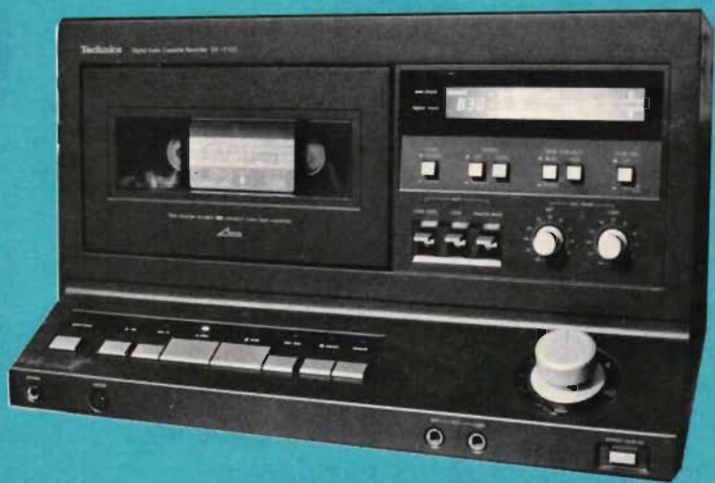
Digitalbandspelaren SV P100 från Technics är en av de första i sitt slag. Den arbetar med vanliga videokassetter men spelar bara in ljud. Det ljudet slår emellertid ut allt vad analogt bandljud heter till en kostnad av ca 25 000 för maskinen.
