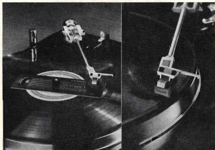
Fig 9. Shure har framställt två anordningar för inmontering, justering och orientering av pick upen: Duo-Point Alignment Gauge, se vänstra bilden, och Leveling Alignment Stylus, där man bl a höjdiställer pick upen; se
