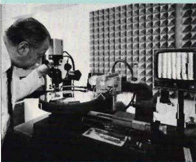
◀ Fig 3. Neumann var först med att för några år sedan introducera en tv-monitor kopplad till det mikroskop som alltid finns på gravverket och genom att spår-fördelningen och modulationsgraden nu stort och tydligt framträder på s/v-monitorn vinner man inte bara säkerhet vid be-
