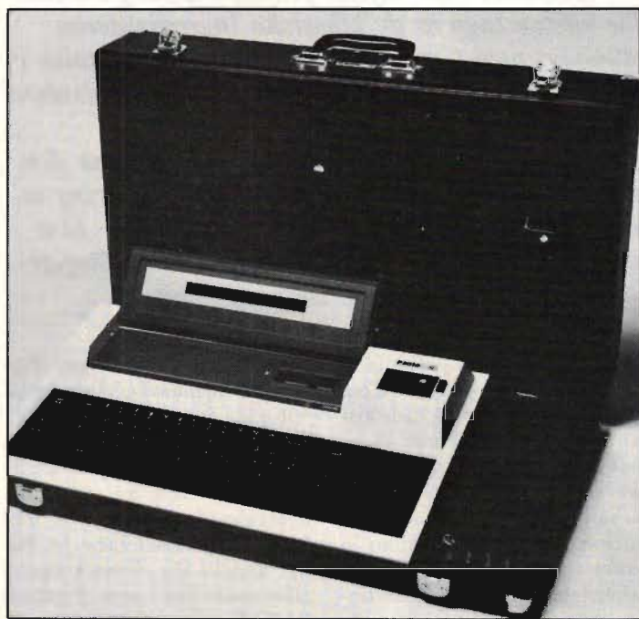
Fig 1. Philips P5010 väger bara 6,2 kg men har trots det ett riktigt tangentbord. Lagg märke till den uppfällbara indikatorpanelen. Till höger om den finns bandminnet där texten lagras. Utskrift och redigering sker på ett större ordbehandlingssystem.
