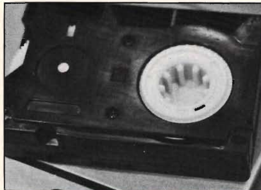
Så här ser VHS-C ut från undersidan. Spolen till vänster drivs med kugghjulet längst ut till vänster.
