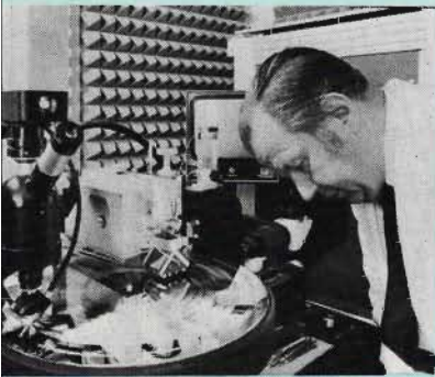
Fig 2. Under graveringens lopp kikar operatören då och då in i sitt okular för att kontrollera att de bortskurna strimlorna, "spånet", också sugts ut kontinuerligt efter eggen. Att så inte sker är en av de vanligaste orsakerna till att lack måste kasseras under processen med gravering. I bakgrunden skymtar tv-monitorn till graververket.
