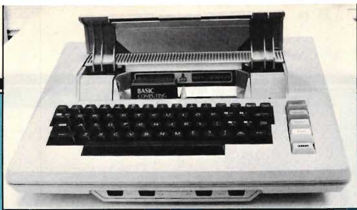
Fig 1. Atari-datorerna har fack för ROM-kassetter. I Atari 800, på bilden, finns två fack, i Atari 400 finns ett.
