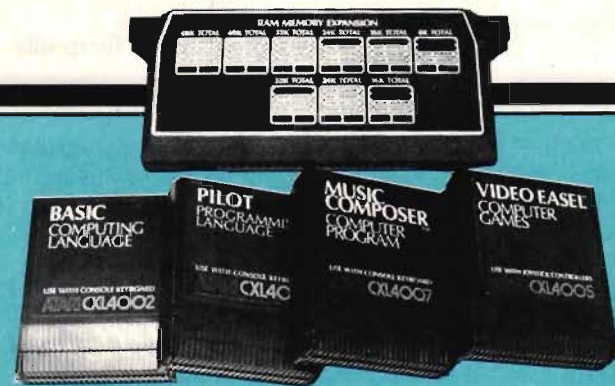
Fig 3. Så här ser programkassetterna ut (i förgrunden) och bakom dem en minneskassett.
