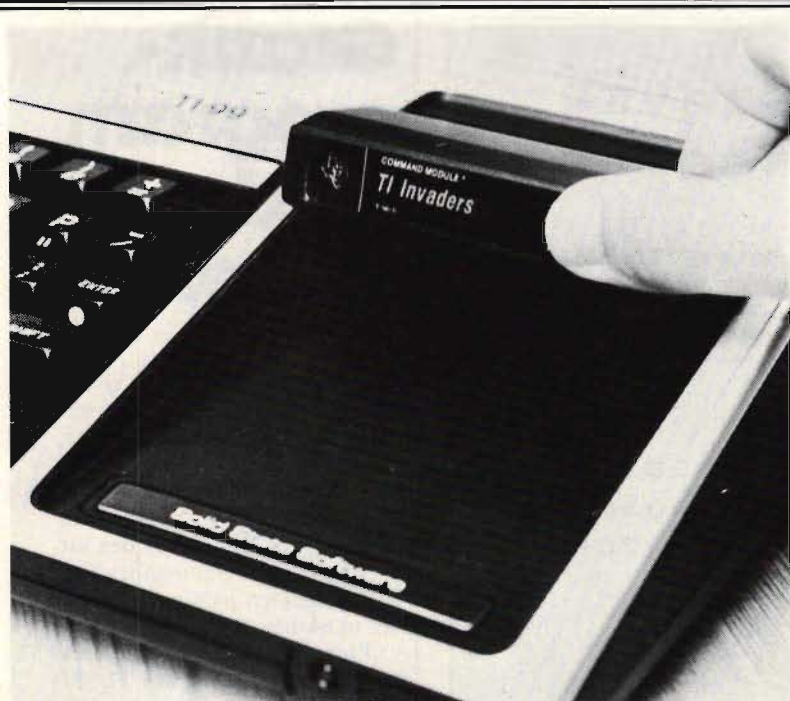
▲ Moduler med program i ROM eller EPROM kan sättas in i en särskild ficka på datorn. Här är det fråga om en rymdkrigsvariant.
