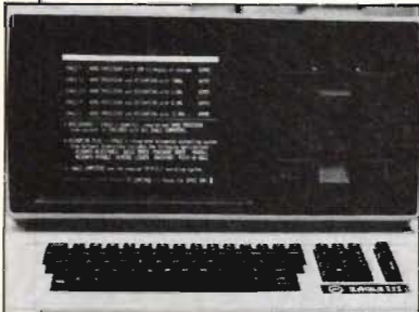
Fig 4. Eagle IV heter den här datorn som i sig har såväl 5 1/4" flexskivminne som ett skivminne med 7,5 kbytes kapacitet. Eagle Computer Inc ligger i Cambell, Kalifornien.
