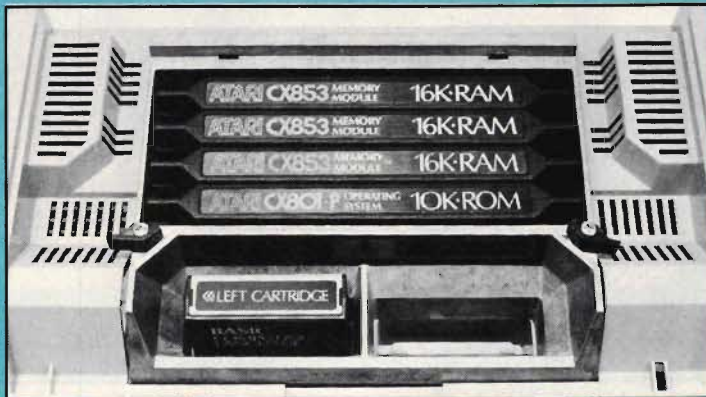
Fig 1. Atari-datorerna har fack för ROM-kassetter. I Atari 800, på bilden, finns två fack, i Atari 400 finns ett.
