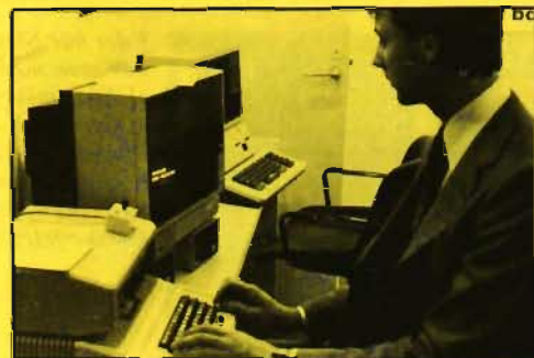
Fig 2. Ovanpå Apple II-datorn längst till vänster ligger en datainsamlingsutrustning som säljs av Globe Computer. Systemet ger 70 nya basiskommandon förutom de som finns i datorn.
