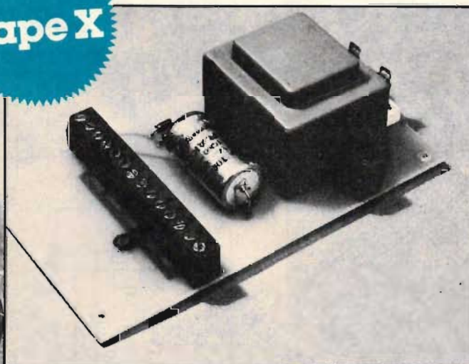
Nätdelen byggs upp på ett kort som också tjänar som kopplingsplint för anslutningskabeln.
