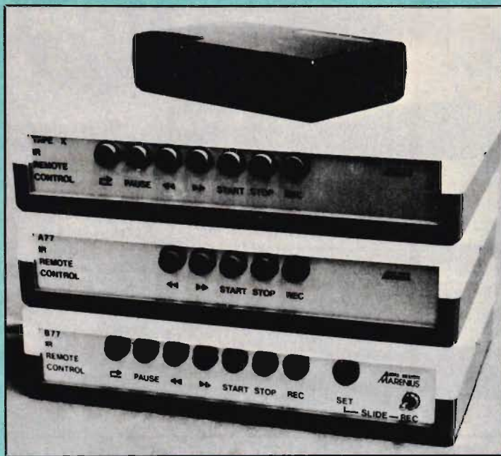
Fjärrkontrollen i tre utföranden medger fyra trådlöst styrda funktioner. Från mottagarlådan kan man styra så många funktioner som bandspelaren tillåter.
