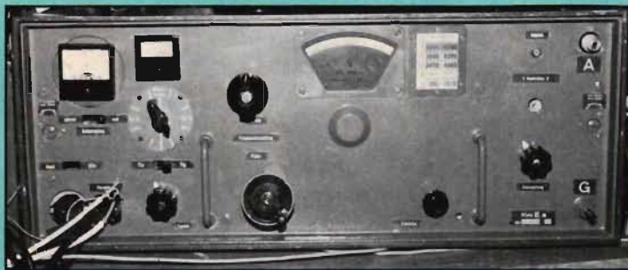
Fig 2. Kurzwellenempfänger A, förkortat Kw.E.A. Den här en halv meter breda och 45 kg tunga mottagaren täcker 980–10 000 kHz. Avstämningen sker med en 6-gangs vridkondensator. Mf-delen har lc-kretsar avstämnda till frekvensen 250,9 kHz. Kopplingsgraden kan varieras, vilket påverkar mf-bandbredden. Beatoscillatorn är kristallstyrd med frekvenserna 250 eller 251,8 kHz. Den förra kristallen används även som kalibreringskristall. Rören, RV2P800, har 2V glödspänning. Mottagaren finns i en version för långvåg, Lw.E.A.
