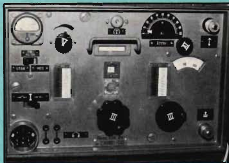
Fig 4. Mottagaren Torn E b. Den bars på ryggen av tyska soldater och den typen av hölje kallas "Tornister". Den gjordes åren 1935 - 45 och användes av de tyska signaltrupperna polis och trafikkontrollmyndigheter. Mottagaren är rak och har fyra rör av typen RV2P800. Den fanns i svenska försvaret under beteckningen M42.
