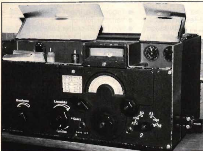
Fig 7. Om man faller upp locken, överst, kan man byta alla rör.
