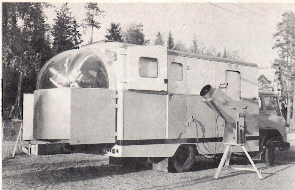
Fig 4. Mätvagn för optiska norrskenstudier och observationer i förbindelse med raketexperiment.
