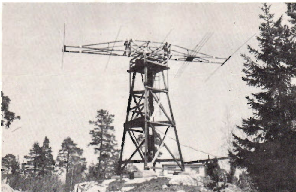
Fig 3. Backscatterantenn som används för mätning av skipzonen vid etthopps-förbindelser. Frekvens 16,5 MHz och förstärkning 10 dB.
