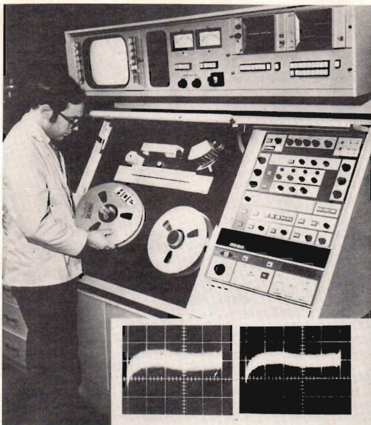
Fig B och C. Tv åskådliggöres 3M:s nya tvåtumstape: En tekniker laddar en TV-bandspelare med den tunga spolen. Infällt visas två oscilloskop-foton. Det tv ger brusnivån vid uppspelning av en sjätte generationens kopia på standardband, och th framgår den synbart minskade brusnivån vid uppspelning av en sjättegenerationens kopia på högenergitape. Fotot th visar laddning av TV-bandmaskin med ett nytt entumsband och undertill ger oscilloskopfotona tv utsignalalstringen i HF-spektrum för ett standardband jämfört th med det nästan fördubblade värdet — se amplituden — för ett högenergiband av det nya slaget.
