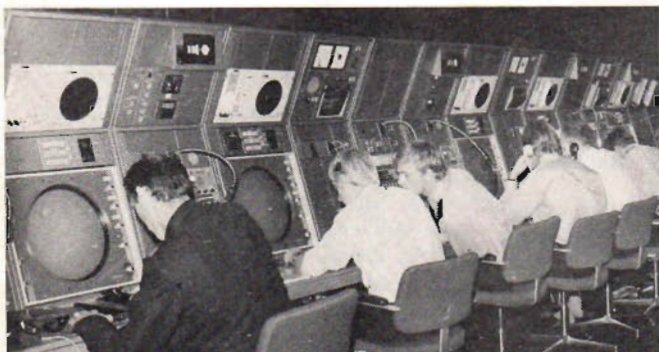
Fig 1. Kontrollcentralen. På bilden syns bl a PPI, telefon/interfon, pejl, tidbas och instrument för vindriktning och styrka.
