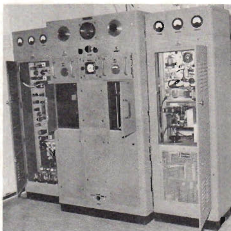
Fig 1. Automatisk jonosond för registrering av jonosfärens olika skikt. Frekvensområde 0,4—20 MHz, registrering alternativt en gång per minut, 15 min, 30 min eller 60 min. Pulseffekt 10—30 kW. Har varit i drift sedan 1956.
