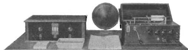
Apparatur för mottagning av bildradio. Beskrevs i PR nr 1/29.
