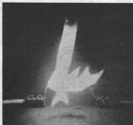
Fig. 4. Dessa bilder visar hur ett bakelitmotstånd beter sig vid kraftig överbelastning. Den undre bilden visar den kraftiga stickläga, som uppträder vid överbelastning.
