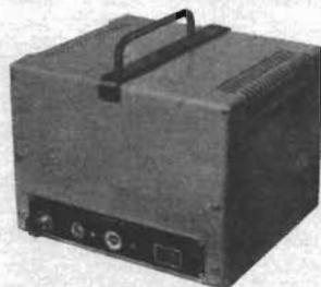
Fig. 2. Ultraljudgenerator (50 W) för lödpistolen i fig. 1.
