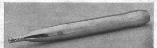
Fig. 7. Processen i apparaturen i fig. 4 ger en 140 mm lång germaniumkristall i form av en stav. Denna utnyttjas som utgångsmaterial för germaniumdioder och transistorer.
