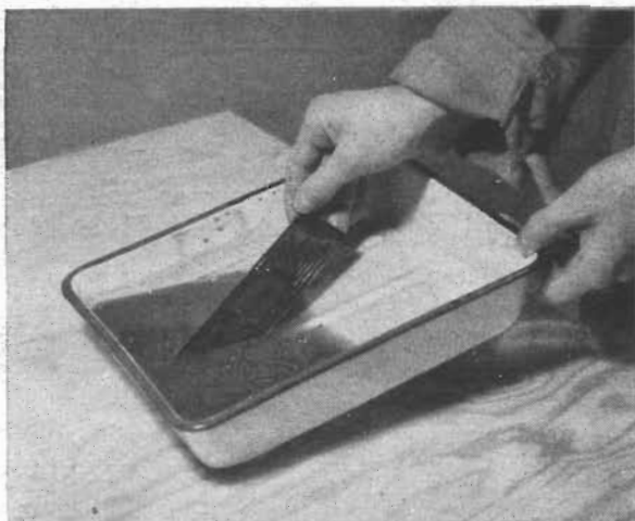
Fig. 4. Plattan med täckfärgen placeras i ett kemiskt bad, som upplöser de partier, som inte täcks av färgen.
