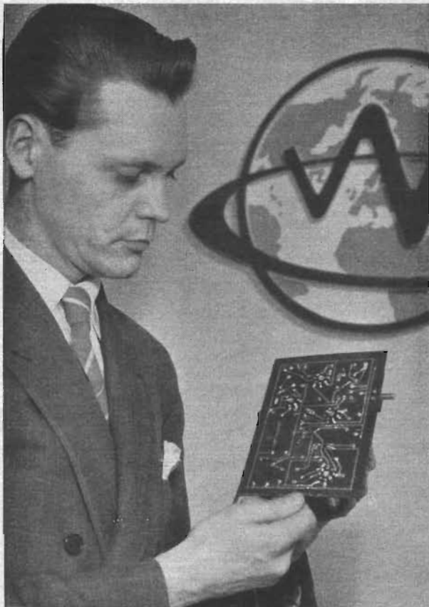
Fig. 6. Ingenjör M Stenhardt med en svensktillverkad komplett batterimottagare tillverkad med tryckta kretsar. Se även fig. 7.
