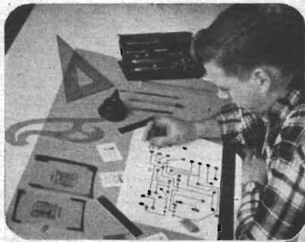
Fig. 1. »Kopplingschema» för tryckta kretsar ritas först noggrant upp i tusch.
